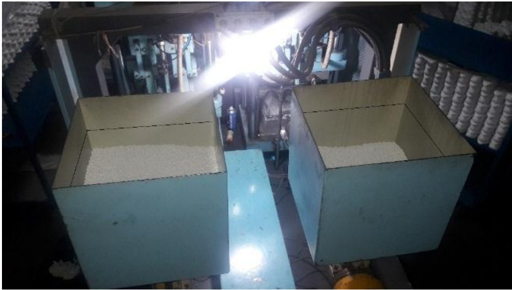
Señalización de tolva de la máquina de inyección de la suela de zapatos
