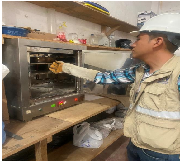
Fotografía N°06: Secado del agregado fino en horno.
