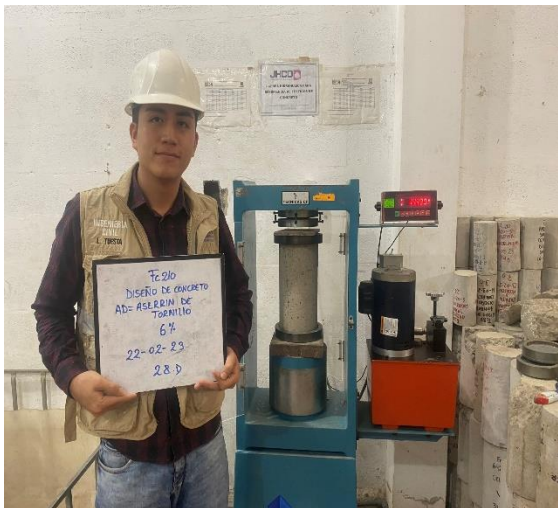
Fotografía N°32: Ensayo de Compresión de concreto con 6% de aserrín a los 28 días.
