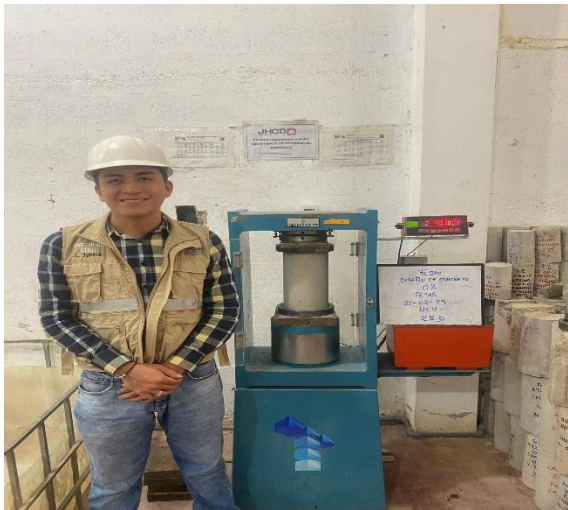
Fotografía N°30: Ensayo de Compresión de concreto patrón a los 28 días.
