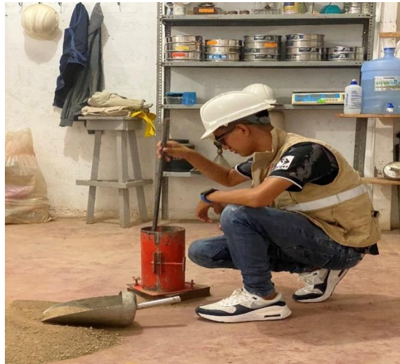
Fotografía N°11: Peso Unitario Varillado del agregado grueso.
