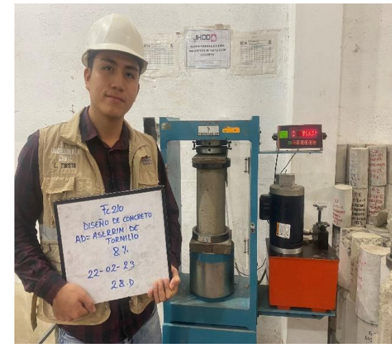
Fotografía N°33: Ensayo de Compresión de concreto con 8% de aserrín a los 28 días.
