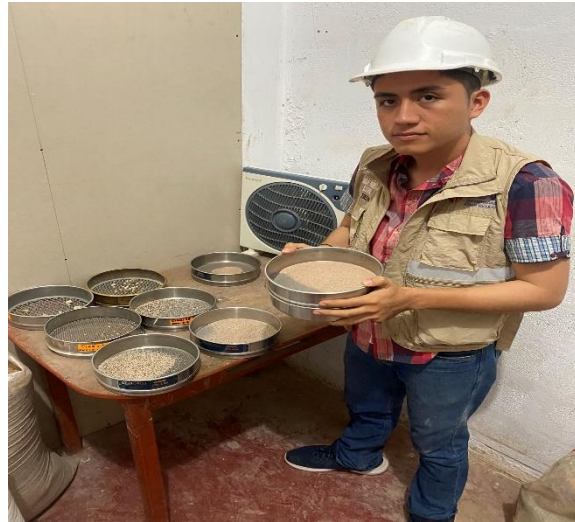
Fotografía N°13: Tamizado del agregado fino.
