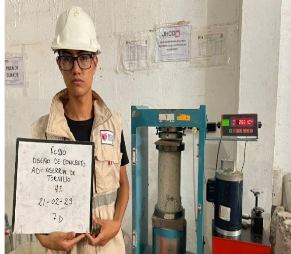
Fotografía N°25: Ensayo de Compresión de concreto con 4% de aserrín a los 7 días.
