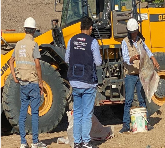
Fotografía N° 01: Muestreo de agregado fino
