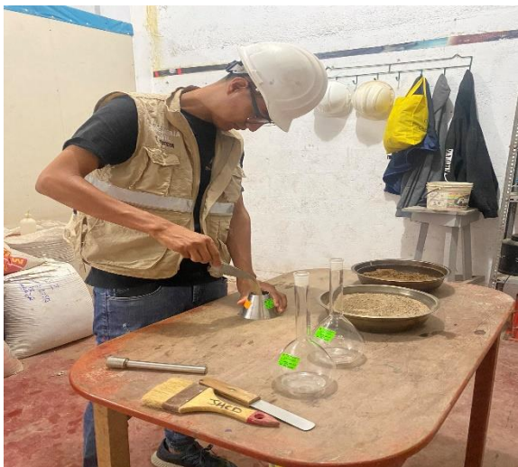
Fotografía N°14: Ensayo del Cono de absorción de arena.
