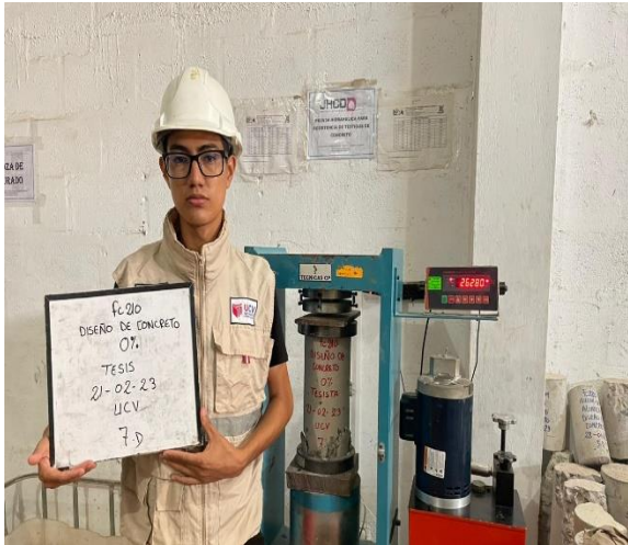
Fotografía N°24: Ensayo de Compresión de concreto patrón a los 7 días.
