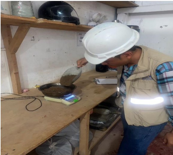
Fotografía N°05: Pesado del agregado fino saturado en aire.
