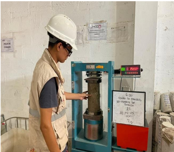
Fotografía N°25: Ensayo de Compresión de concreto con 8% de aserrín a los 7 días.
