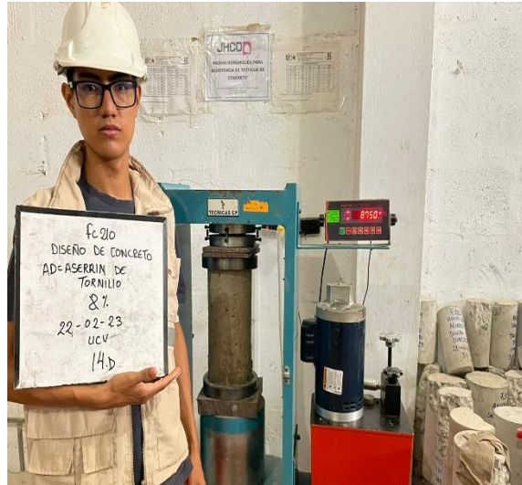
Fotografía N°29: Ensayo de Compresión de concreto con 8% de aserrín a los 14 días.
