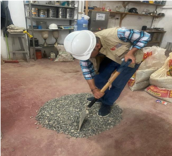
Fotografía N°06: Uniformización del agregado grueso.
