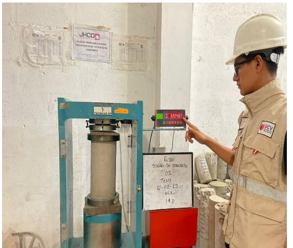
Fotografía N°26: Ensayo de Compresión de concreto patrón a los 14 días.
