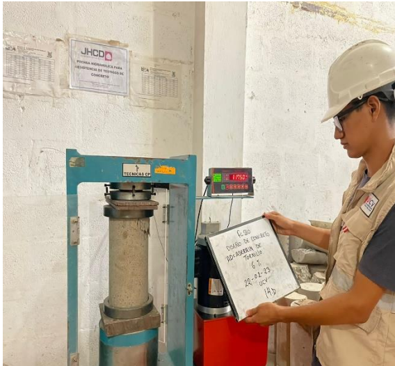
Fotografía N°28: Ensayo de Compresión de concreto con 6% de aserrín a los 14 días.
