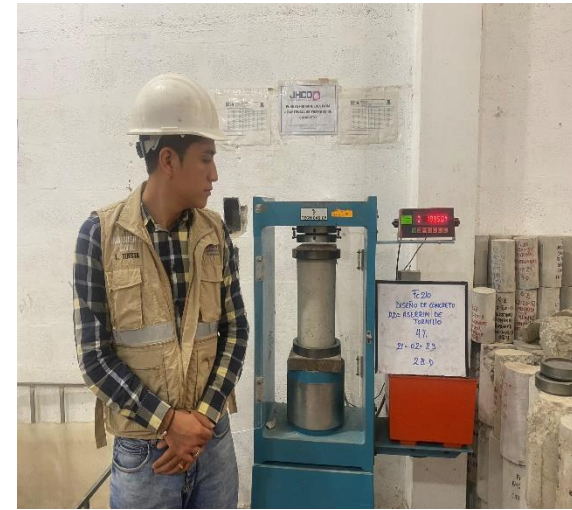
Fotografía N°31: Ensayo de Compresión de concreto con 4% de aserrín a los 28 días.
