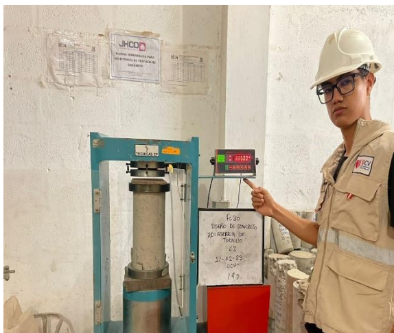
Fotografía N°27: Ensayo de Compresión de concreto con 4% de aserrín a los 14 días.
