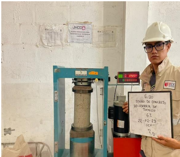
Fotografía N°24: Ensayo de Compresión de concreto con 6% de aserrín a los 7 días.
