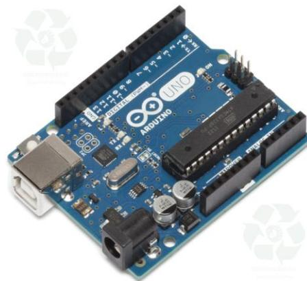
*Figura N° 67. Arduino UNO R3.*
