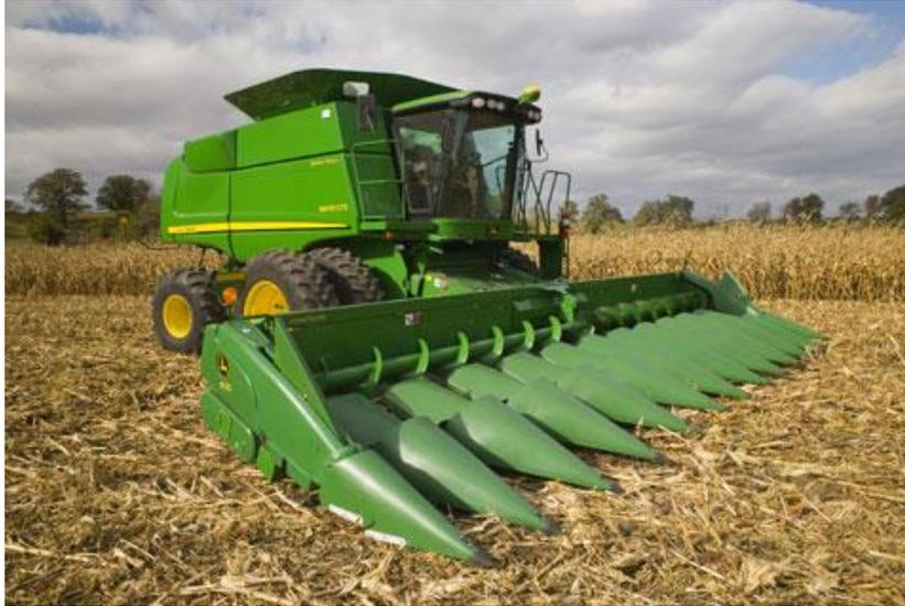
**Figura N° 20. Cosechadora de maíz autopropulsada.**
