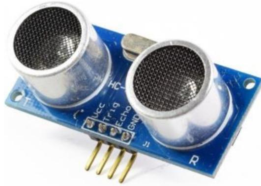
**Figura N° 64. Sensor ultrasónico HC-SR04.**
