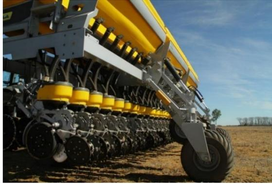
**Figura N° 28 Sembradoras de precisión.**
