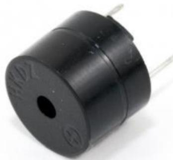
**Figura N° 65. Buzzer.**
