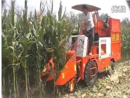
*Figura N° 19. Cosechadora de maíz de dos hileras.*
