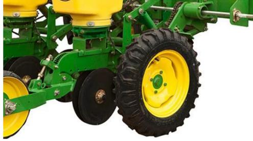
**Figura N° 05. Ruedas de máquina sembradora.**
