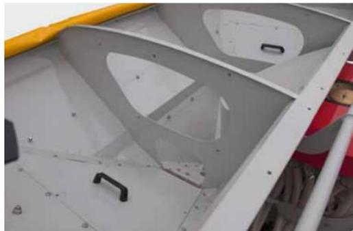
**Figura N° 06. Tolva de máquina sembradora.**
