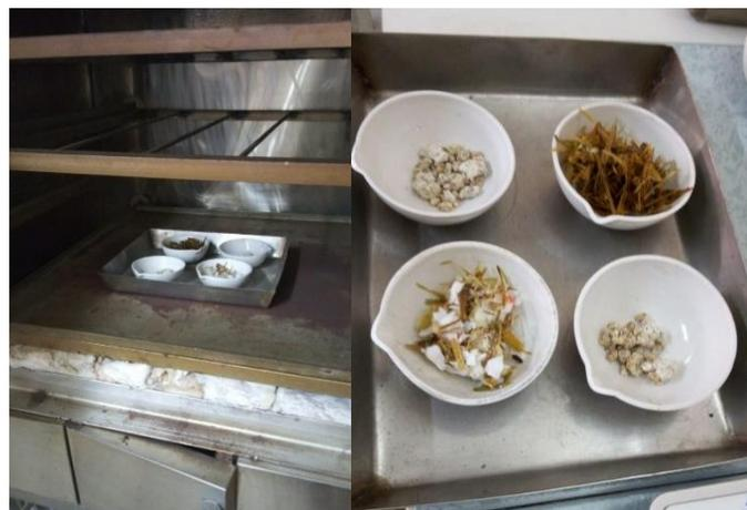
**Figura 8.** Secado del pañal usado y sustrato en la estufa.
