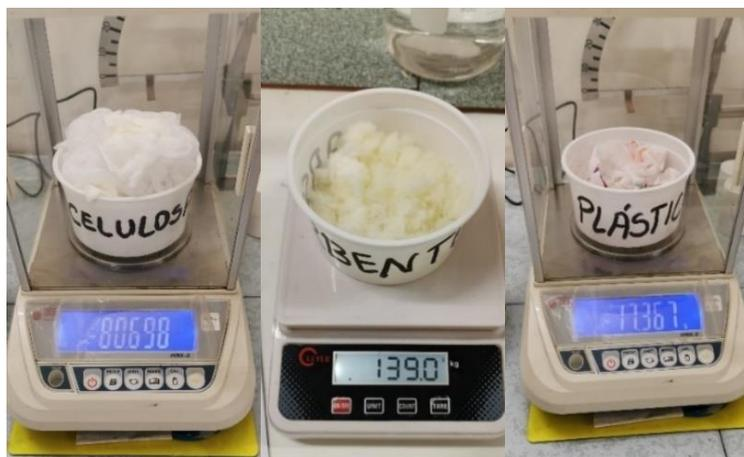
**Figura 7.** Pesado de los componentes del pañal usado
