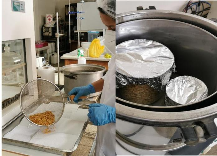
**Figura 31.** *Secado y esterilización de la cebada*
