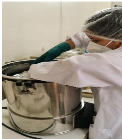
**Figura 22.** *Esterilización de la disolución*
