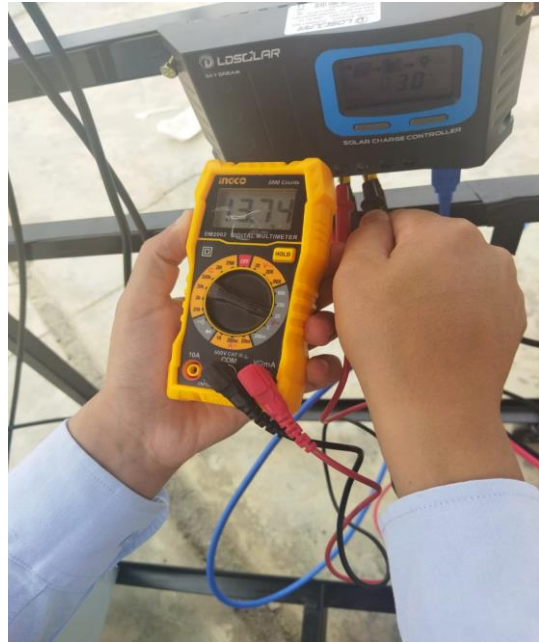
Medición del voltaje de los paneles fotovoltaicos en investigación
