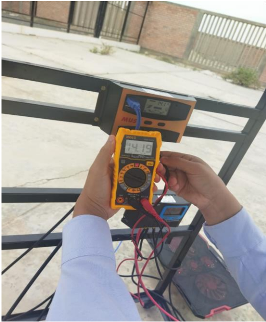
Medición del voltaje de los paneles fotovoltaicos en investigación
