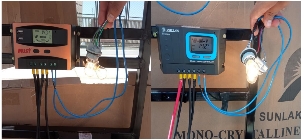
Conexión de cada controlador de carga con su respectiva carga de 02 focos conectados en paralelo, a la izquierda sistema con panel monocristalino, a la derecha sistema con panel policristalino.
