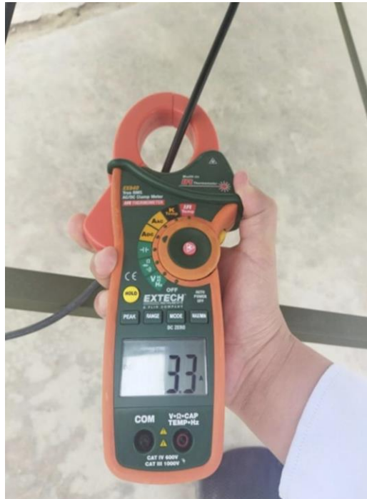
Medición de la corriente de los paneles fotovoltaicos en investigación
