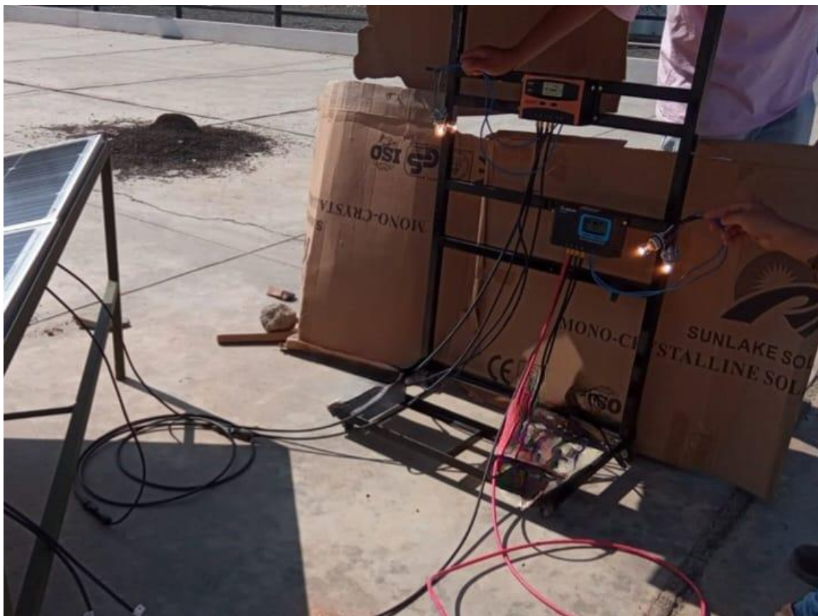
Sistemas con carga de 02 focos conectados en paralelo, a la izquierda sistema con panel monocristalino, a la derecha sistema con panel policristalino.
