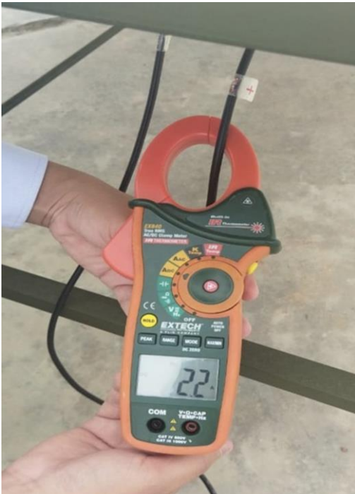
Medición de la corriente de los paneles fotovoltaicos en investigación
