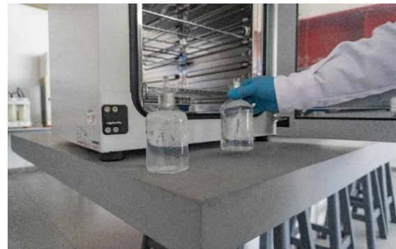
Introduciendo las muestras del agua al horno, para análisis DBO y DQO
