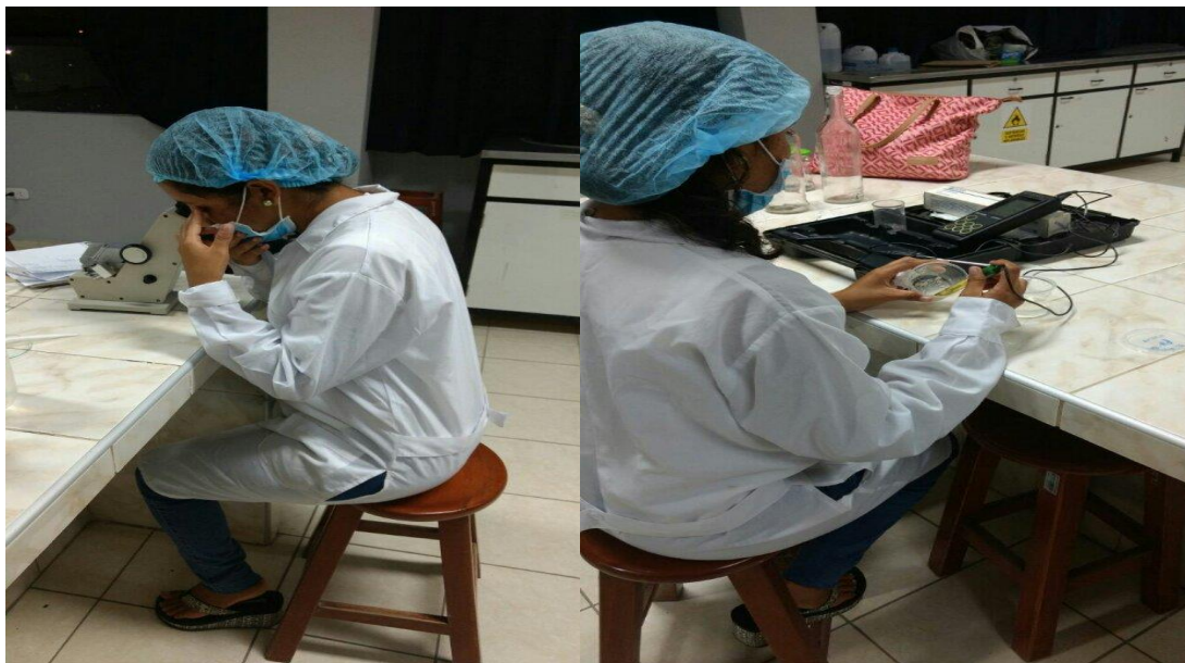
FIGURA N° 9 Medición de sólidos solubles °Brix por refratrometría Y pH del vinagre de banano orgánico.
