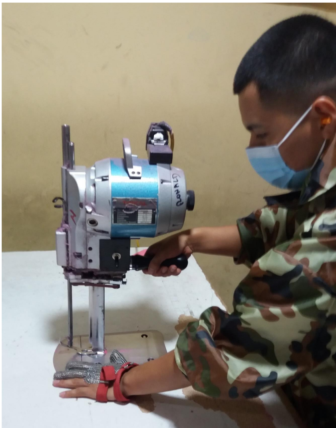
Figura 13. Implementación de uso de EPP en área de corte
