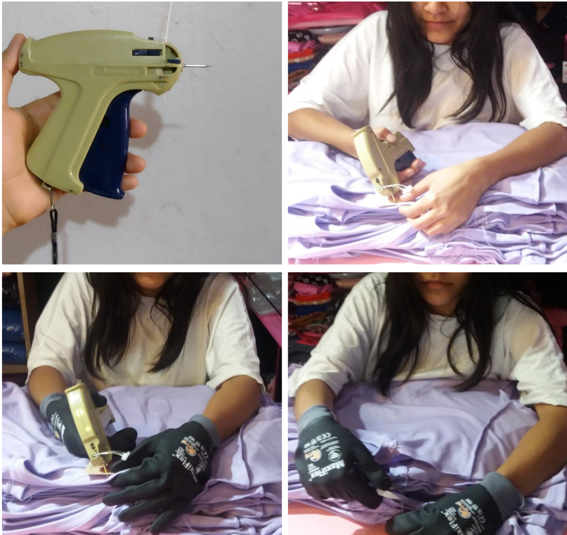
Figura 19. Identificación de peligros y uso de EPP en área de acabados.
