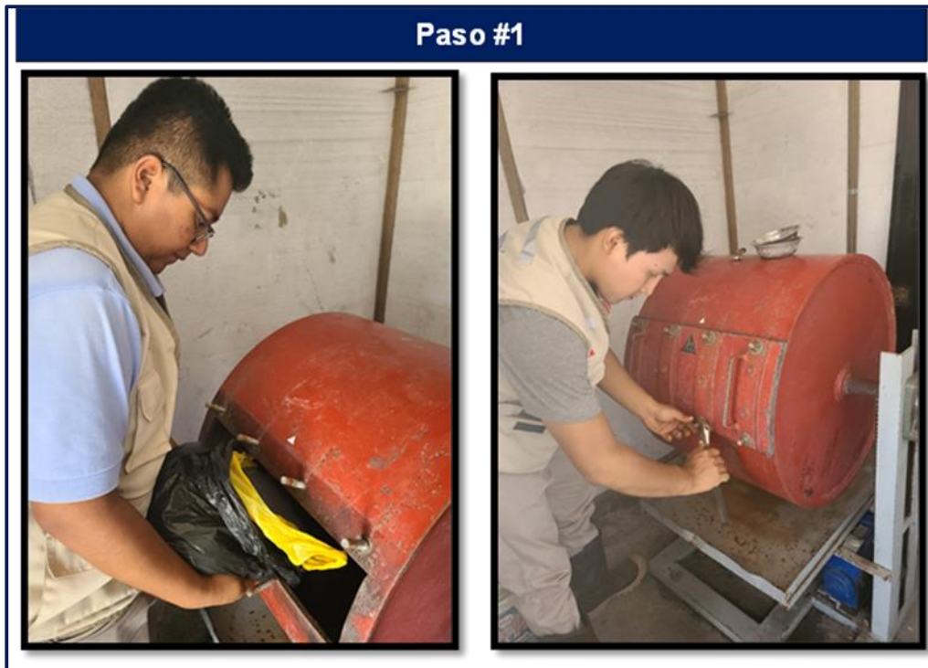
Colocación de las cenizas al molino de bolas.
