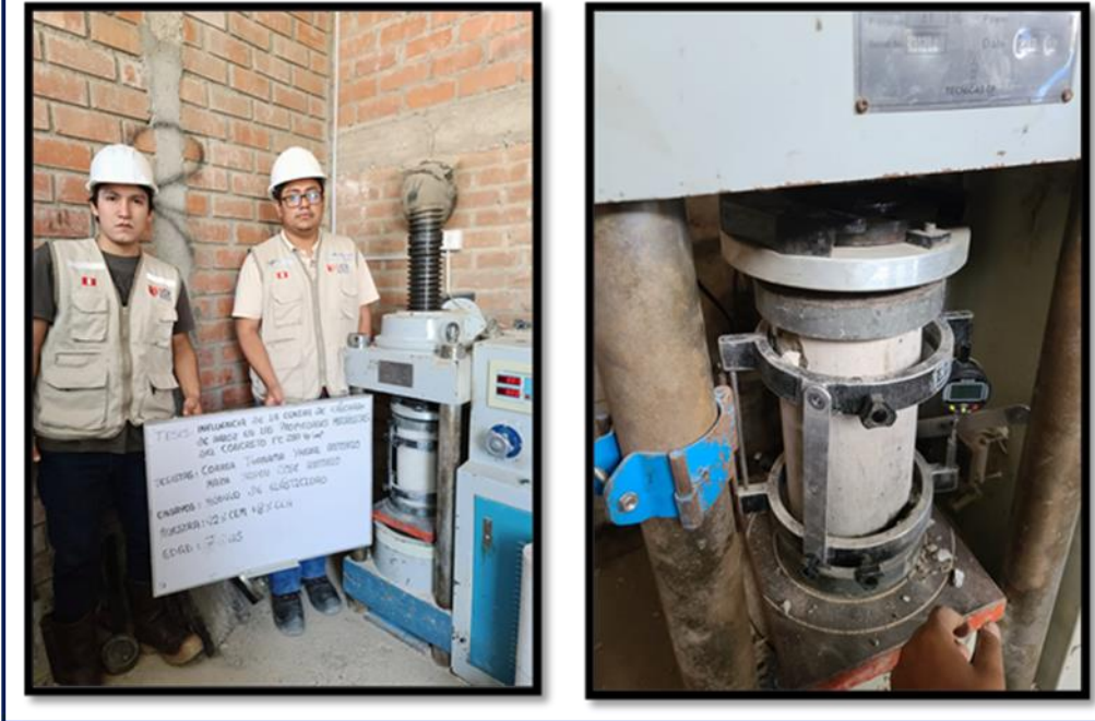
Rotura de probetas cilíndricas a los 7,14 y 28 días de curado – módulo elástico
