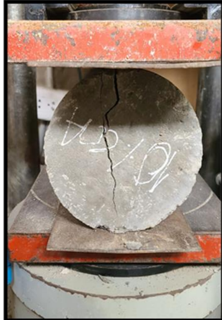
Rotura de probetas cilíndricas a los 7,14 y 28 días de curado – resistencia a la tracción.
