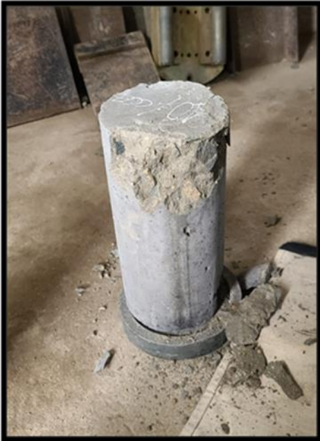
Rotura de probetas cilíndricas a los 7,14 y 28 días de curado – resistencia a la compresión.
