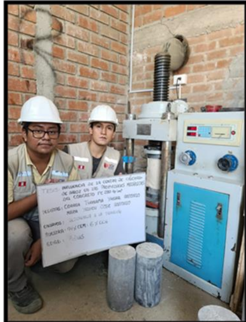
Rotura de probetas cilíndricas a los 7,14 y 28 días de curado – resistencia a la compresión.
