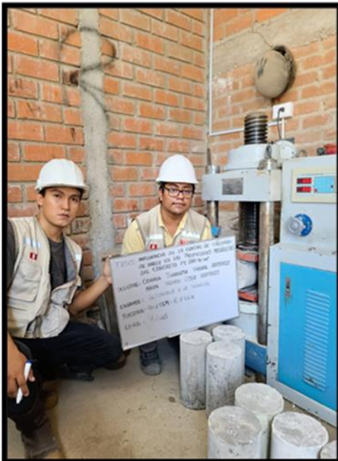
Rotura de probetas cilíndricas a los 7,14 y 28 días de curado – resistencia a la tracción.
