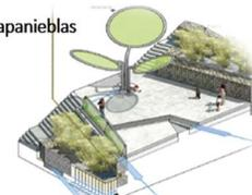
El agua recolectada por los atrapanieblas de camino se almacena en el tanque ,este tanque alimenta un sistema de riego por goteo .el mototaxi como basurero
