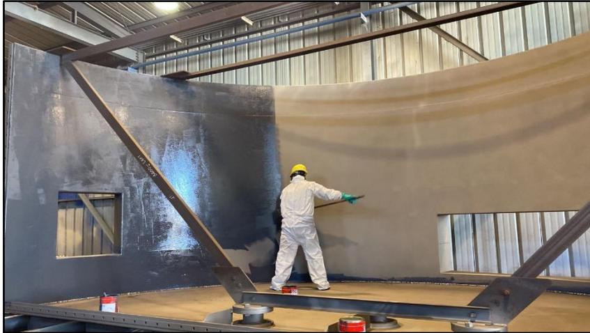
*Figura 7.* Aplicación de adhesivo
