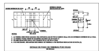
DETALLE DE PASO DE TUBERÍAS POR VIGAS EN BICHA
