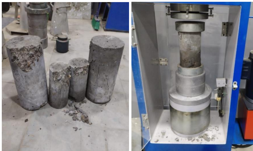
Figura 14. Rotura de Probetas a Compresión.
