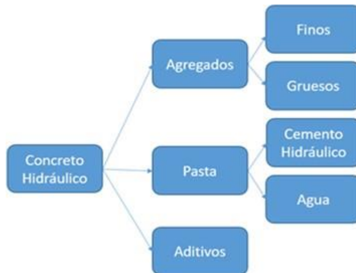
Figura 2. Diagrama de componentes del concreto hidráulico
