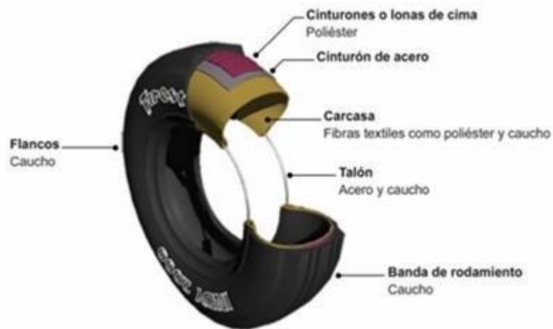
Figura 1. Partes Principales de un Neumático.
