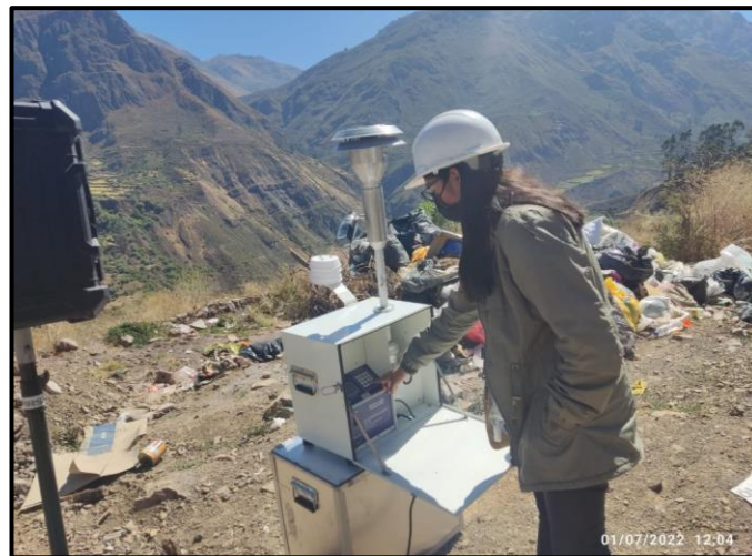
Foto 13. Encendido del muestreador de partículas.
