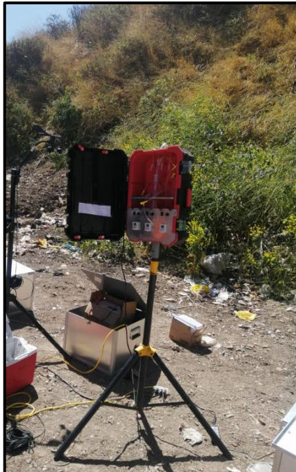
Foto 11. Estación de monitoreo de Calidad de Aire en Sotavento (tren de muestreo).
