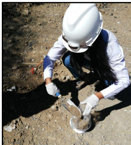
Foto 17 y 18. Extracción de la toma de muestra del suelo.
