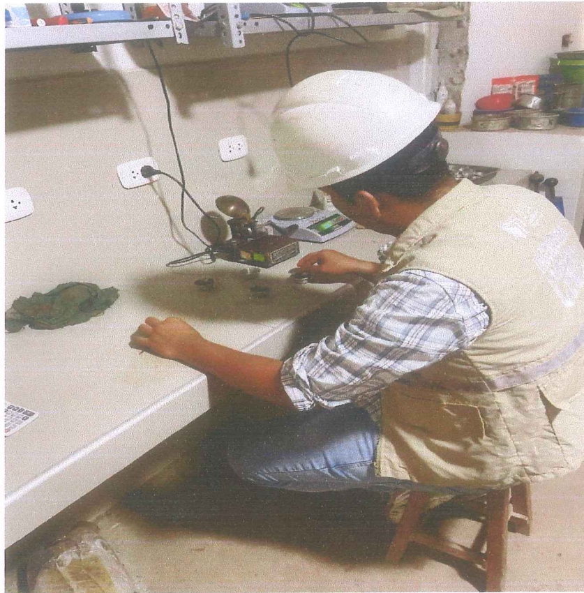
.Método de Ensayo para Determinar Limite Plástico (NTP 339.129.1999)
