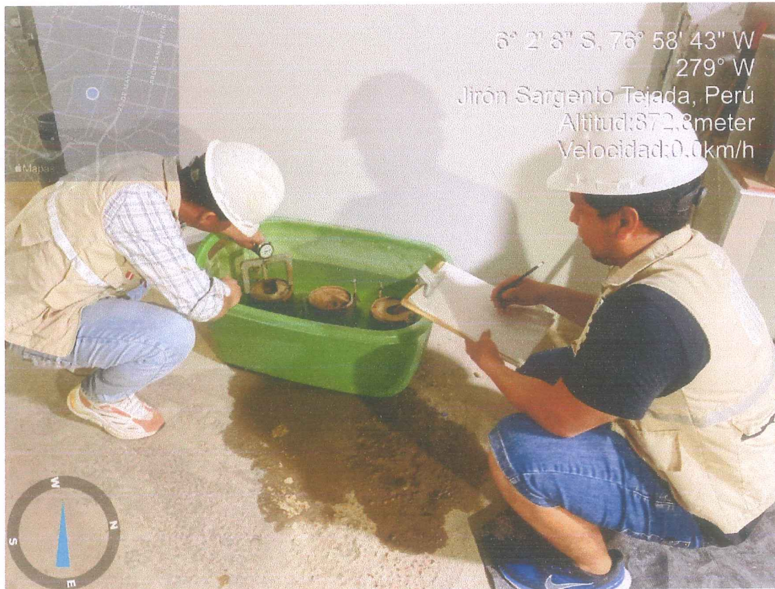
Ensayo normalizado de penetración CBR, según norma ASTM D-6951-03 Verificación de expansión del suelo.
