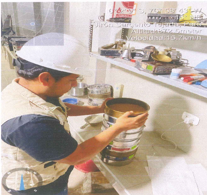
Análisis granulométrico del agregado fino, grueso y global NTP 400.012 - AGREGADOS. tamizado mecánico por la serie de tamices, fracción fina.
