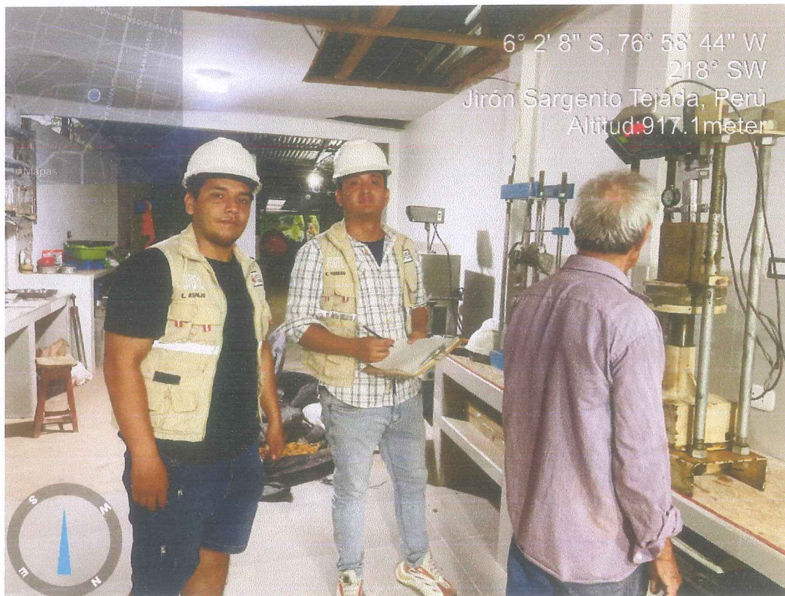
Ensayo normalizado de penetración CBR, según norma ASTM D-6951-03, Proceso de penetración de muestras compactadas a 10, 25 y 56 golpes.
