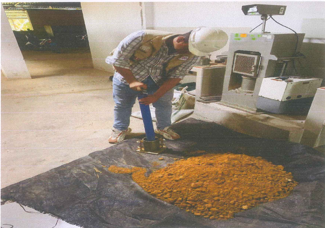
Ensayo normalizado de compactación Proctor estándar, según norma ASTM D-698.
