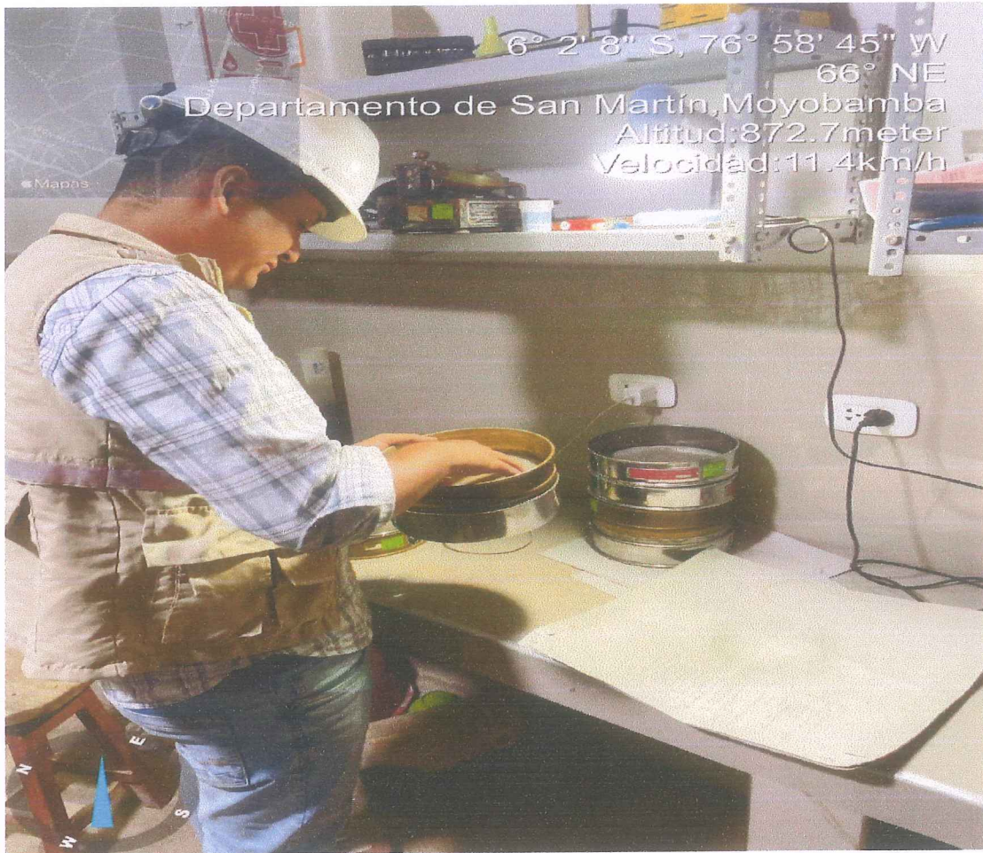
Análisis granulométrico del agregado fino, grueso y global NTP 400.012 - AGREGADOS. tamizado mecánico por la serie de tamices, fracción fina.
