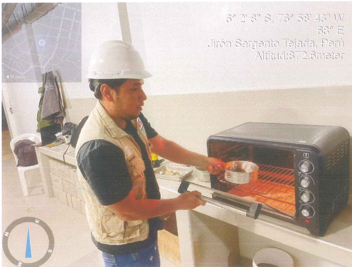
Proceso de secado en horno de humedad natural, humedad constante a 110° C, humedad constante - Ensayo de Contenido de Humedad NTP 339.127.
