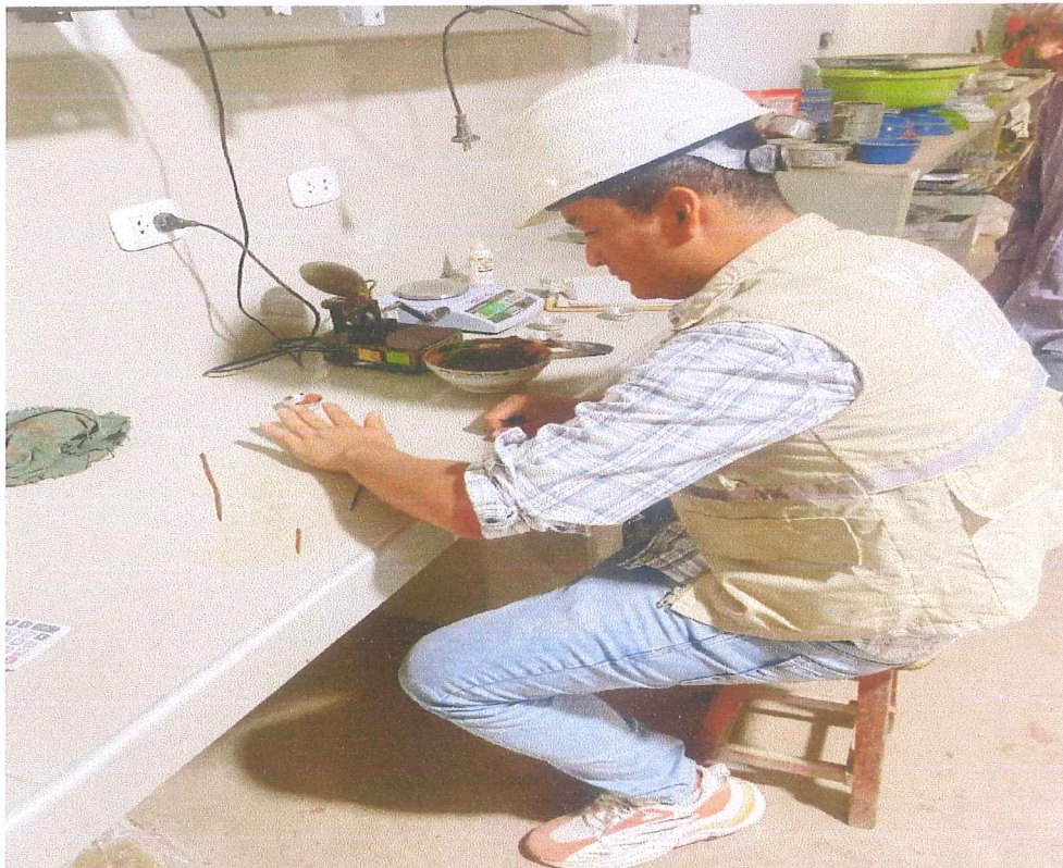
.Método de Ensayo para Determinar Limite Plástico (NTP 339.129.1999)
