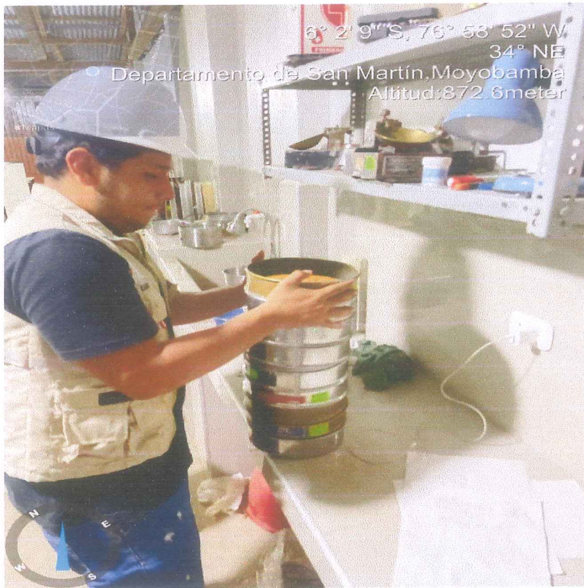
Análisis granulométrico del agregado fino, grueso y global NTP 400.012 - AGREGADOS. tamizado mecánico por la serie de tamices, fracción fina.
