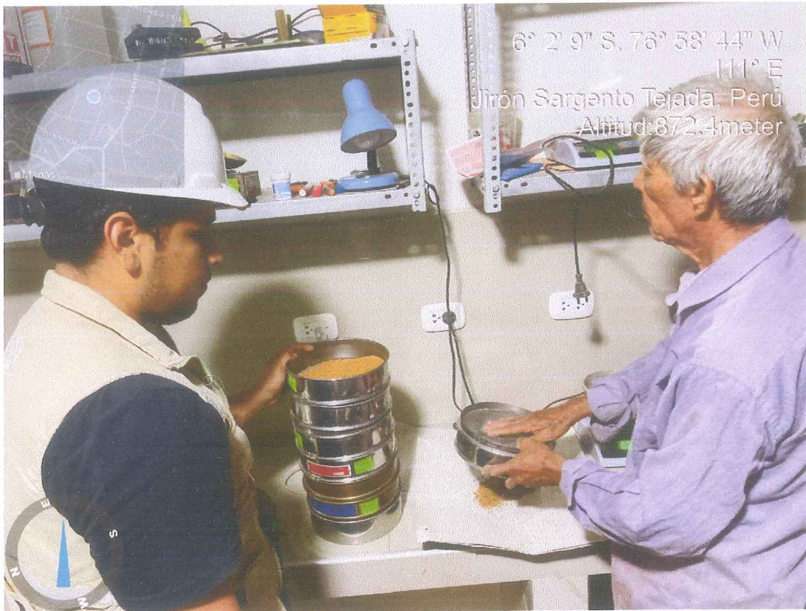
Análisis granulométrico del agregado fino, grueso y global NTP 400.012 - AGREGADOS. tamizado mecánico por la serie de tamices, fracción fina.
