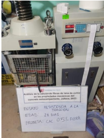
FOTO 97: RESISTENCIA A LA TRACCIÓN
