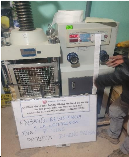
FOTO 73: EQUIPO RESISTENCIA A LA COMPRESION
