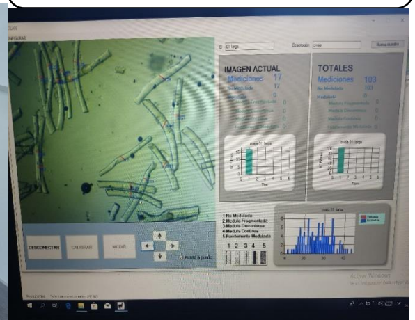
FOTO 22: VISUALIZACION MICROSCOPICA DE LA FIBRA,
