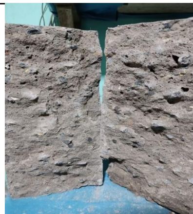
FOTO 78: ROTURA A LA TRACCION
