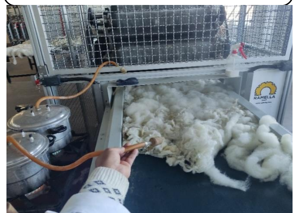
FOTO 12: HUMEDAD APLICADA A LA FIBRA
