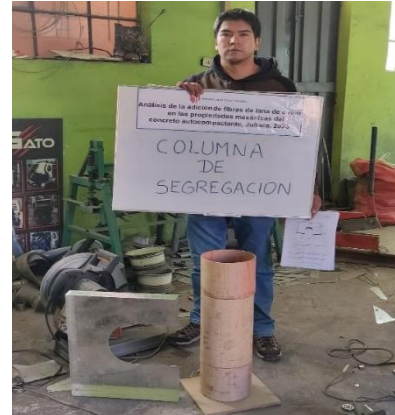
FOTO 62: ELABORACION DE COLUMNA DE SEGREGACION
