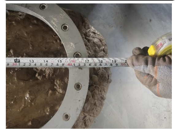
FOTO 54: MEDIDA DE DIAMETRO J RING
