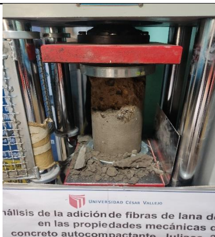
FOTO 65: ROTURA DE PROBETA A COMPRESION
