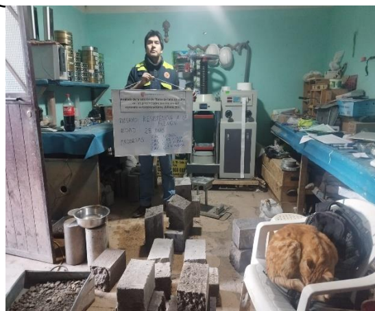
FOTO 84: VIGAS DESPUES DE ROTURAS
