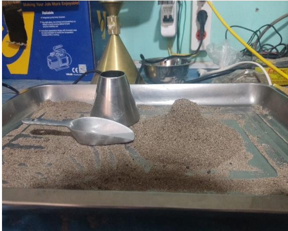
FOTO 37: PESO MATERIAL SSS AGREGADO FINO
