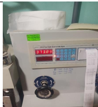
FOTO 72: FUERZA APLICADA POR EL EQUIPO EN KN
