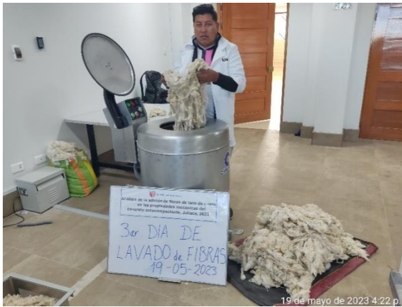
FOTO 07: USO DE CENTRIFUGA DESPUES DEL LAVADO
