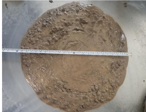
FOTO 56: MEDIDA DE FLUJO DE ASENTAMIENTO
