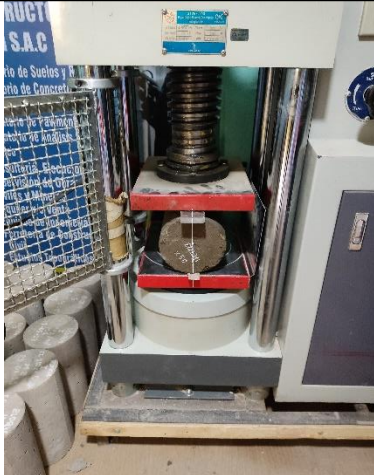
FOTO 75: ENSAYO DE RESISTENCIA A LA TRACCION
