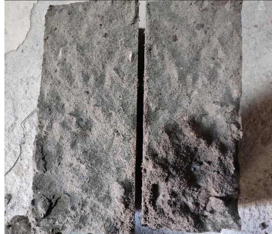
FOTO 76: ROTURA DE TRACCION
