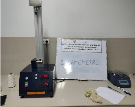
FOTO 25: USO DEL EQUIPO DINAMOMETRO RESISTENCIA A LA TRACCION DEL HILO
