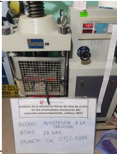
FOTO 99: RESISTENCIA A LA TRACCIÓN
