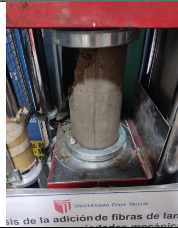
FOTO 64: ROTURA DE PROBETA A COMPRESION
