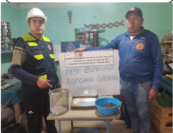
FOTO 34: PESO ESPECIFICO SSS SUMERGIDO
