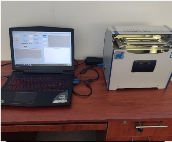
FOTO 19: USO DEL FIBER EC (DIAMETRO DE LA FIBRA)
