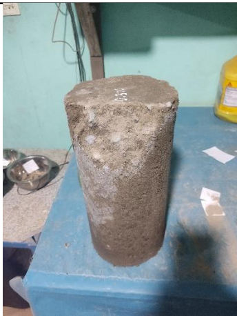
FOTO 69: TIPO DE FALLA 5
