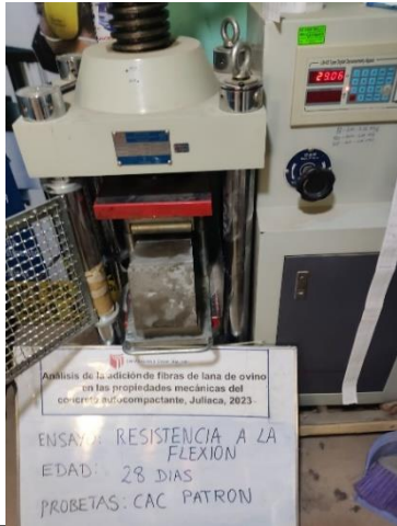
FOTO 85: RESISTENCIA A LA FLEXION VIGAS
