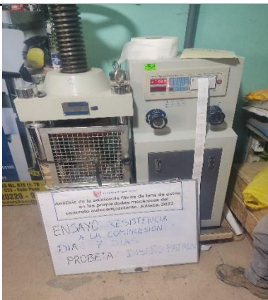
FOTO 71: EQUIPO RESISTENCIA A LA COMPRESION
