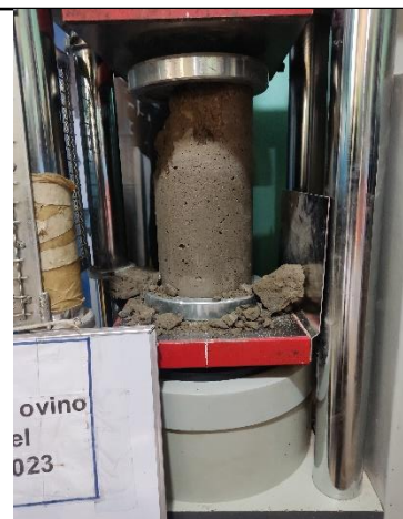
FOTO 66: ROTURA DE PROBETA A COMPRESION
