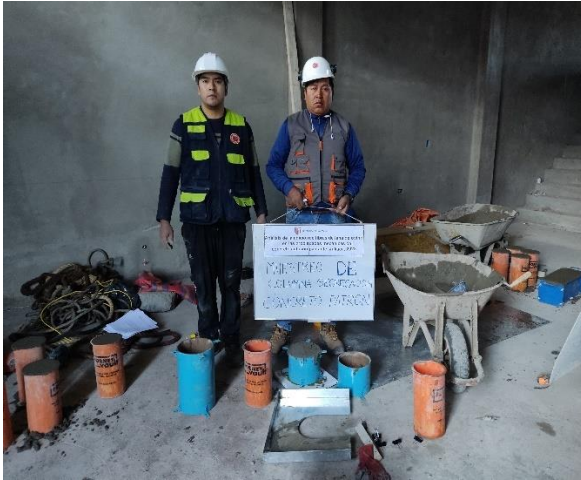
FOTO 49: MUESTREO DE SEGREGACION ESTATICA
