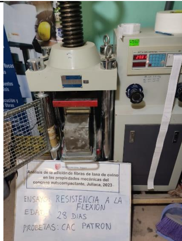
FOTO 87: RESISTENCIA A LA FLEXION EN VIGAS
