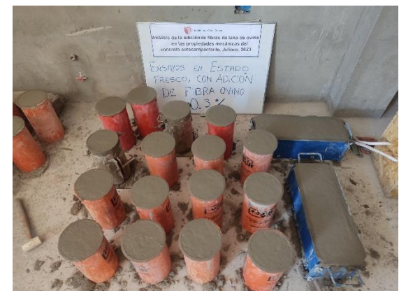
FOTO 59: REALIZANDO LAS PROBETAS Y VIGAS DE LOS DISEÑOS
