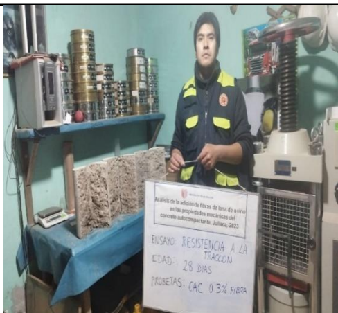
FOTO 77: ROTURA DE TRACCION
