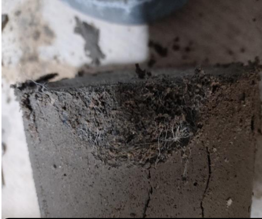
FOTO 67: FIBRA EN EL CONCRETO
