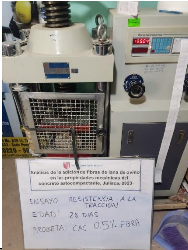
FOTO 79: EQUIPO RESISTENCIA A LA TRACCION INDIRECTA
