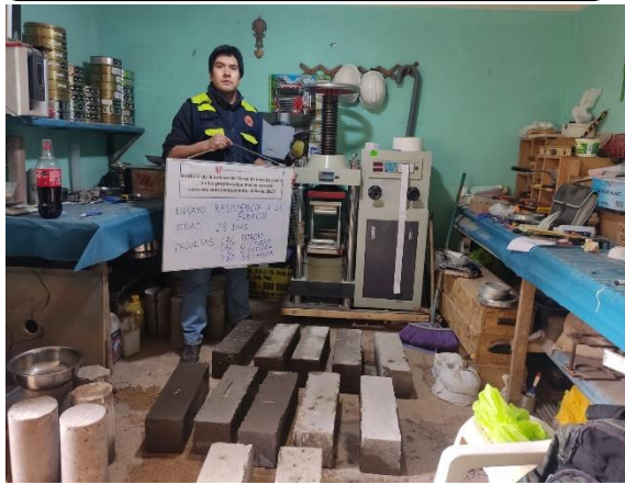
FOTO 81: VIGAS PARA ENSAYO A FLEXION
