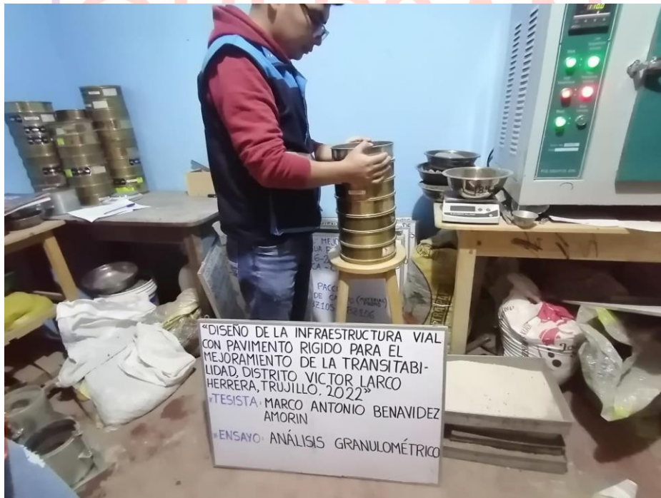
FOTOGRAFÍA N° 8. Ensayo de Análisis Granulométrico
