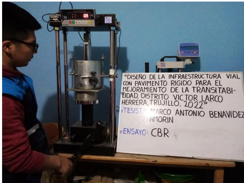
FOTOGRAFÍA N° 10. Ensayo de California Bearing Ratio (CBR)
