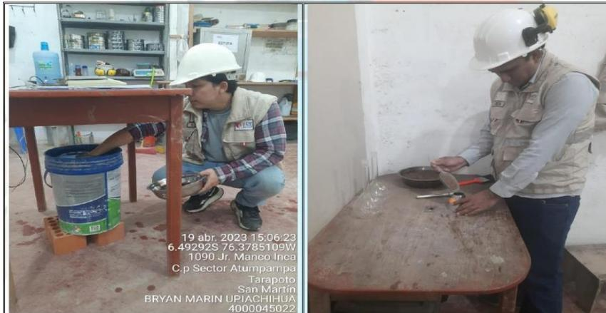
Fotos n° 07-08: En las imágenes podemos observar el ensayo de gravedad específica de los agregados.
