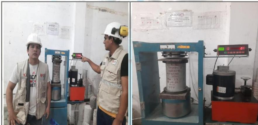
Fotos n° 23-24: En las imágenes podemos observar la resistencia a la compresión axial de los testigos de concreto
