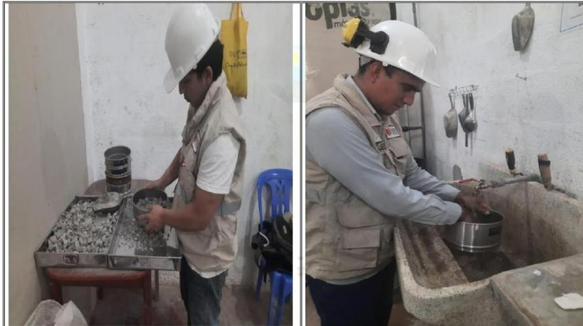
Fotos n° 05-06: En las imágenes se puede apreciar el ensayo de análisis granulométricos y el lavado de la arena zarandeada para ser utilizada en la mezcla de concreto.
