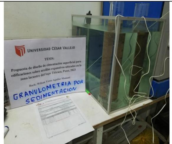
**Fotográfica 8:** Ensayo de granulometría por sedimentación
