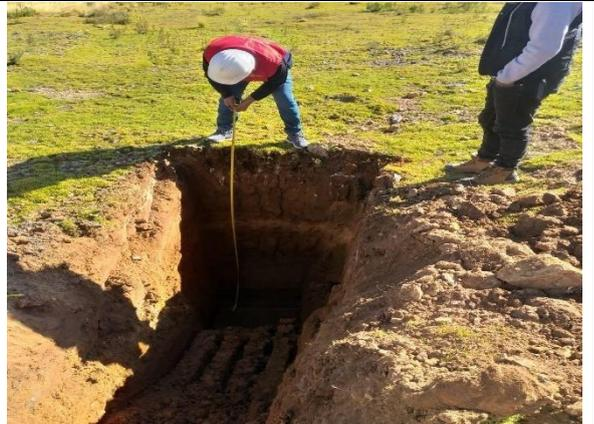
**Fotográfica 2:** Medición del nivel freático
