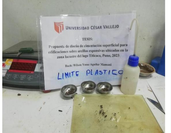
**Fotográfica 6:** Ensayo de límite plástico
