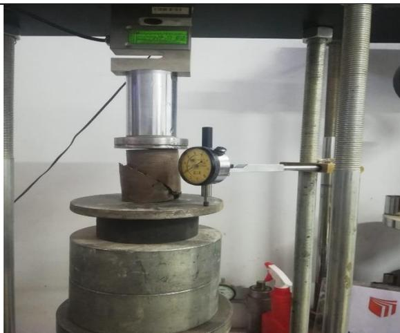
**Fotográfica 11:** Ensayo de compresión no confinada
