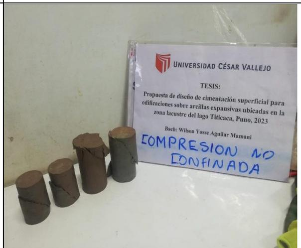
**Fotográfica 12:** Ensayo de compresión no confinada tipo de falla
