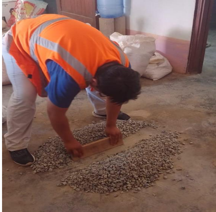
Foto 6: Preparación del material por el método del cuarteo malla #4, 1/2" y 3/4"
