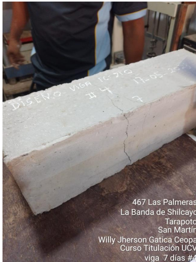
Foto 29: Falla del testigo luego de ser sometido a la prueba de flexión.
