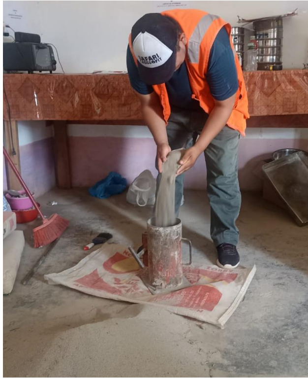
Foto 12: Puesta en molde en 3 capas para el peso unitario suelto, el cual se realizó tanto al elemento pétreo fino y los gruesos.
