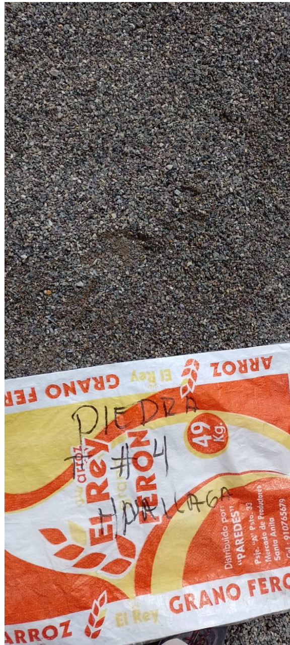
Foto 2: Selección del agregado grueso: Cantera del rio Huallaga, Buenos Aires, Picota.
