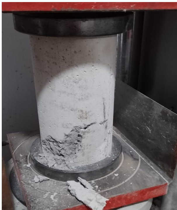
Foto 26: Falla del testigo luego de ser sometido a la prueba de compresión.
