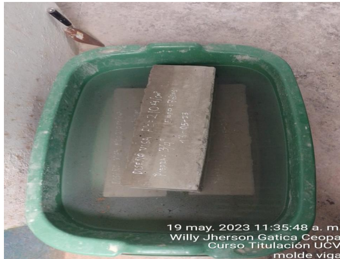
Foto 23: colocación de los moldes de viga en agua potable para su respectivo curado.
