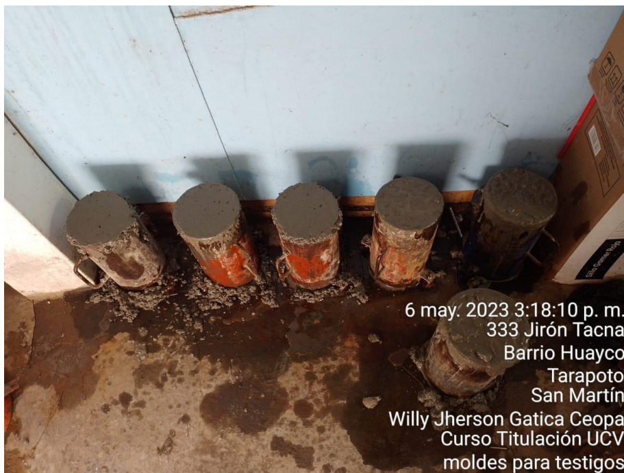
Foto 20: colocación del concreto en los moldes, se visualiza el enrase.
