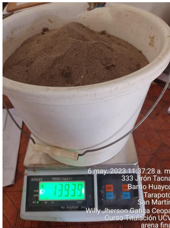
Foto 16: pesado del elemento pétreo fino, este pesado se realizó con cada diseño.
