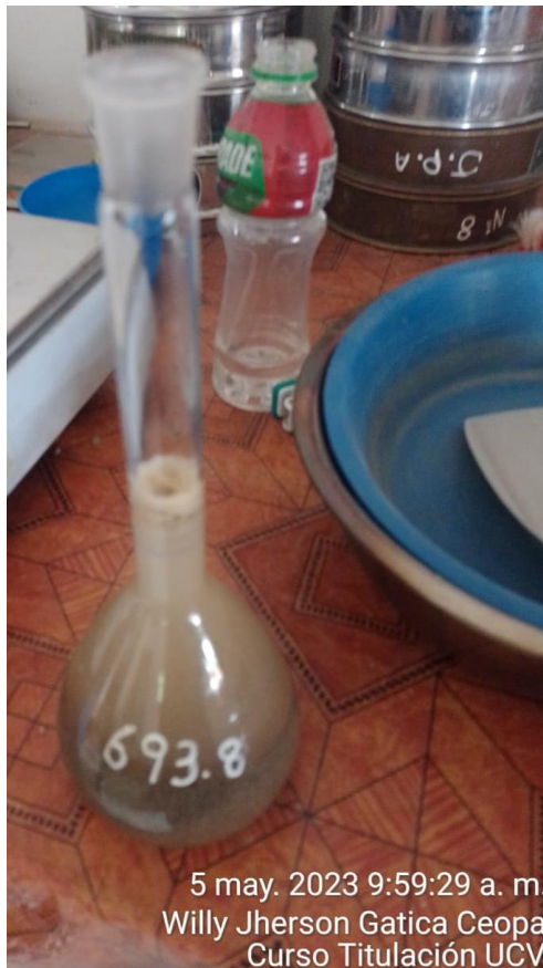
Foto 15: Extracción de las burbujas de aire para luego ser secada en horno durante 24 horas.
