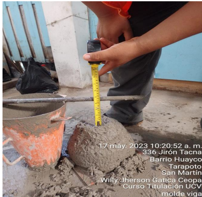
Foto 19: verificación del asentamiento con el cono de Abrams, se realizó para cada tipo de agregado grueso para los moldes de viga
