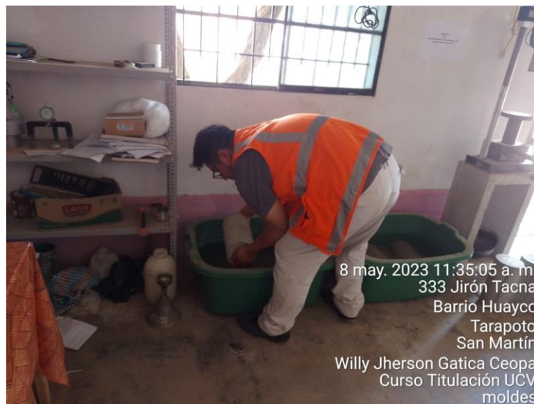
Foto 22: colocación de los moldes en agua potable para su respectivo curado.
