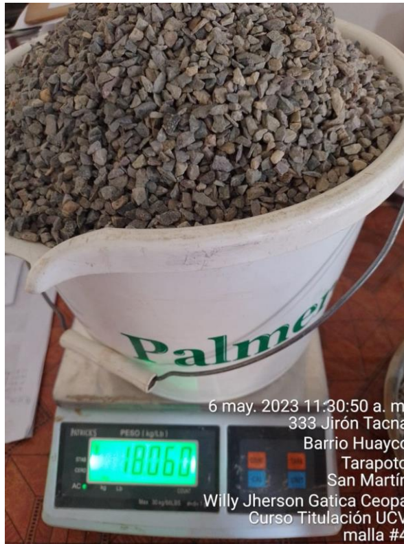
Foto 16: pesado de los elementos pétreos grueso, este pesado se realizó con cada elemento para sus respectivos diseños.
