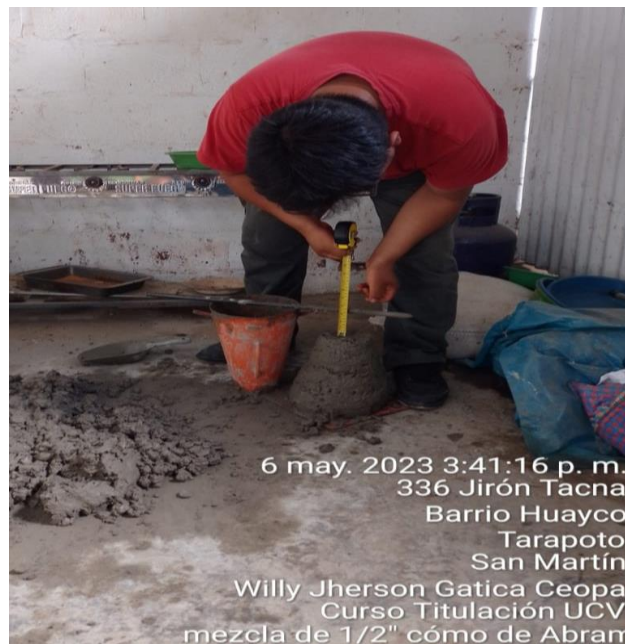
Foto 18: verificación del asentamiento con el cono de Abrams, se realizó para cada tipo de agregado grueso.
