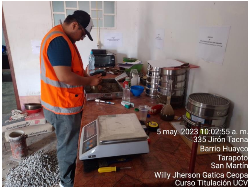
Foto 14: Puesta en verificación si el elemento pétreo fino este completamente seco
