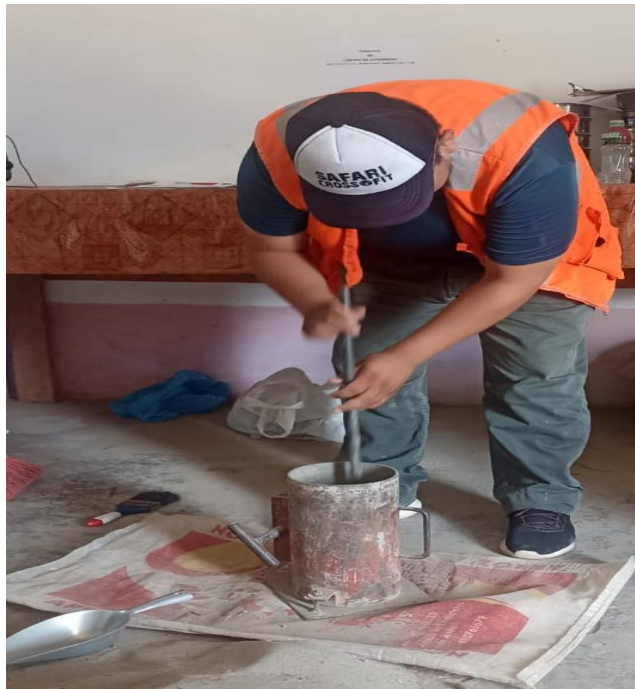
Foto 13: Puesta en molde en 3 capas para el peso unitario suelto, el cual se realizó tanto al elemento pétreo fino y los gruesos.
