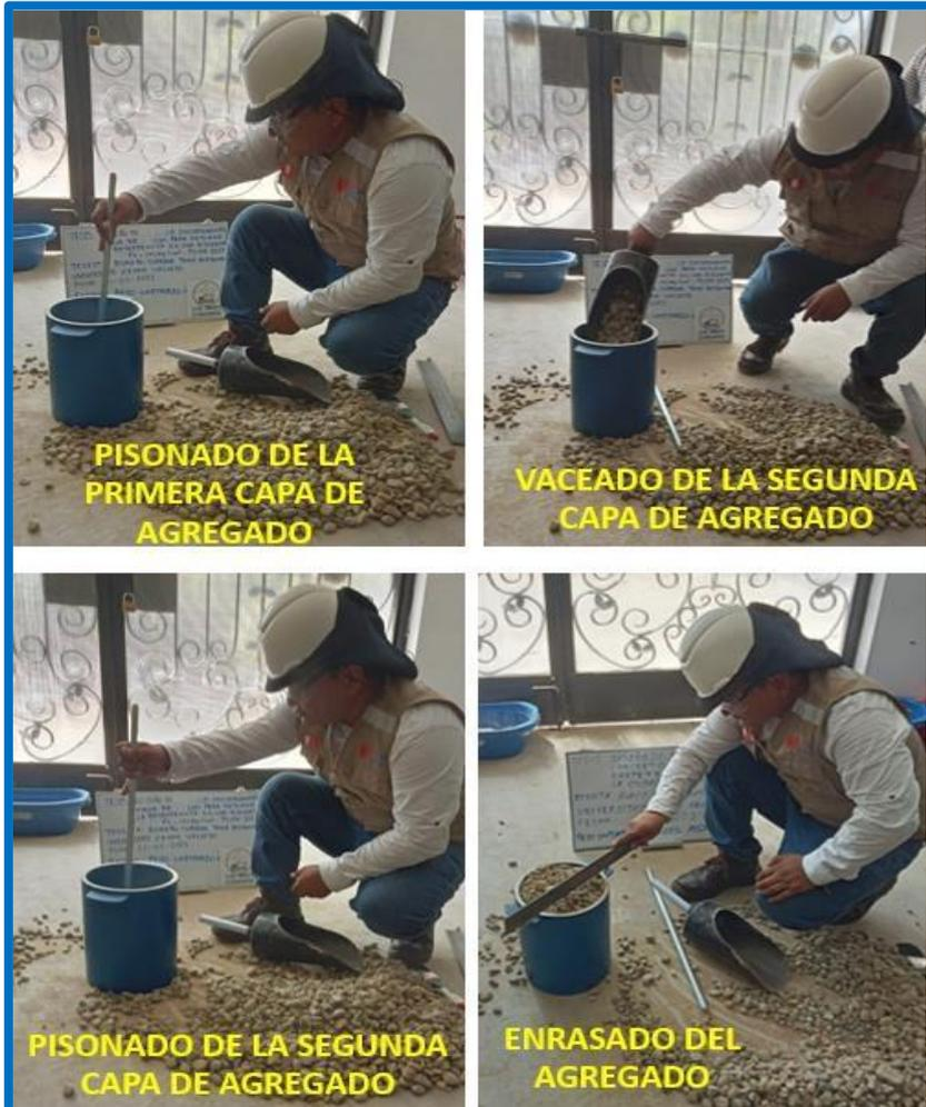
**Figura 23: Ensayo de Peso Unitario de agregado grueso**
