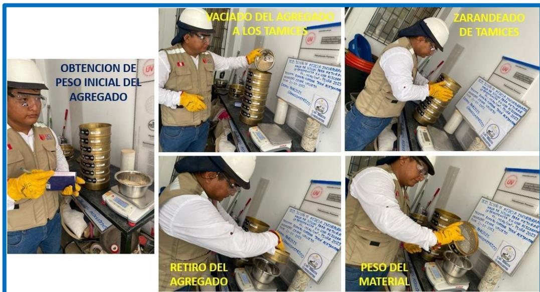
**Figura 22: Ensayo de Análisis granulométrico de los agregados finos**
