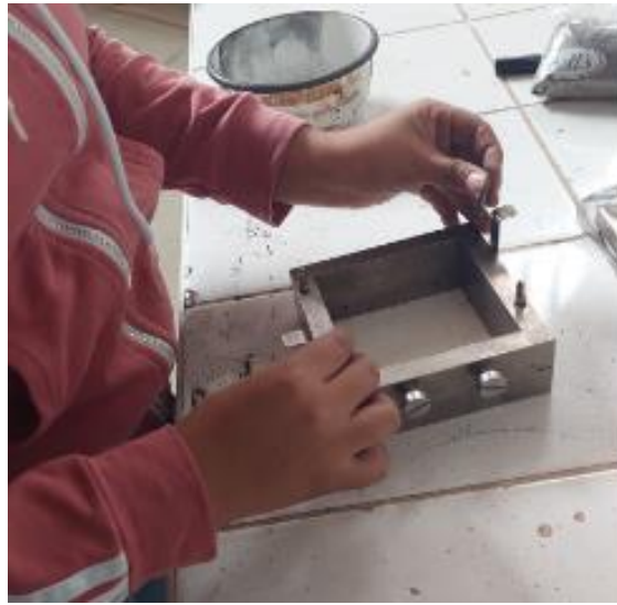
Fotografía 29: Se arma la caja de corte, se coloca las placas de transferencia de cargas y luego los tornillos.
