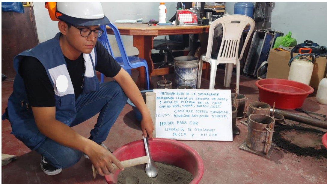
Fotografía 15 y 16: Añadimos las cenizas y colocamos el porcentaje de agua necesaria.
