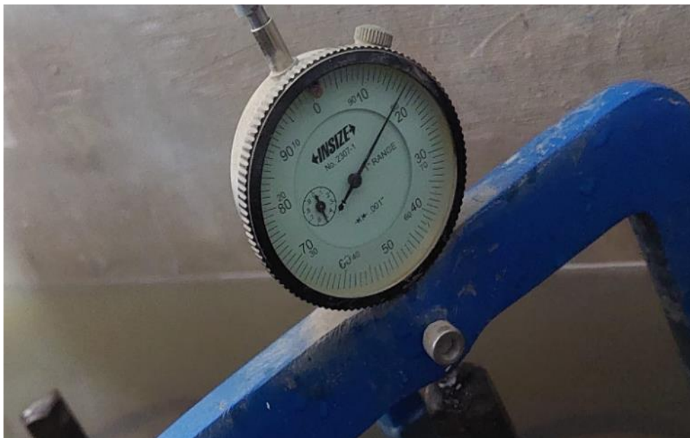
Fotografía 26: Se toma la expansión de la muestra saturada con el dial.
