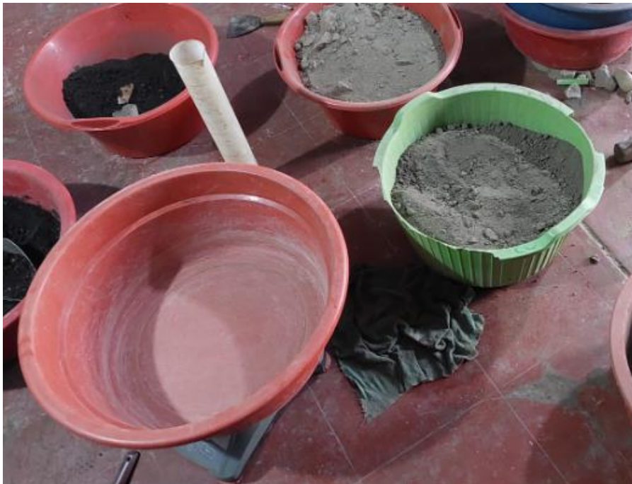
Fotografía 14: Cuarteo y preparación de la muestra para el ensayo de CBR.
