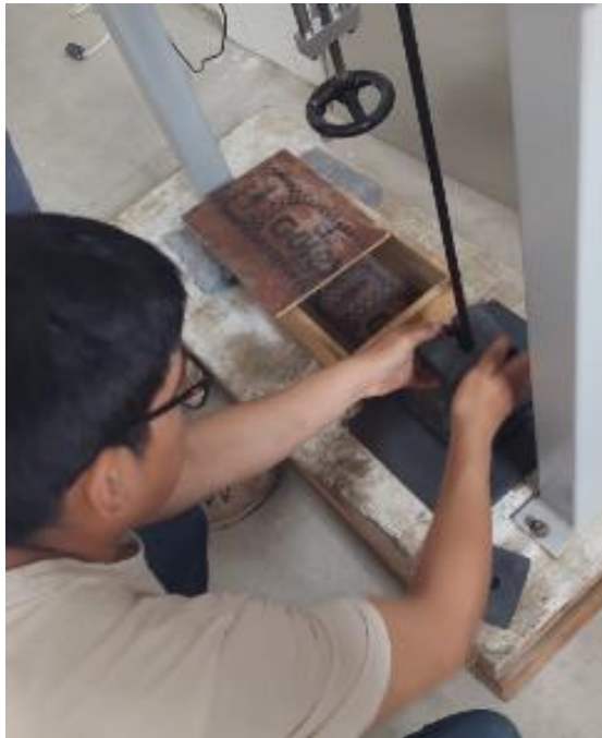
Fotografía 33: Se colocan los pesos en el brazo de palanca para nivelarlo.
