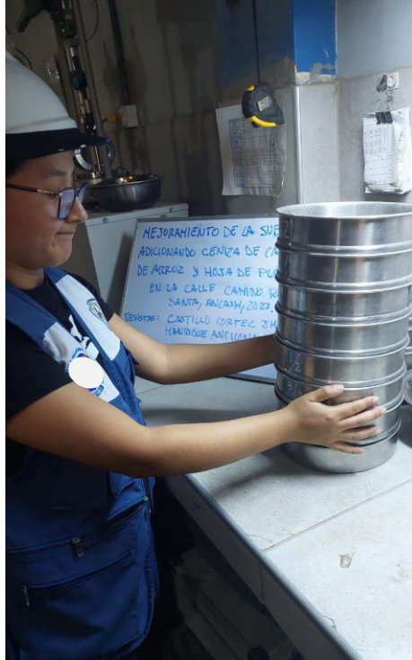
Fotografía 09: Granulometría, tamizado de las muestras.
