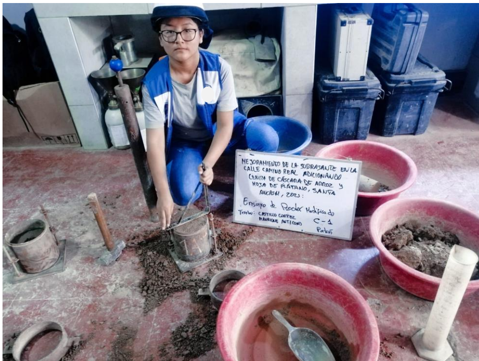
Fotografía 12: Retiro del collar de extensión y enrasado de molde.
