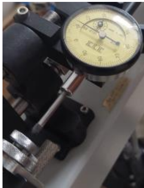
Fotografía 37: Se programa la velocidad para que el dial de carga haga contacto y se toma lecturas, teniendo como guía el dial de deformación tangencial.
