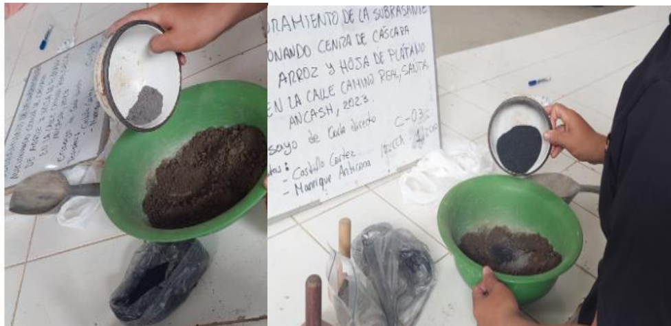
Fotografía 30: Colocamos las cenizas a la muestra y mezclamos.
