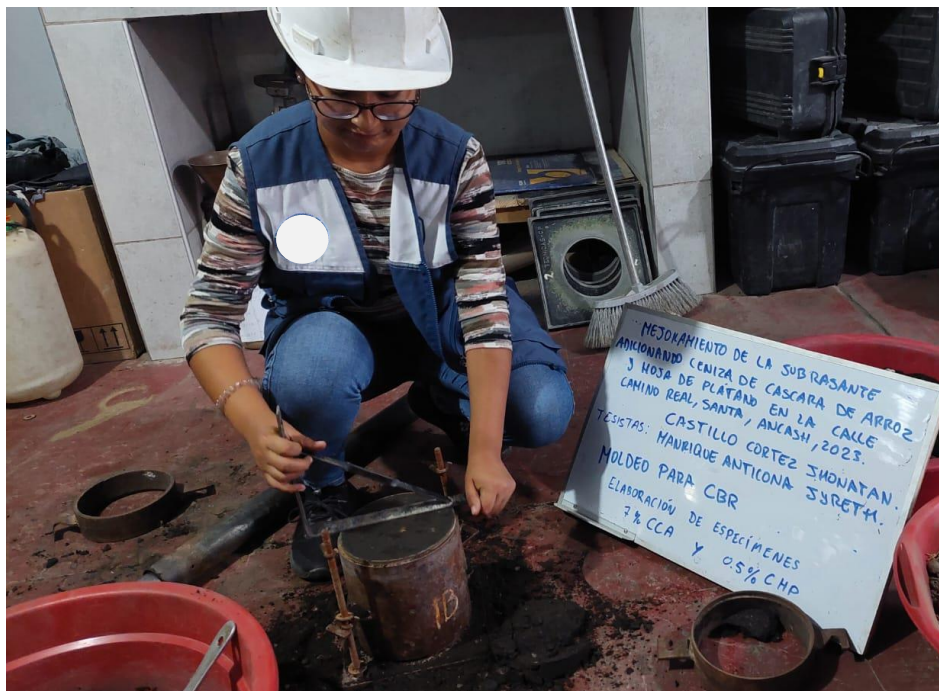
Fotografía 19 y 20: Retiramos el collar de extensión superior y luego enrasamos el molde.
