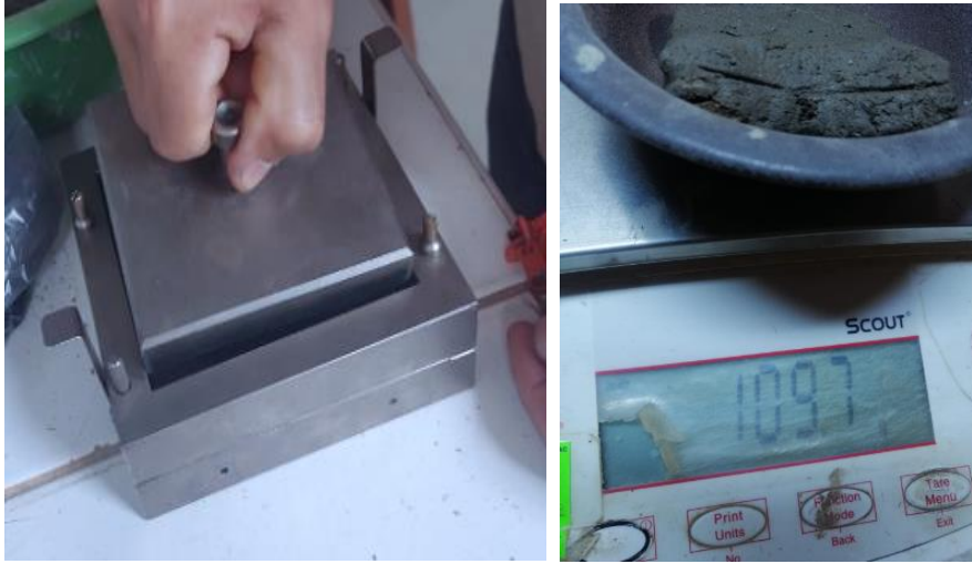
Fotografía 39: Se desmolda y la muestra se procede a pesar para conocer el contenido de humedad al final del ensayo.
