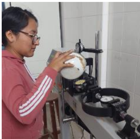
Fotografía 34: Se ajusta el soporte por el cual se va a transmitir la carga hacia la muestra y se llena de agua el molde.
