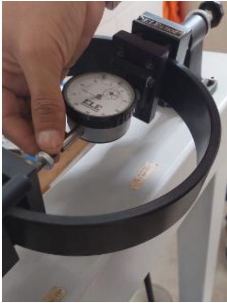
Fotografía 37: Se programa la velocidad para que el dial de carga haga contacto y se toma lecturas, teniendo como guía el dial de deformación tangencial.
