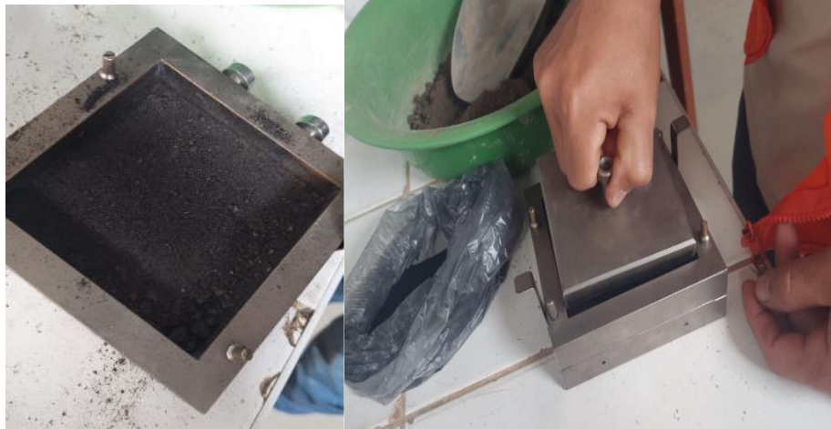
Fotografía 31: Colocamos la muestra necesaria con las placas de transferencia de carga y cerramos la caja de corte.
