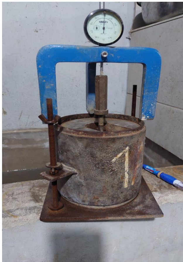
Fotografía 23 y 24: Se coloca el trípode de medida sobre el borde del molde para posteriormente calcular la expansión.
