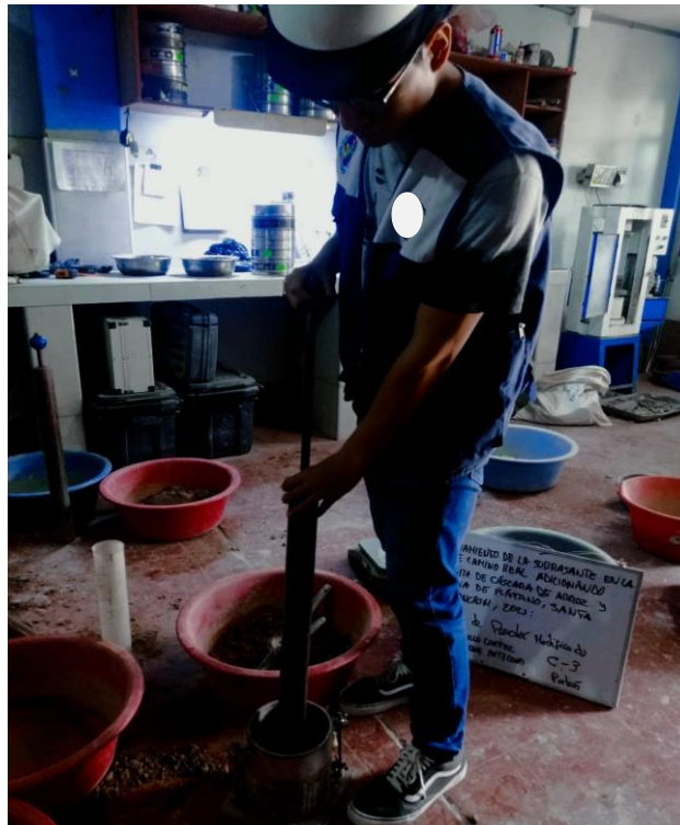
Fotografía 11: Compactación de la muestra a 56 golpes.
