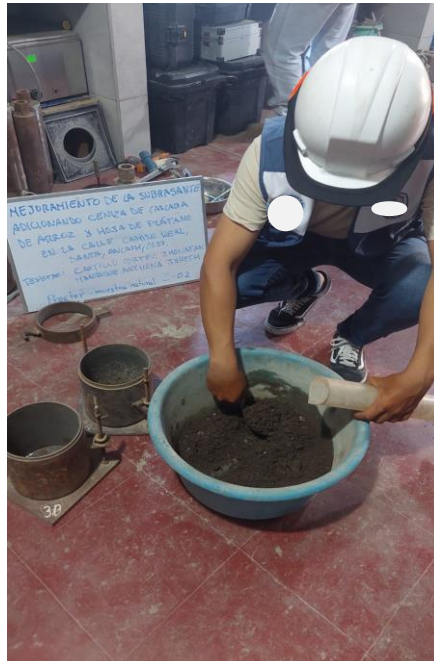
Fotografía 11: Preparación y cuarteo de la muestra para el ensayo de Proctor Modificado.
