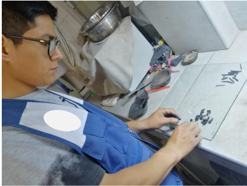
Fotografía 11: Ensayo de Límite Plástico.
