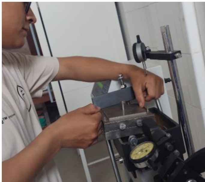
Fotografía 38: Se procede a retirar la caja de corte, retirando el agua previamente.
