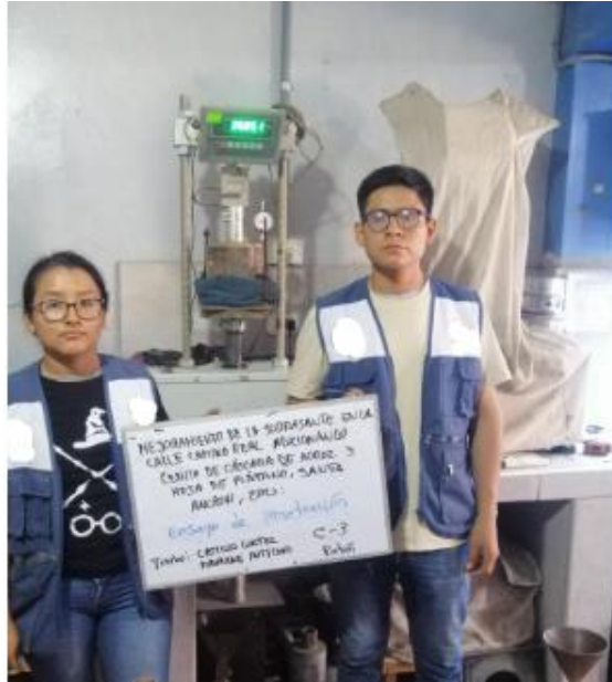
Fotografía 27: Se realiza el ensayo de penetración a la muestra saturada.
