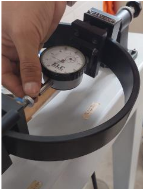
Fotografía 36: Se programa la velocidad para que el dial de carga haga contacto y se toma lecturas.
