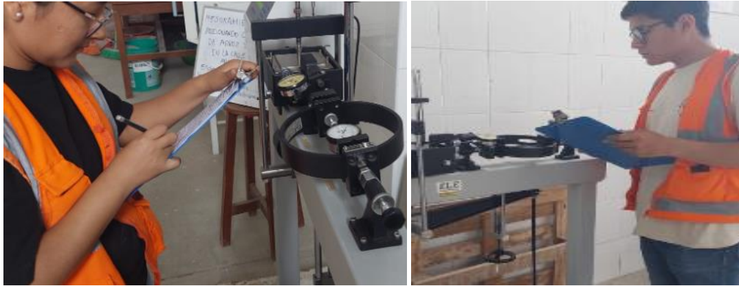
Fotografía 35: Se procede a tomar lectura del dial al aplicar la deformación normal, hasta llegar a la consolidación primaria (lectura constante).
