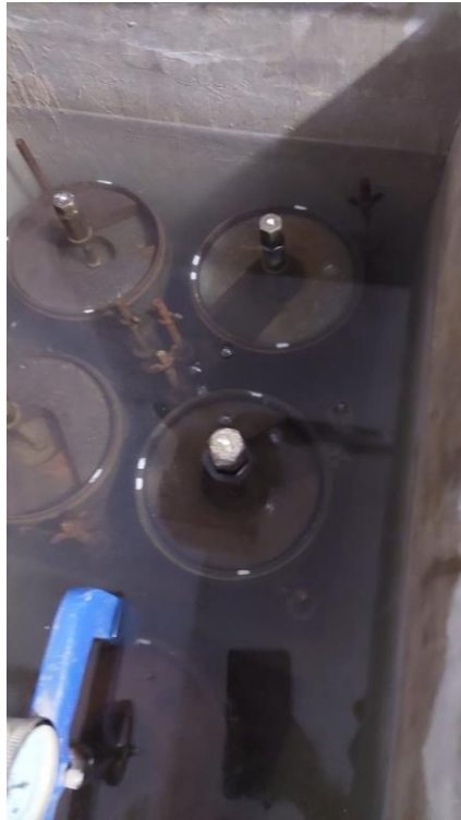
Fotografía 25: Se sumergen los moldes en agua por 4 días.
