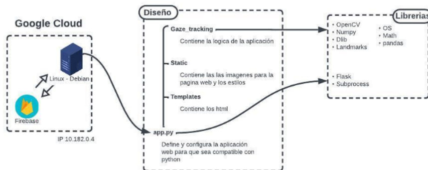
Figura 10: Arquitectura del aplicativo - fuente propio
