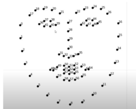
Figura 04: Capturas de los puntos de referencia faciales de la librería dlib para la detección de landmarks faciales.
