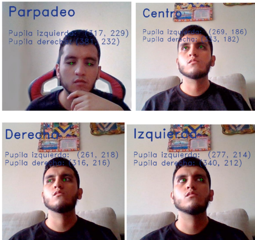
Figura 09: Capturas de los puntos de referencia seguimiento ocular de nuestro sistema
