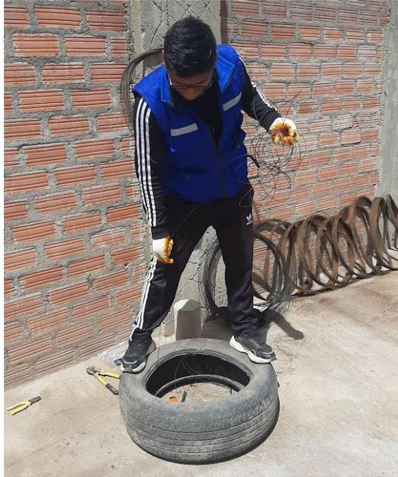
Se visualiza la obtención del acero de neumático manualmente
