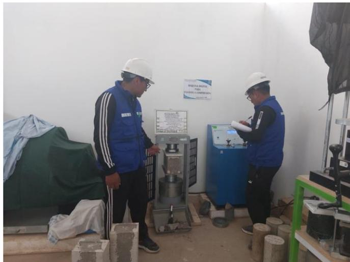
Se visualiza el ensayo a compresión a los 7 días.
