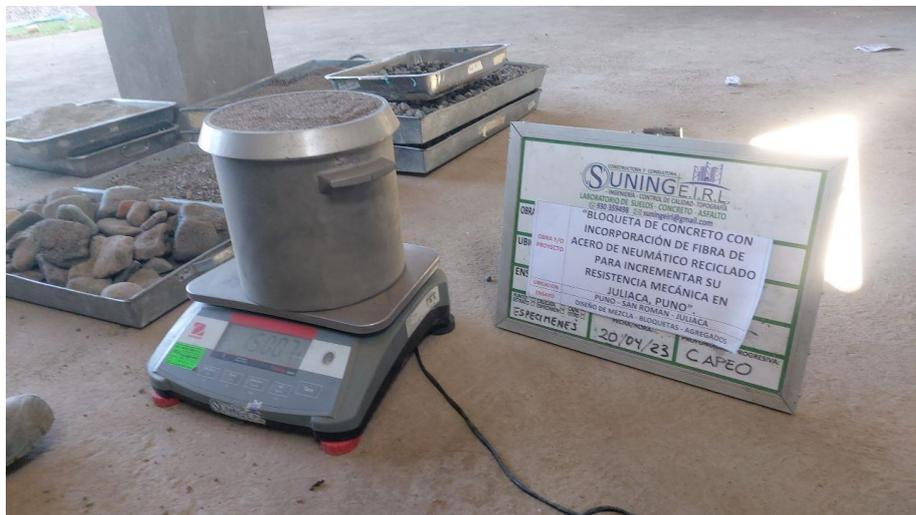
Se visualiza el pesaje para el ensayo del peso unitario suelto del agregado fino.
