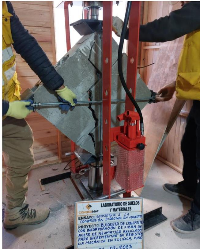
Se visualiza el tipo de falla en el ensayo de compresión diagonal.
