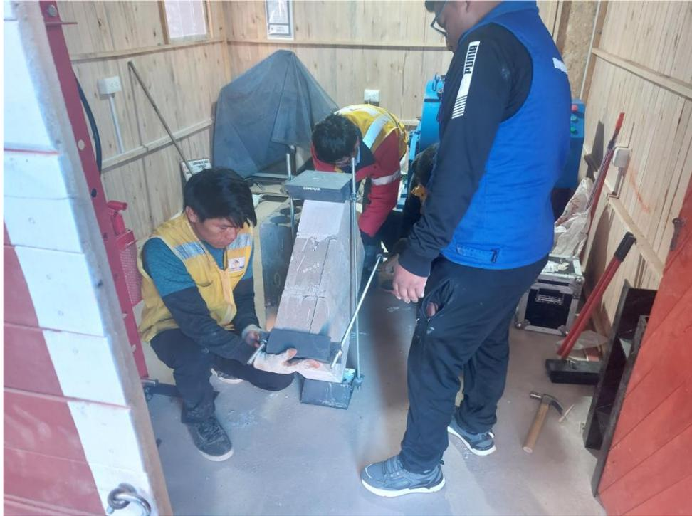
Se visualiza el preparado del murete para someter a la prensa hidráulica.
