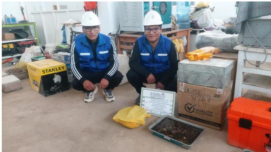
Se visualiza la muestra saturada para el ensayo de gravedad específica y absorción del agregado grueso
