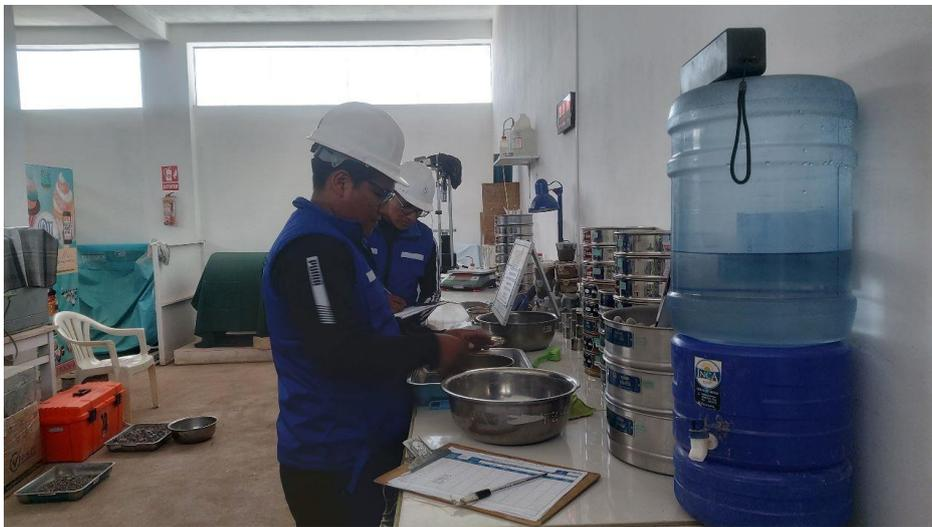
Se visualiza el ensayo de granulometría manualmente.
