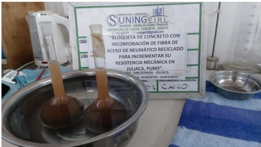
Se visualiza los frascos para el ensayo de gravedad específica y absorción del agregado fino
