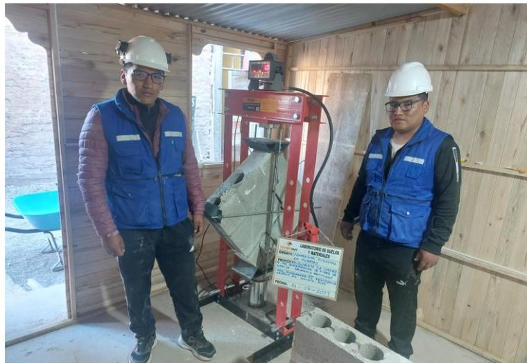
Se visualiza el ensayo de compresión diagonal en muretes.
