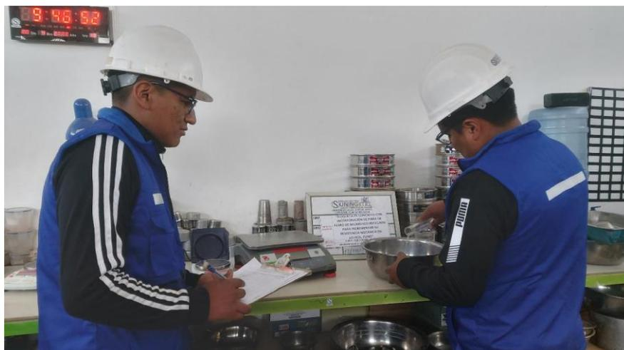
Se visualiza la saturación del agregado fino para realizar el ensayo de consistencia
