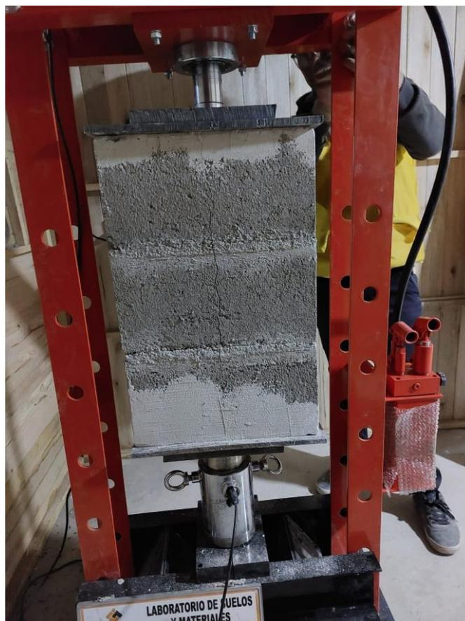
Se visualiza el ensayo de compresión en prismas.
