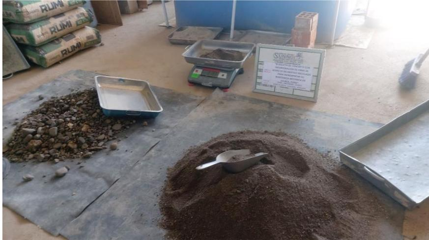
Se visualiza los agregados con el que se realizó el diseño de mezclas
