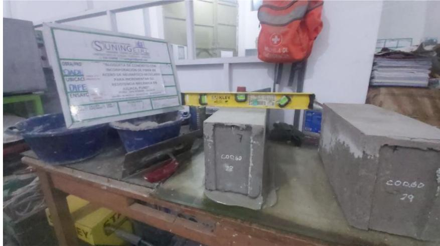
Se visualiza el capeo de las bloquetas para los ensayos de resistencia a compresión.
