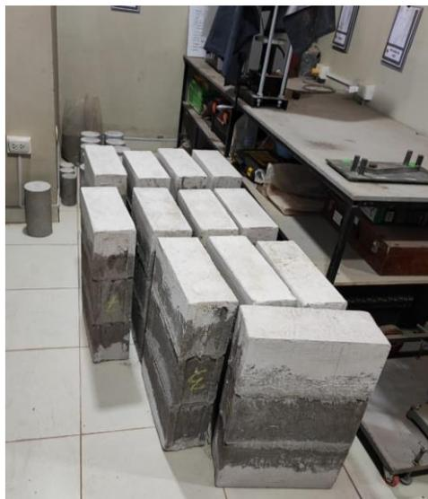
Se visualiza las pilas antes de someter a la prensa hidráulica
