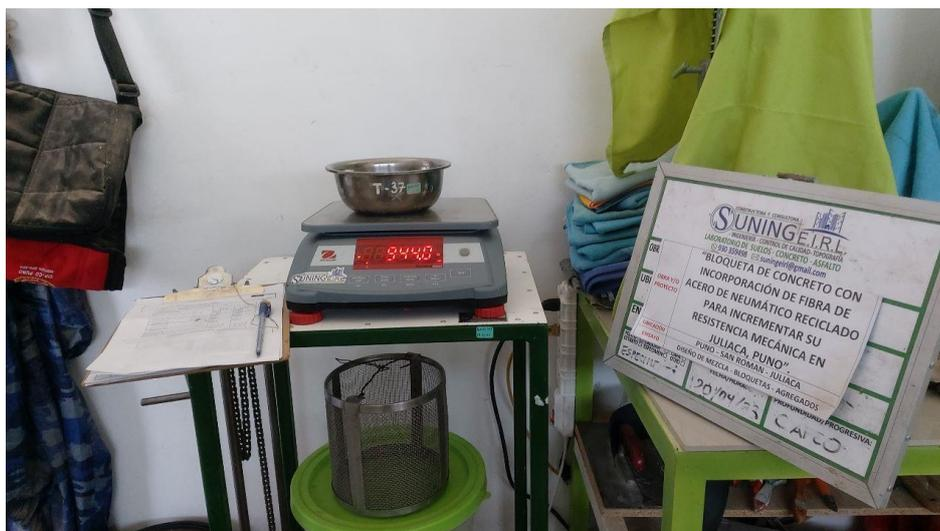
Se visualiza el pesado de la muestra seca para el ensayo de gravedad específica y absorción.
