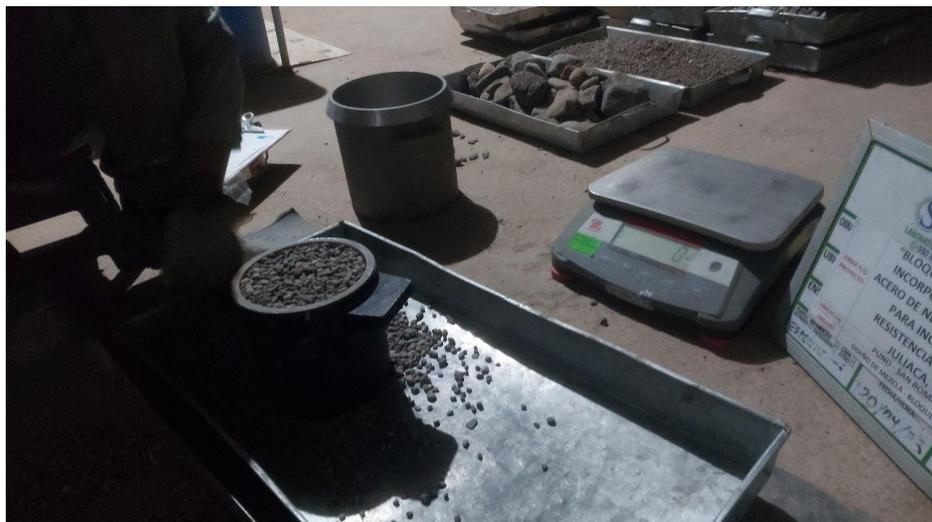
Se visualiza el ensayo para la determinación del peso unitario suelto del agregado grueso
