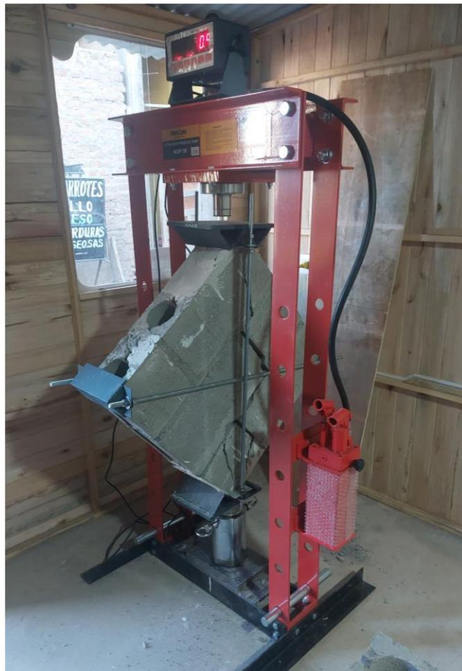
Se visualiza el murete en la prensa hidráulica.
