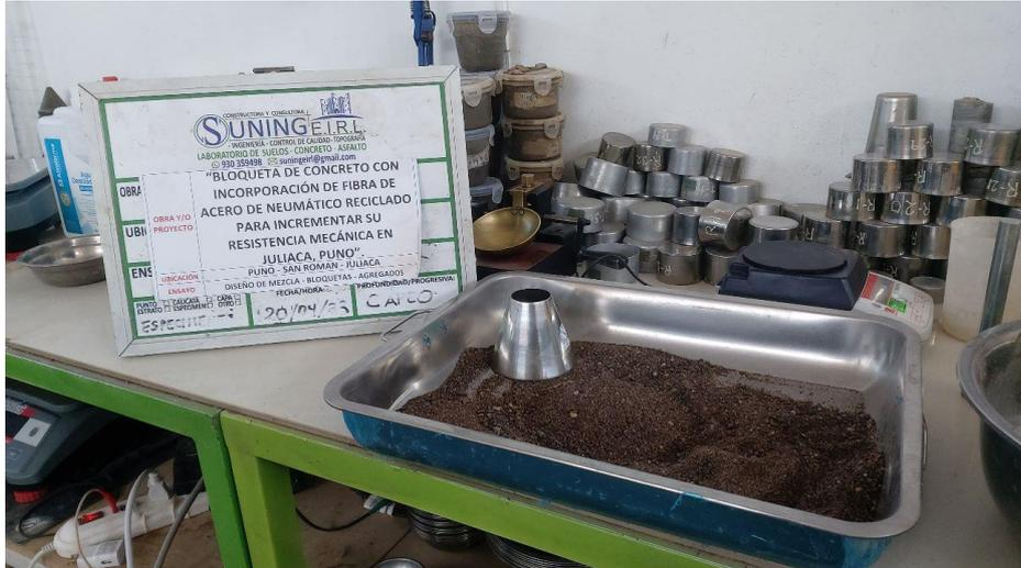
Se visualiza el ensayo para determinar la consistencia del agregado fino.
