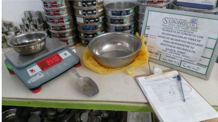
Se visualiza el pesado de la muestra de prueba seca de superficie saturada para el ensayo de gravedad específica y absorción.
