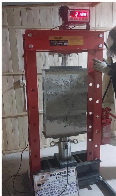
Se visualiza el ensayo de compresión en pilas.
