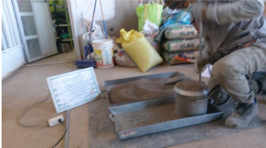
Se visualiza el ensayo para la determinación del peso unitario varillado del agregado grueso.
