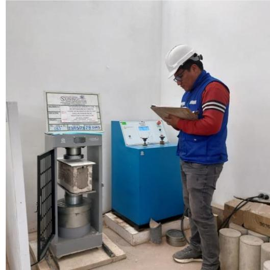
Se visualiza el ensayo a compresión a los 28 días.
