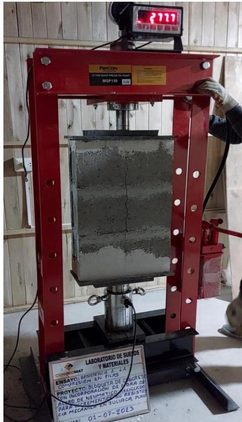
Se visualiza el ensayo de compresión en prismas.
