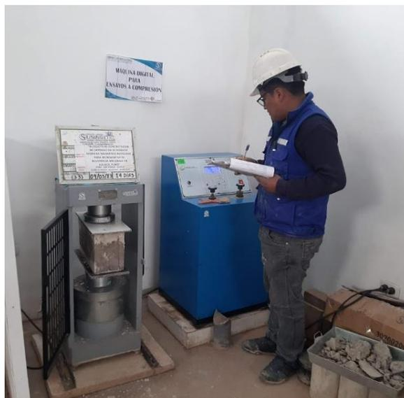
Se visualiza el ensayo a compresión a los 14 días.
