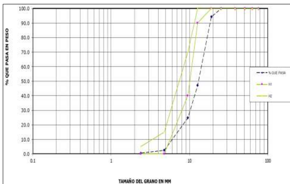
Figura N°05: Tamizado de agregado grueso.
