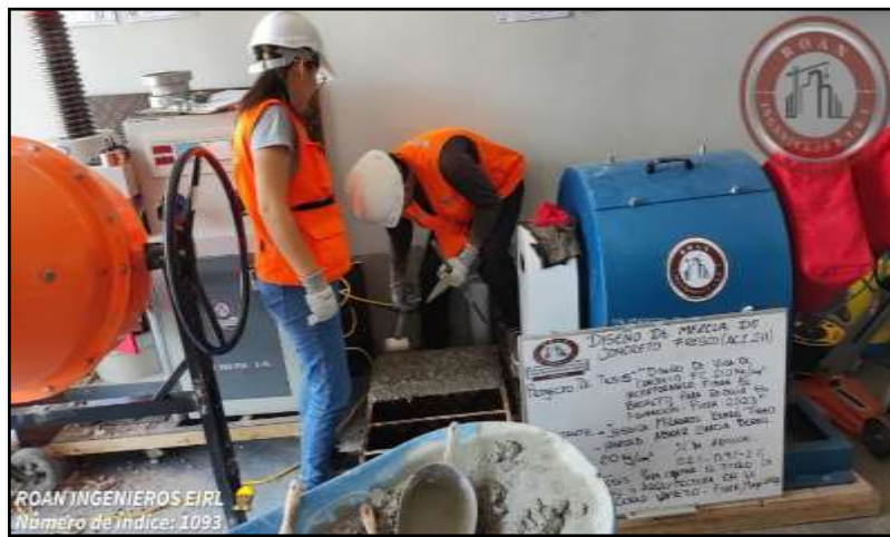
Figura N°09: Producción de probetas para los ensayos a flexión.
