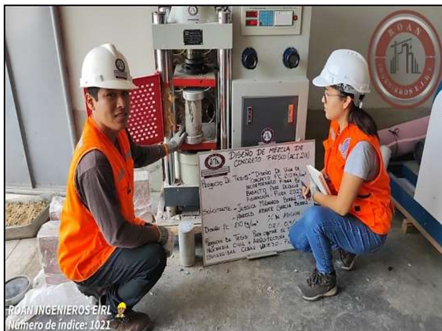
Figura N°08: Ensayo de resistencia a la compresión.
