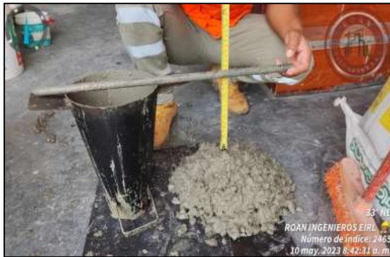
Figura N°06: Resultados de ensayos en cono de abrams (slump)
