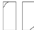
Tipo 5 Fracturas en los lados en las partes superior o inferior (ocurre comúnmente con cabezales no adheridos)
