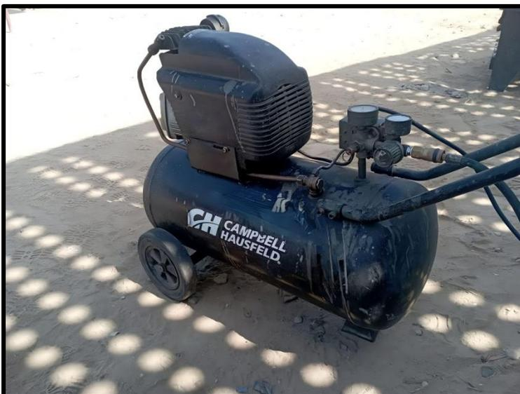
**IMAGEN 04:** Compresor de aire Campbell Hausfeld (Código: MTI-A004), este equipo es primordial para el proceso de pintado, otro punto importante del porque lo utilizamos es que nos permite ahorrar tiempo y son fáciles de usar y nos brinda un resultado eficiente.
