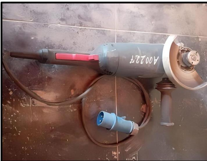
**IMAGEN 6:** Amoladora de 7" (Código: MTI-E002), la usamos para el proceso de corte, de cepillar, limpieza de oxido, pulir o desbaste a diferentes materiales.
