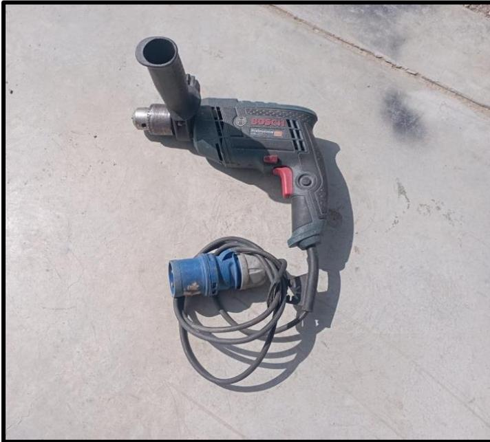
**IMAGEN 7:** Taladro de mano (Código: MTI-E003), lo utilizamos para perforar diversos materiales, este proceso de perforación se realiza mediante unas herramientas conocido como “Brocas”, que necesita este equipo para que pueda realizar su función correctamente.
