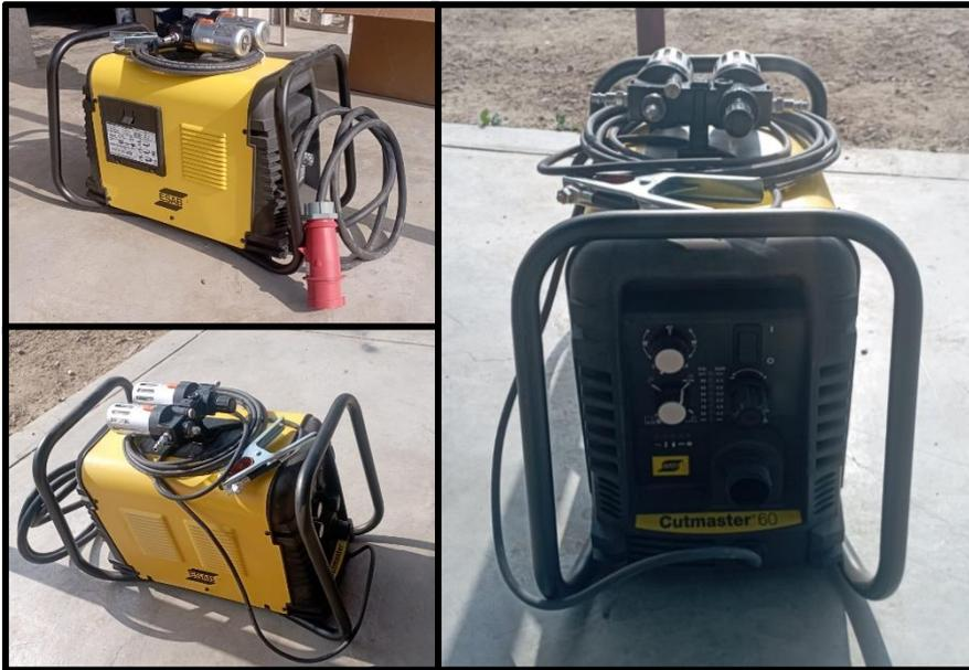
**IMAGEN 03:** Máquina de equipo plasma (Código: MTI-A003), este equipo lo utilizamos para hacer cortes y modificaciones de la mayoría de metales, especialmente el acero inoxidable. Este equipo fue adquirido porque nos ofrece métodos eficientes y precisos para corte, soldadura y otras aplicaciones clave.
