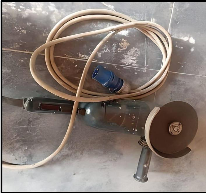
**IMAGEN 5:** Amoladora de 4 ½" (Código: MTI-E001), utilizamos para poder realizar el proceso de corte, desbaste en lugares estrechos de difícil acceso, nos ayuda en el corte de piezas y la limpieza de piezas metálicas.
