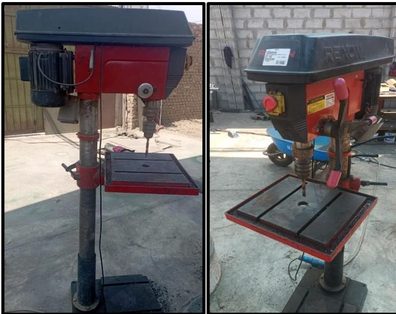
**IMAGEN 8:** Taladro de columna Rexon (Código: MTI-E004), se considera la versión estacionaria del taladro convencional, cuya función es la de un taladro insertado en un soporte vertical, este equipo lo utilizamos porque nos permite hacer agujeros precisos y cortes sobre cualquier material.
