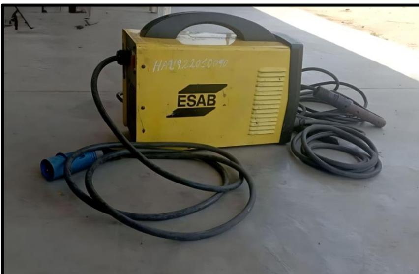
**IMAGEN 02:** Maquina de Electrodo – [soldar] (Código: MTI-A001), lo usamos para fijar la unión de dos materiales; cada tiempo se realiza revisiones periódicas para comprobar el amperaje y el estado interior de los componentes.
