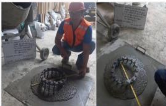
PRUEBA CAPACIDAD DE PASO / J- RING
