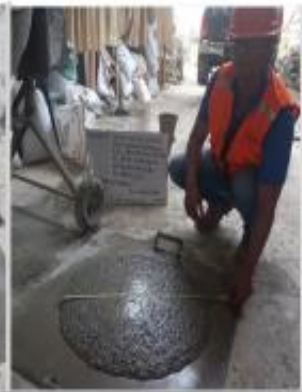
PRUEBA DE FLUJO DE ASENTAMIENTO
