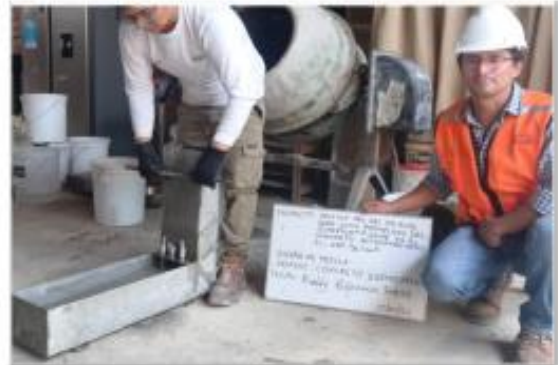
PRUEBA CAPACIDAD DE PASO / L- BOX
