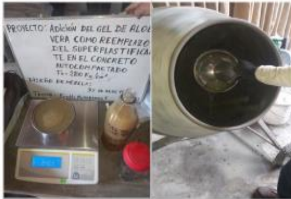
PREPARACIÓN DE MEZCLA DE CONCRETO
