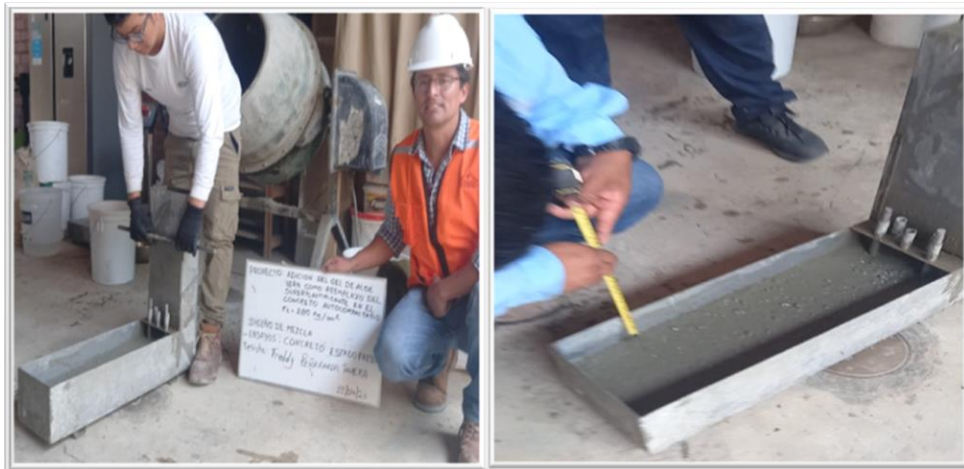
Figura 6. Visita al laboratorio, ensayo de habilidad de paso – Caja L.
