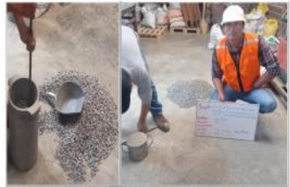
PESO UNITARIO DE LOS AGREGADOS
