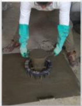
PRUEBA CAPACIDAD DE PASO / J- RING
