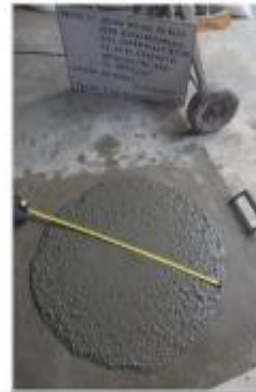
PRUEBA DE FLUJO DE ASENTAMIENTO
