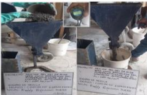
PRUEBA DE RELLENO / V-FUNNELL
