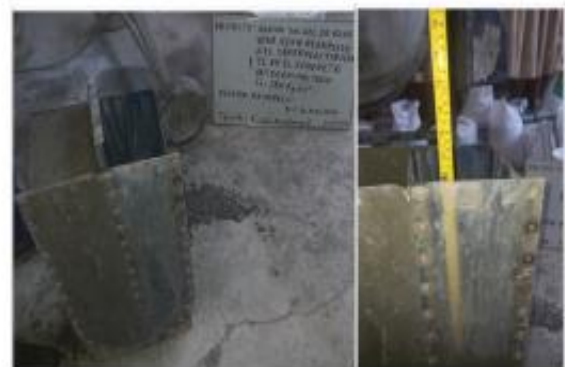
PRUEBA DE CAPACIDAD DE PASO / U-BOX
