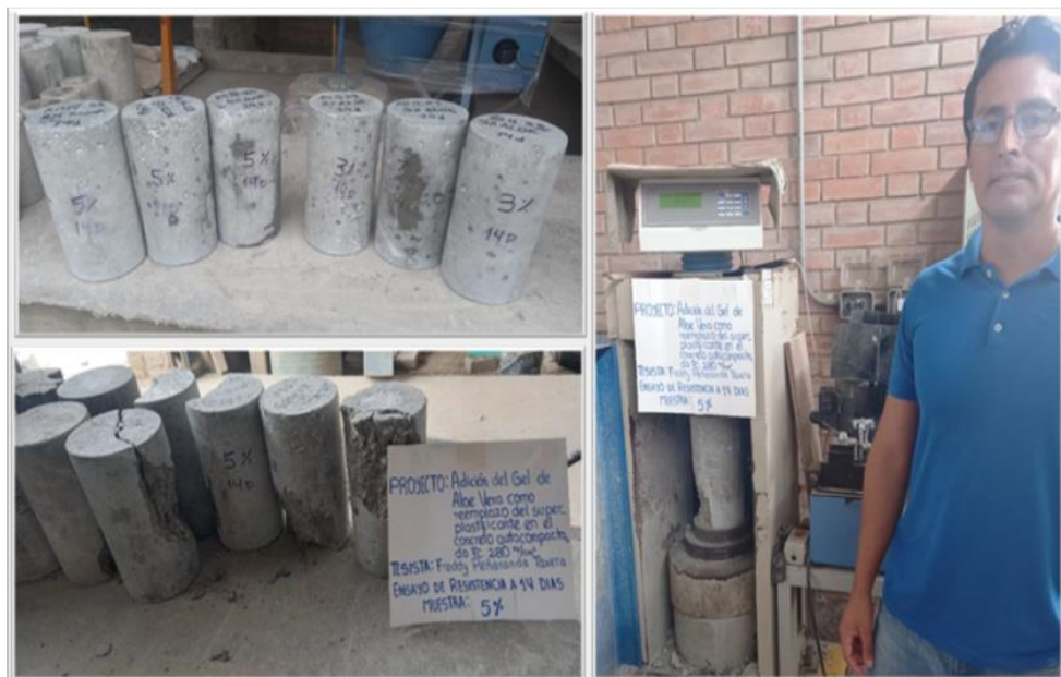
Figura 10. Laboratorio PUCP, resistencia a la compresión a 14 días
