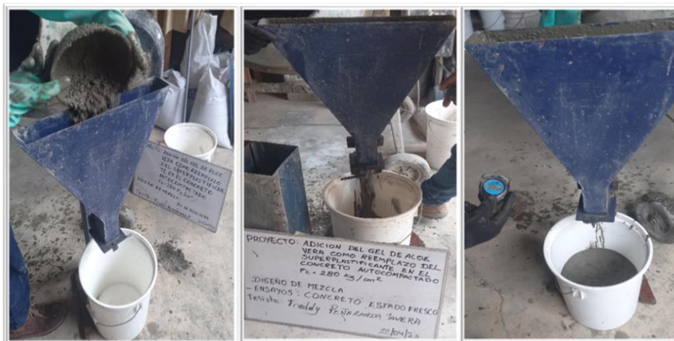
Figura 7. Visita al laboratorio, ensayo de habilidad de paso – Cono V.
