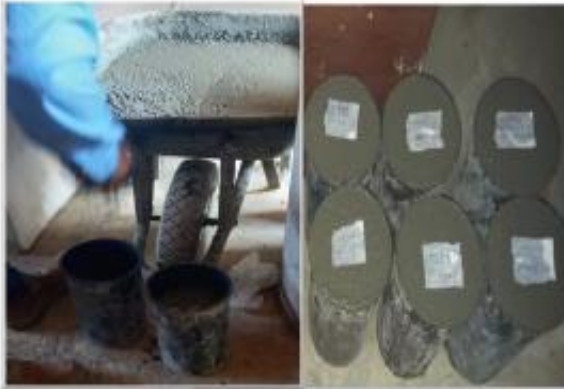
MOLDE DE PROBETAS CILINDRICAS DE 6" X 12"
