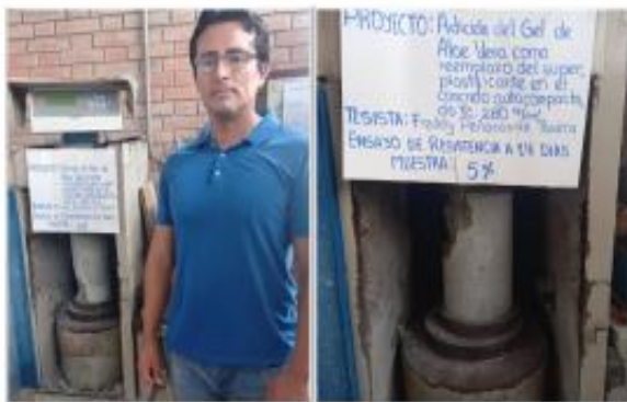
ENSAYOS DE RESISTENCIA A LA COMPRESIÓN A 14 DIAS (5%)
