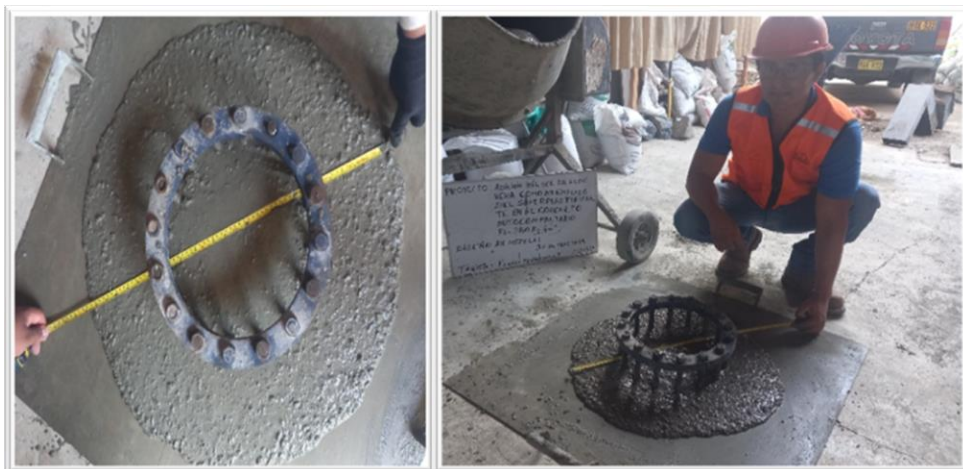
Figura 5. Visita al laboratorio, ensayo de fluidez y viscosidad - Anillo J
