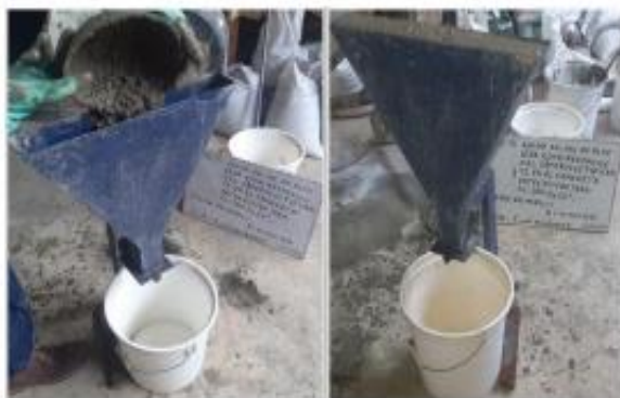
PRUEBA DE RELLENO / V-FUNNELL
