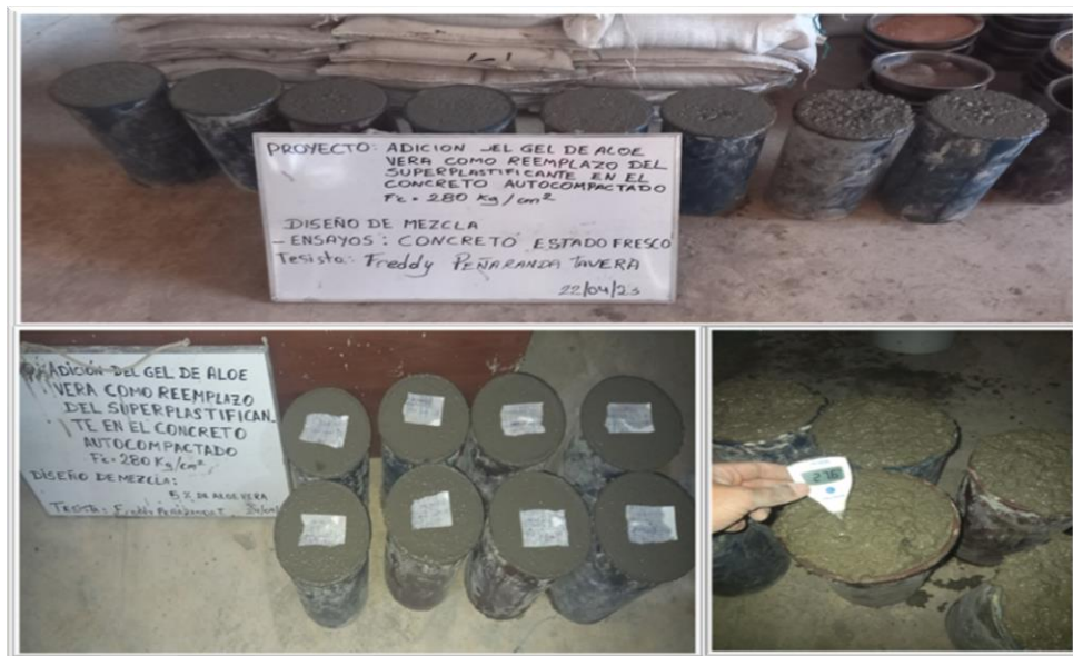
Figura 9. Visita al laboratorio, moldeo de probetas cilíndricas 6" x 12"
