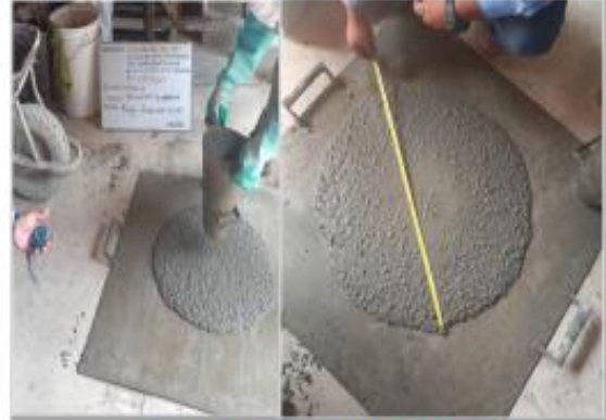
PRUEBA DE FLUJO DE ASENTAMIENTO
