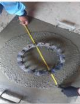
PRUEBA CAPACIDAD DE PASO / J- RING
