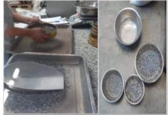
GRANULOMETRIA DE AGREGADO GRUESO
