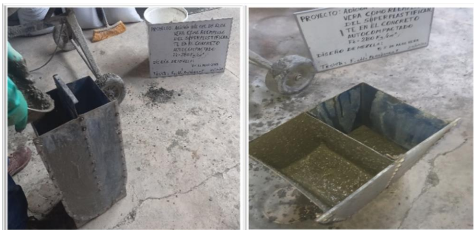
Figura 8. Visita al laboratorio, ensayo de habilidad de paso – Caja U.
