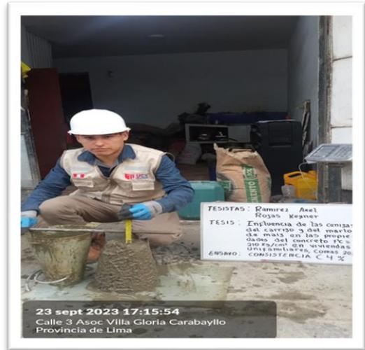
Ensayo de consistencia del concreto
