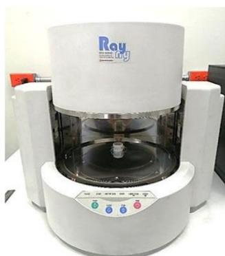
*Figura 19.* Espectrómetro de Fluorescencia de Rayos X de Energía Dispersiva (SHIMADZU, EDX-800HS).
