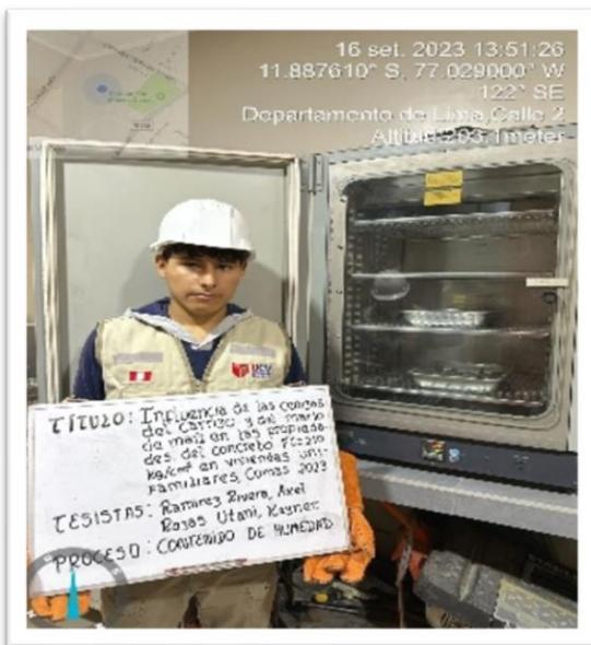
Secado en horno eléctrico – C.H.
