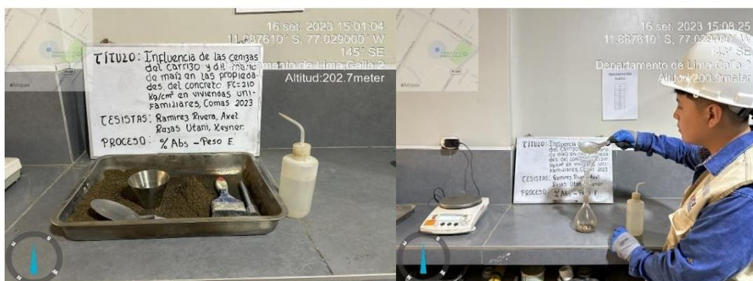
Figura 23. Ensayo % de absorción – Peso específico del agreco fino
