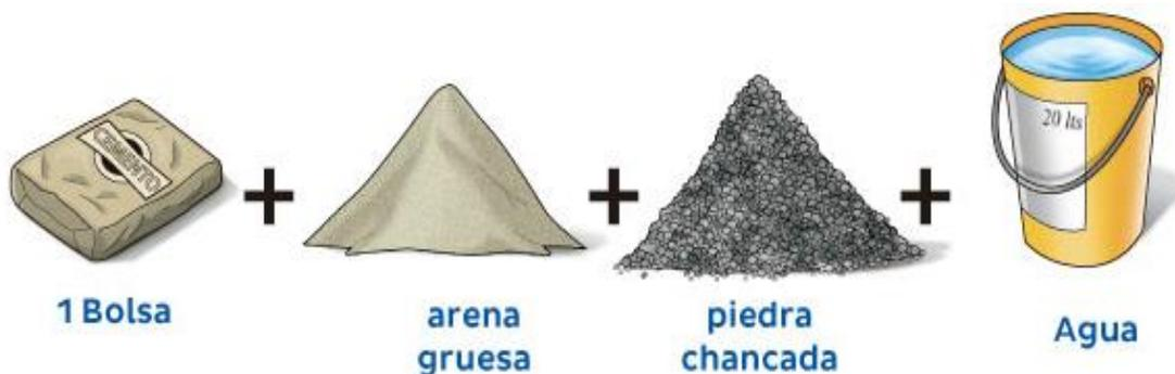
Figura 1. Componentes del concreto
