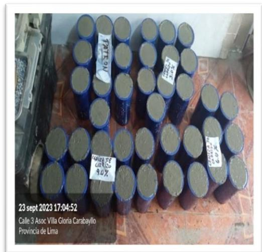
Secado de probetas de concreto
