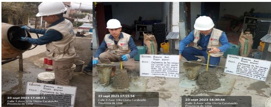
Figura 43. Ensayo de consistencia del concreto
