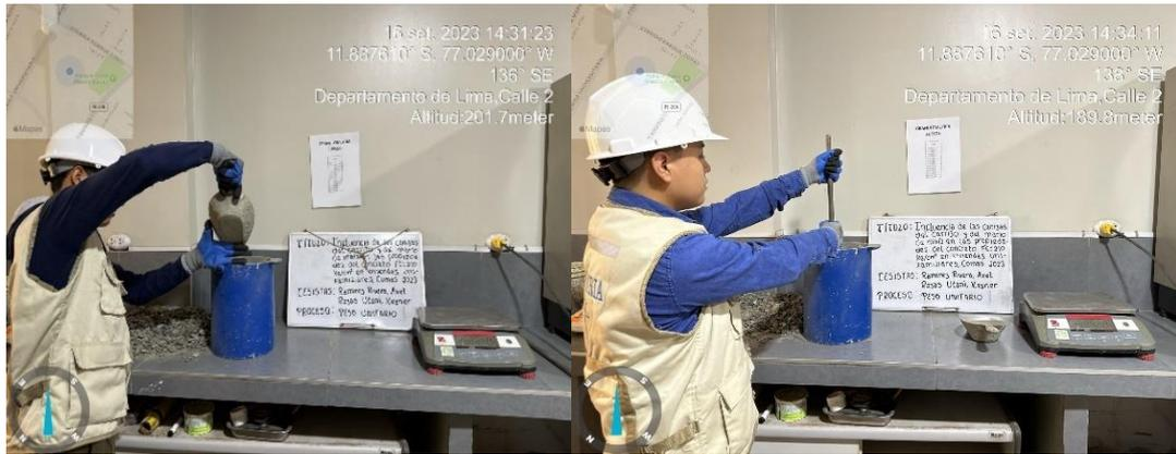
Figura 26. Ensayo peso unitario del agregado grueso
