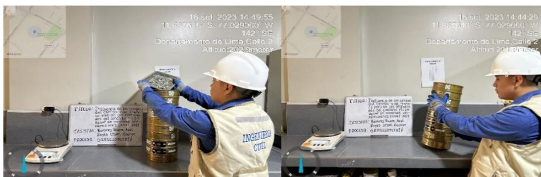
Figura 28. Ensayo granulométrico del agregado grueso - tamizado
