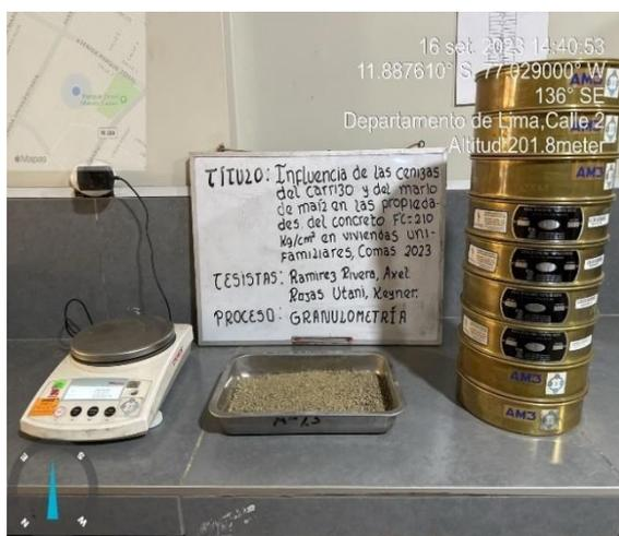
Figura 20. Ensayo granulométrico de A. F.
