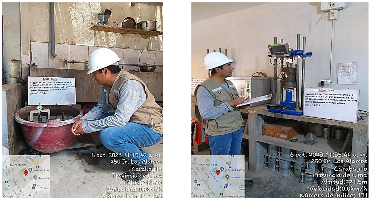
Figura 23. Ensayo del CBR con GRAVA.
