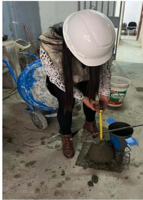
Figura N°21. Metodo del cono de Abraham para medir Slum.
