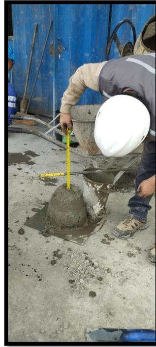
Prueba de consistencia (slump), medida del asentamiento de mezcla del concreto patrón del concreto 210 kg/cm<sup>2</sup>
