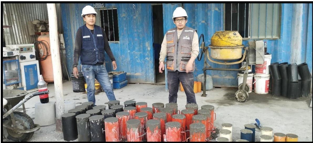
Probetas de concreto Patrón, con 2%MT, 5%MT y 8%MT
