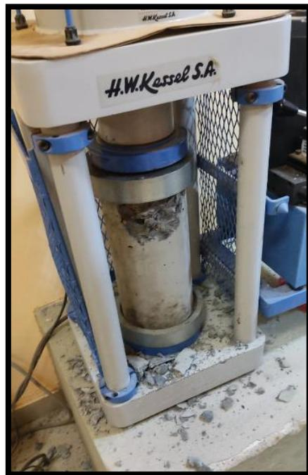
Probetas para ensayo de rotura de concreto patrón, con 2%MT, 5%MT y 8%MT después de los 7, 14 y 28 días de curado.
