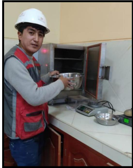
Ensayo de laboratorio para determinar el contenido humedad de los materiales
