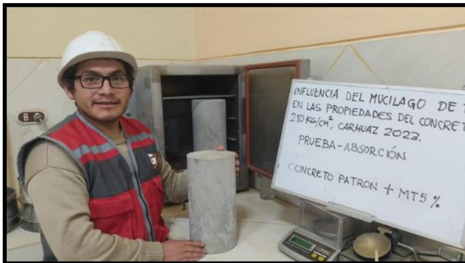
Probetas para ensayo de absorción de concreto patrón, con 2%MT, 5%MT y 8%MT después de los 28 días de curado.
