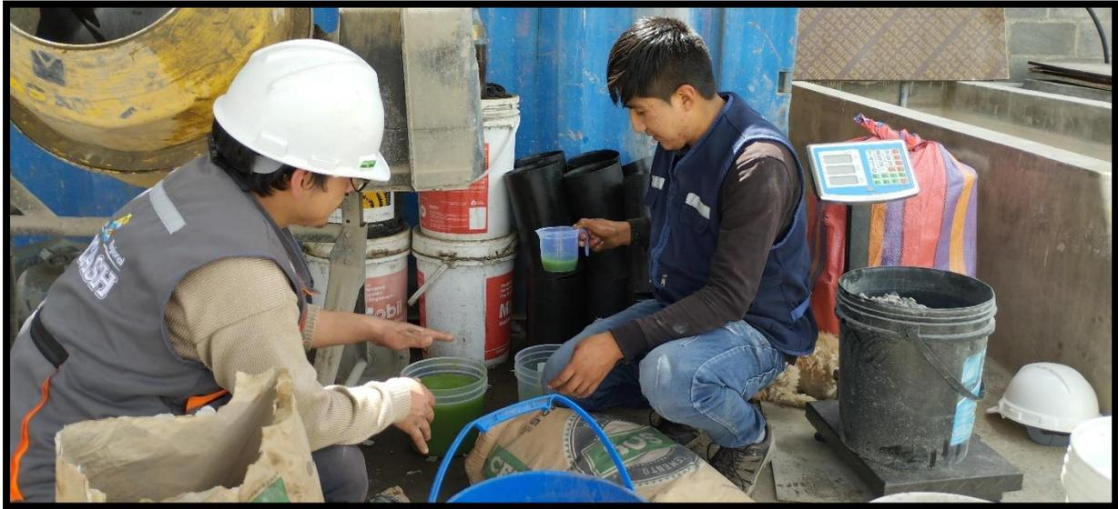
Medida del aditivo, mucílago de tuna al 2% para reemplazo del volumen de agua
