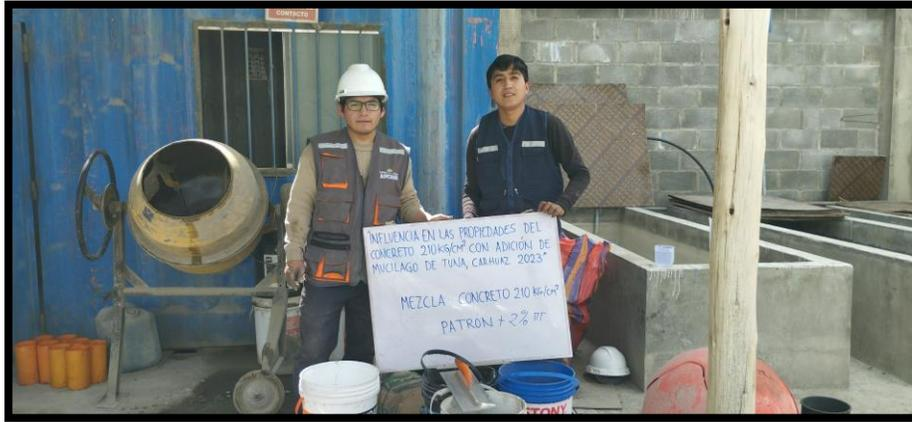
Mezcla del concreto con aditivo, mucílago de tuna con reemplazo del volumen de agua al 2%.
