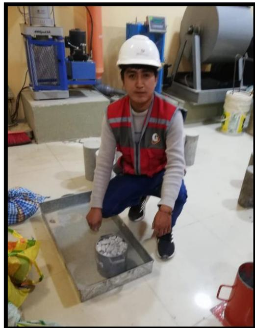
Ensayo de laboratorio para determinar el peso unitario de los materiales
