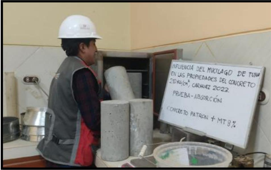
Probetas para ensayo de absorción de concreto patrón, con 2%MT, 5%MT y 8%MT después de los 28 días de curado.
