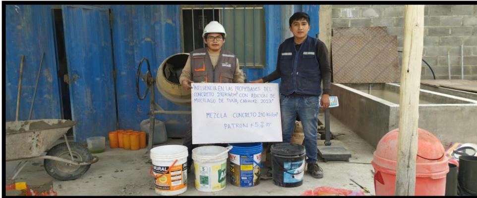
Mezcla del concreto con aditivo, mucílago de tuna con reemplazo del volumen de agua al 5%.
