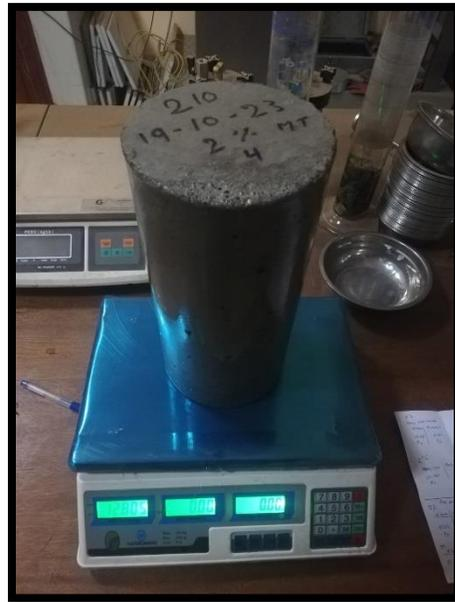
Pesado de las probetas húmedas después de 48 horas de remojo del concreto patrón, con 2%MT, 5%MT y 8%MT después de los 28 días de curado para la prueba de absorción
