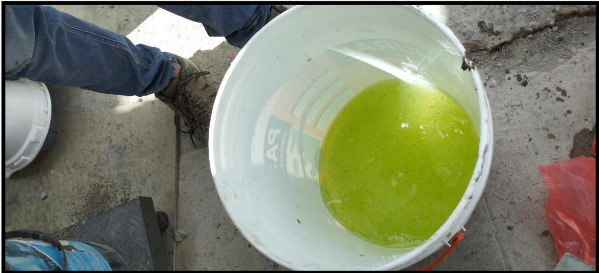
Mezcla del aditivo, mucílago de tuna al 2% para reemplazo del volumen de agua
