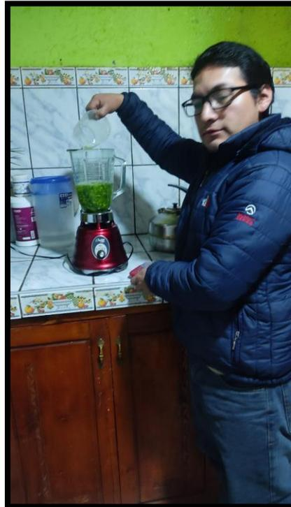
Proceso de licuado de los trozos de nopal de tuna después de 24 horas para obtención del mucilago
