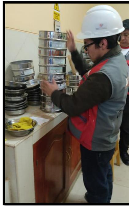
Ensayo de laboratorio para determinar la granulometría de los materiales (Agregado fino y agregado grueso)
