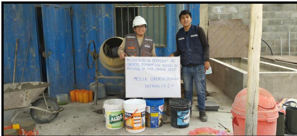
Mezcla del concreto con aditivo, mucílago de tuna con reemplazo del volumen de agua al 8%.
