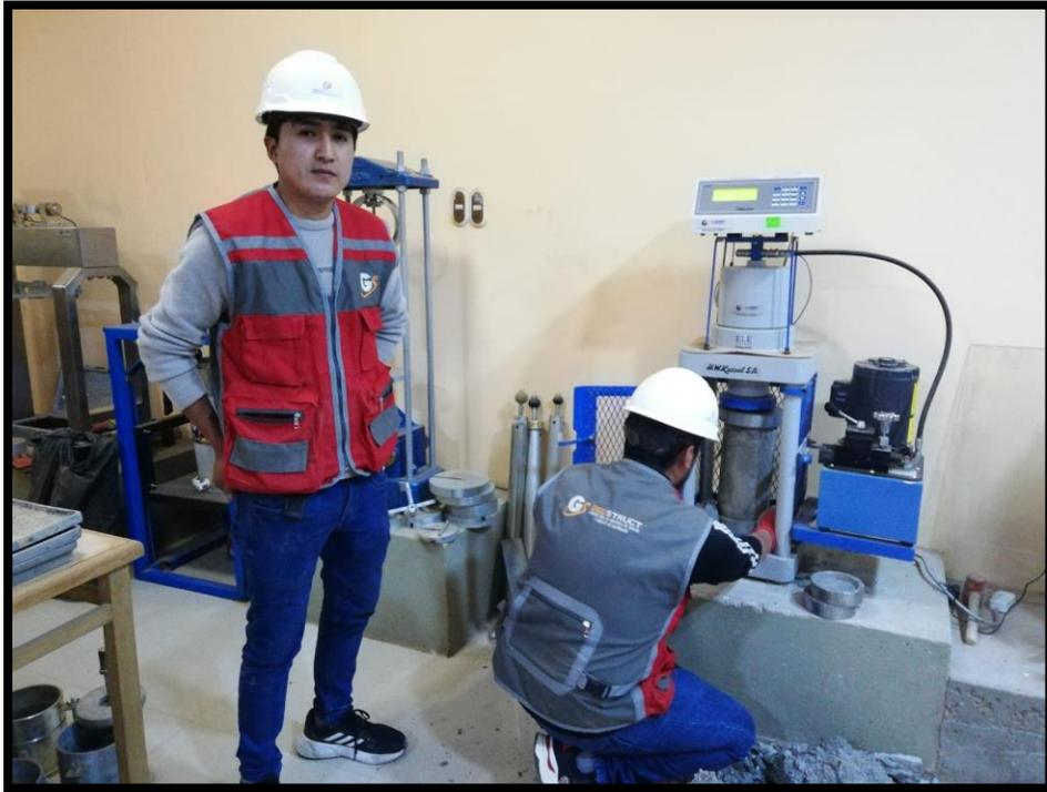
Probetas para ensayo de rotura de concreto patrón, con 2%MT, 5%MT y 8%MT después de los 7, 14 y 28 días de curado.
