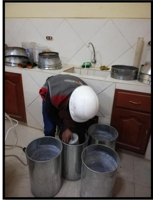
Colocación al remojo del concreto patrón, con 2%MT, 5%MT y 8%MT después de los 28 días de curado durante 48 horas para la prueba de absorción
