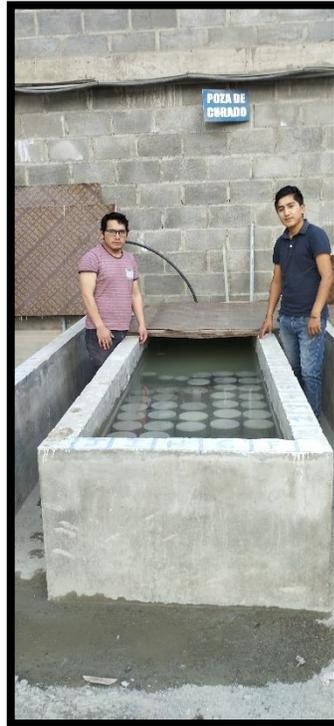
Colocación de probetas de concreto patrón, con 2%MT, 5%MT y 8%MT en la poza de curado.
