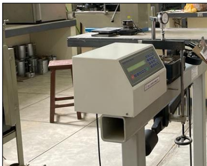
Ensayo de corte directo Fuente: Elaboración propia (2023)
