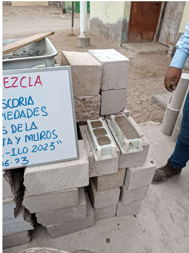
Fotografía 7: cubos de mortero.
