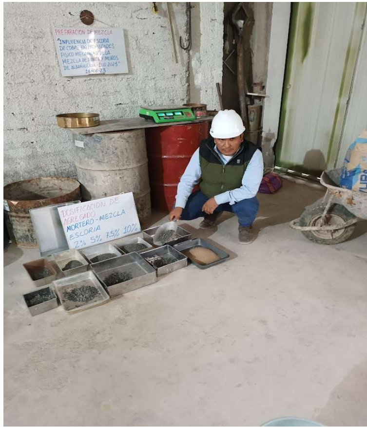
Fotografía 5: clasificación de materiales para elaborar unidades y mortero.
