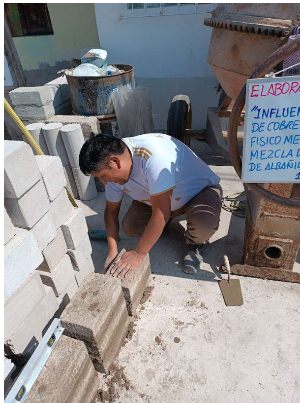
Fotografía 16: elaboración de pilas
