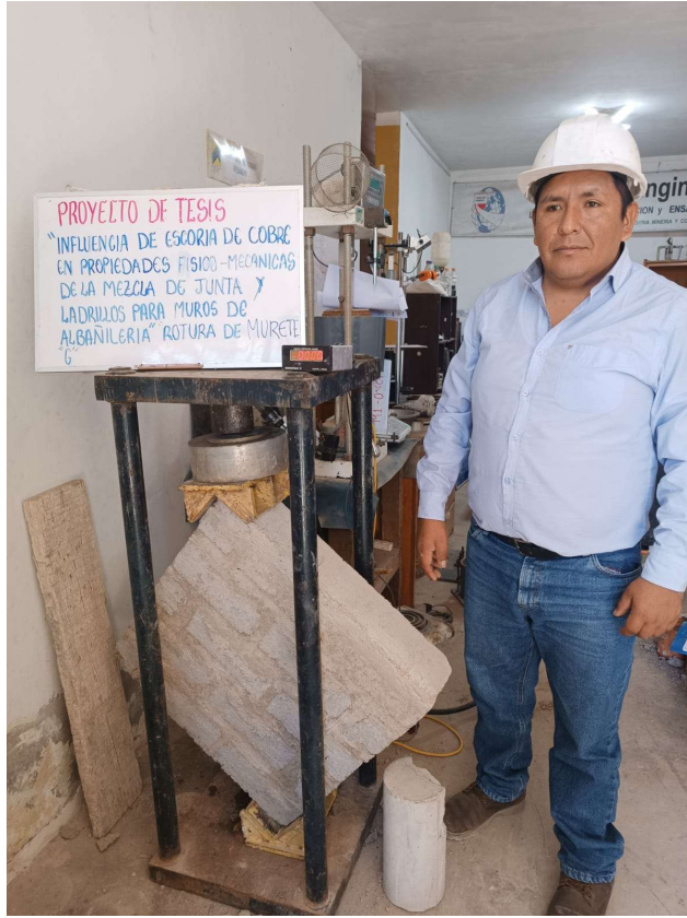
Fotografía 19: ensayo de rotura diagonal
