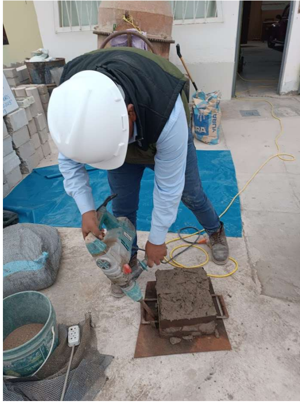
Fotografía 9: elaboración de unidades de albañilería con adición de escoria de cobre.
