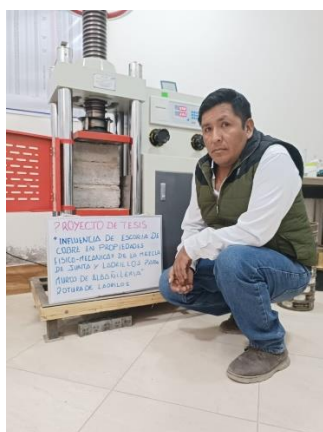
Figura 3. Compresión del mortero
