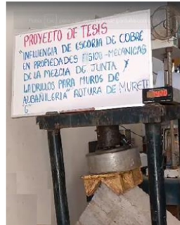
Falla por aplastamiento
