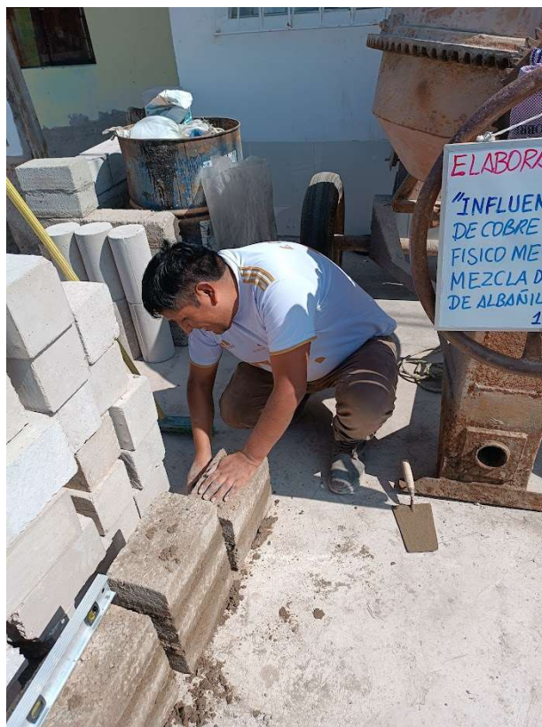
Fotografía 14: elaboración de pilas
