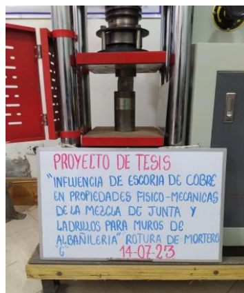
Figura 4. Dado de concreto a compresión
