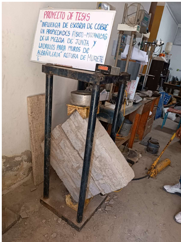
Fotografía 20: rotura de murete con unidades y mortero con adición de escoria de cobre
