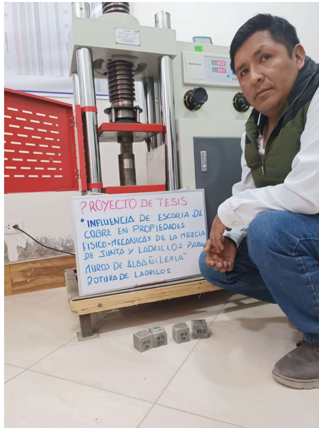
Fotografía 17: ensayos de rotura a los cubos GROUT.
