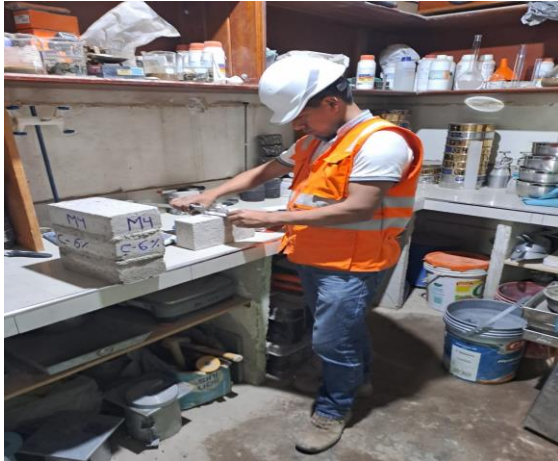
Fotografía N°43. Se toma las medidas de las unidades de albañería largo, ancho y alto.
