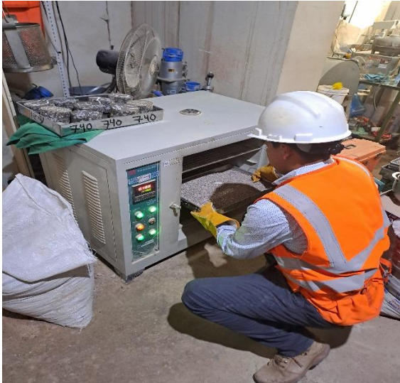
Fotografía N°07. Colocación al horno agregado fino
