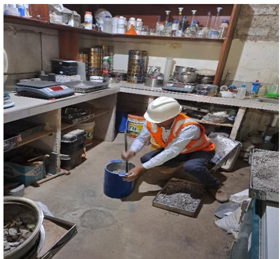
Fotografía N°24. Varillado del agredo grueso.
