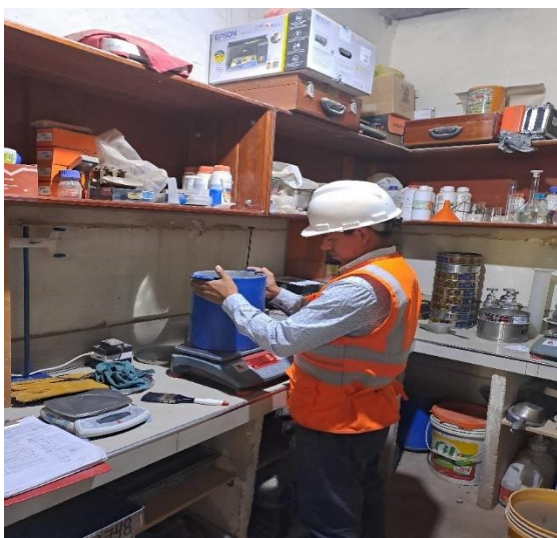
Fotografía N°17. Pesado de tara para peso unitario
