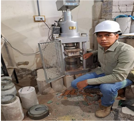
Fotografía N°49. Resistencia a tracción por flexión f'_{br} de la muestra M1
