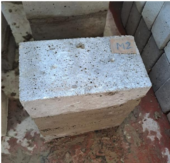
Fotografía N°39. Se realiza las pilas con tres unidades.
