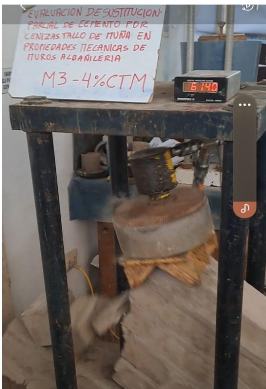
Fotografía N°57. Rotura de muretes con 4%CTM
