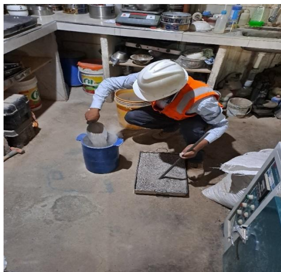
Fotografía N°18. Llenado de agregado al molde.
