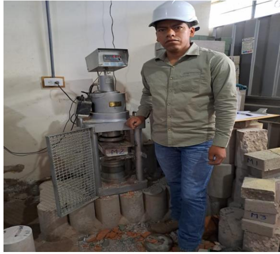
Fotografía N°50. Se realiza el ensayo de resistencia a tracción por flexión f'_{br} de la muestra M2.
