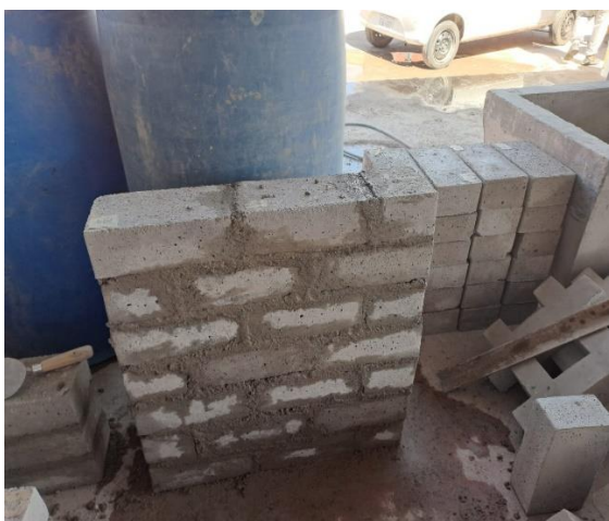
Fotografía N°41. Se realizo los muretes con 17 unidades
