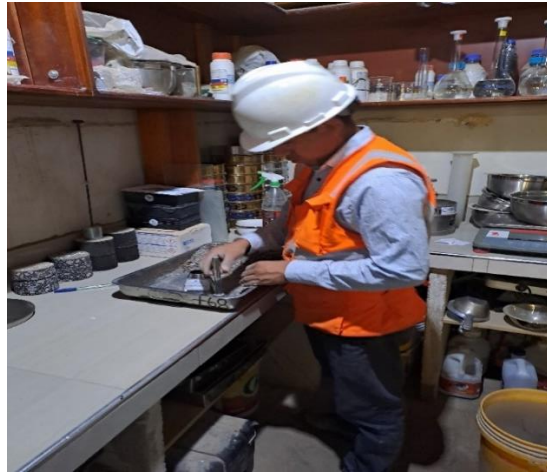
Fotografía N°26. Ensayo de estado superficialmente seco
