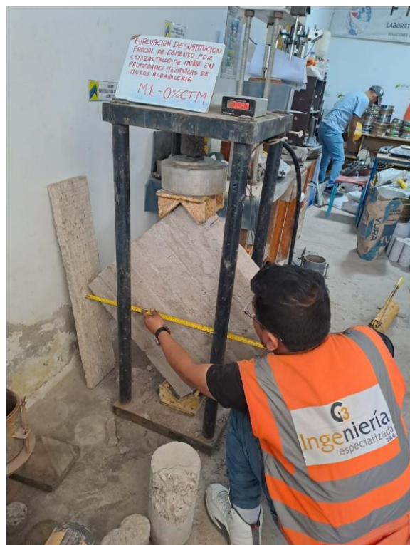
Fotografía N°58. Rotura de muretes, medición de la diagonal
