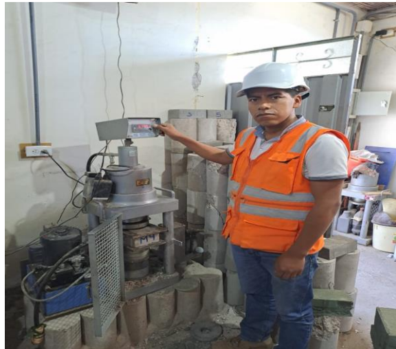
Fotografía N°46. Resistencia a la compresión axial f'_b de la muestra M4.
