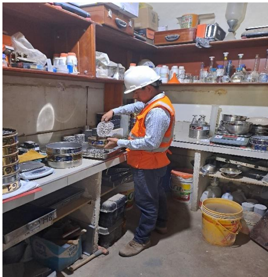
Fotografía N°15. Gradación por tamiz
