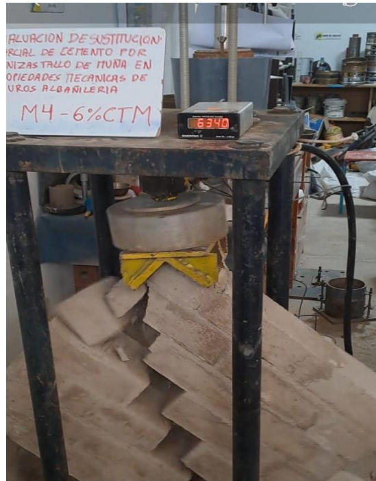
Fotografía N°56. Rotura de muretes con 6%CTM
