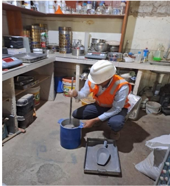
Fotografía N°20. Varillado 25 veces de dos de tres
