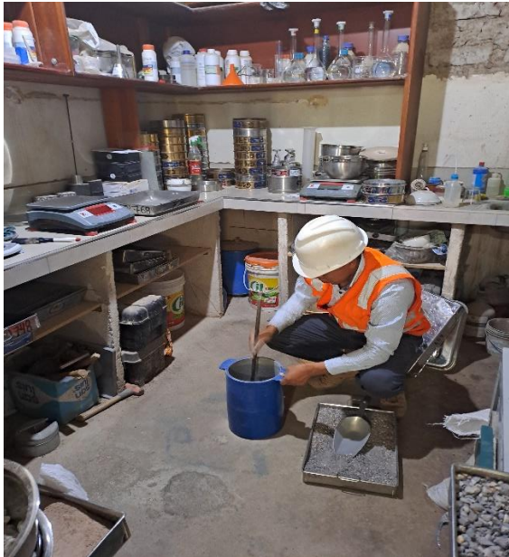
Fotografía N°19. Varillado de peso unitario
