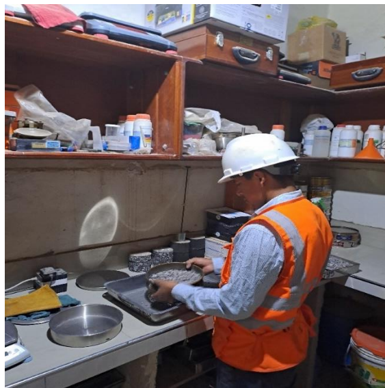
Fotografía N°16. Porcentaje retenido de agregado grueso
