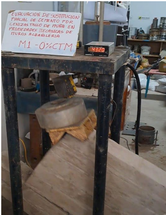
Fotografía N°55. Rotura de muretes, muestra patron
