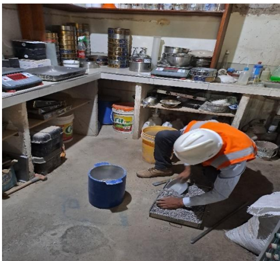
Fotografía N°23. Llenado del agregado grueso.
