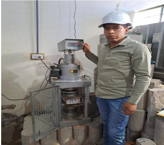
Fotografía N°51. Resistencia a tracción por flexión f'_{br} de la muestra M3.
