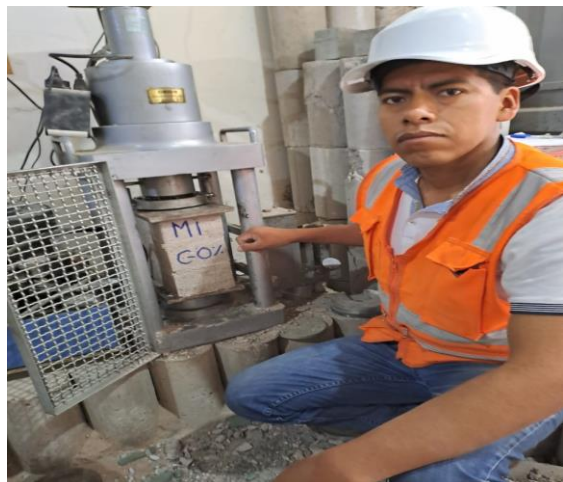
Fotografía N°48. Resistencia a la compresión axial de la muestra patrón M1.
