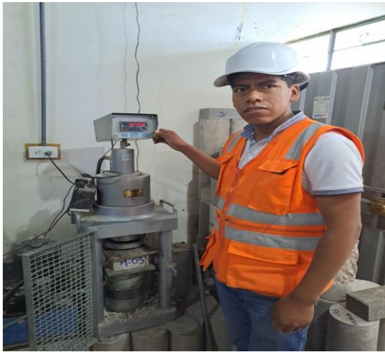
Fotografía N°45. Se realiza el ensayo resistencia a la compresión axila f'_b de la muestra M3.
