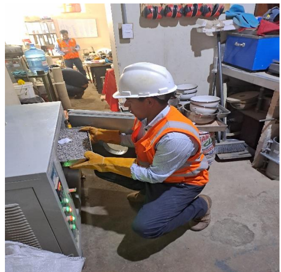
Fotografía N°06. Colocación al horno del agregado
