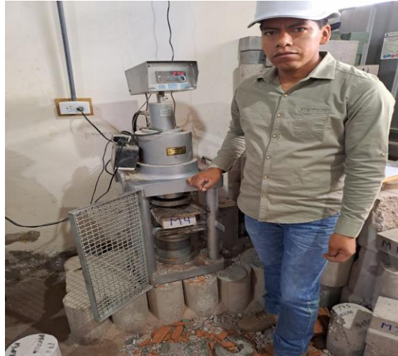
Fotografía N°52. Resistencia a tracción por flexión f'_{br} de la muestra M4.
