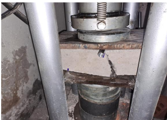
Fotografía N°53. Se aprecia ruptura una vez aplicada la carga axial en la unidad de albañilería.
