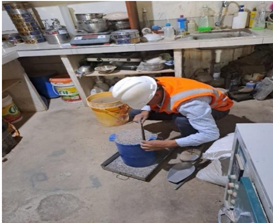
Fotografía N°21. Enrasado para el peso unitario.
