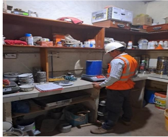
Fotografía N°22. Pesado molde más agregado
