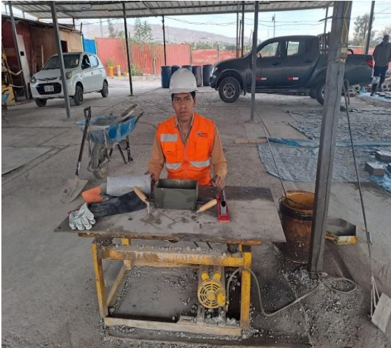
Fotografía N°31. Molde para realizar unidades albañilería
