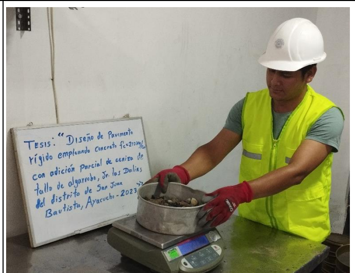
Fotografía 14: Pesado del agregado grueso para el % de humedad.
