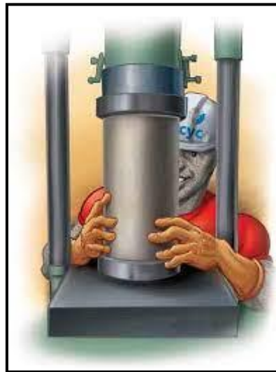
Figura 5: Ensayo de la resistencia a compresión del concreto
