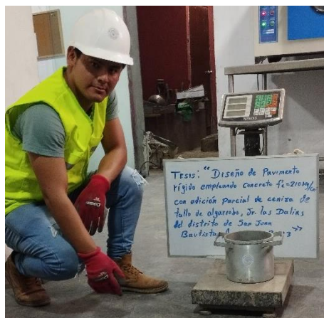
Fotografía 17: Peso unitario del agregado fino.
