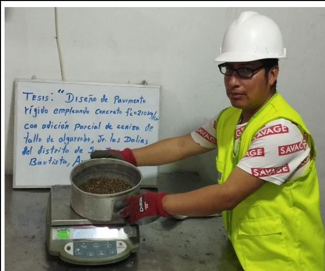
Fotografía 13: Pesado del agregado fino para el % de humedad.
