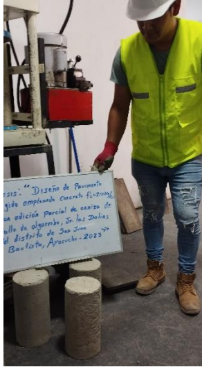
Fotografía 25: Probetas para el ensayo de compresión.
