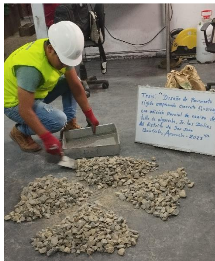
Fotografía 8: Cuarteo del agregado fino.
