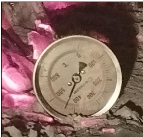
Fotografía 5: Temperatura de 440 °C en el termómetro de dial.
