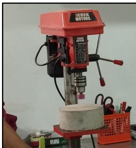
Figura 7: Ensayo de la resistencia a abrasión del concreto
