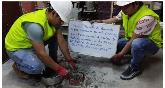
Fotografía 24: Elaboración de discos de concreto.
