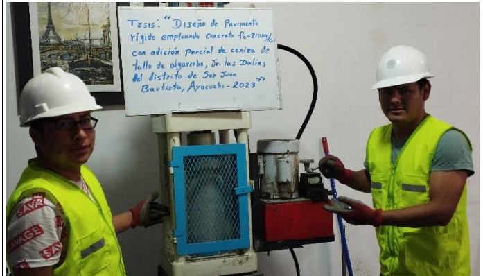
Fotografía 26: Ensayo de compresión del concreto 28 días.
