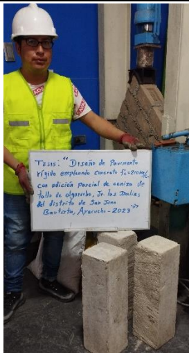
Fotografía 27: Viguetas para el ensayo de flexión.
