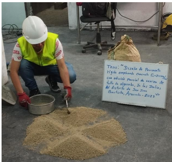
Fotografía 7: Cuarteo del agregado fino.
