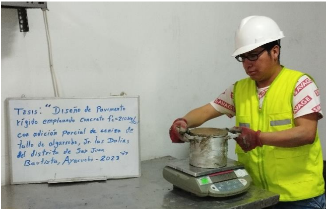
Fotografía 21: Peso unitario del concreto fresco.
