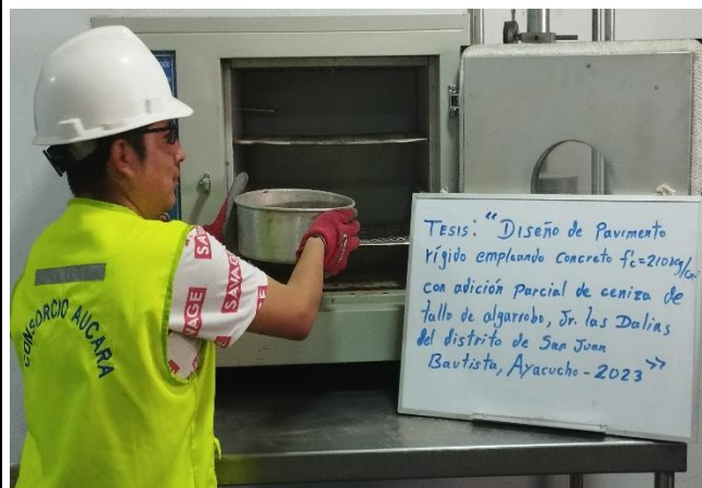
Fotografía 15: Colocación del agregado fino al horno industrial.
