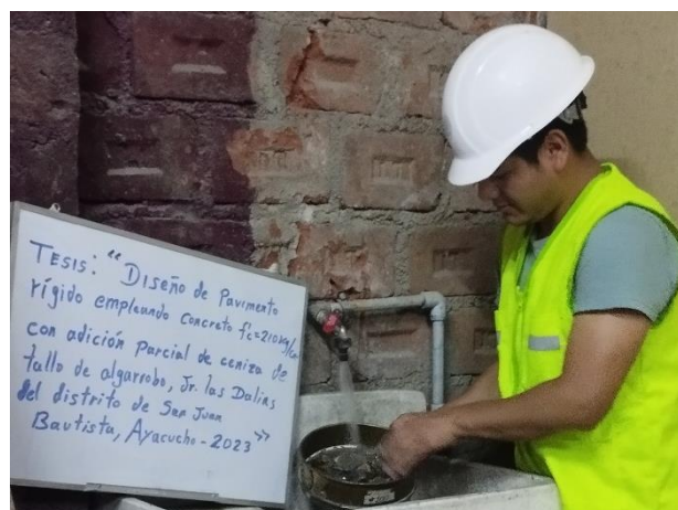
Fotografía 12: Lavado del agregado fino en la malla N° 4.
