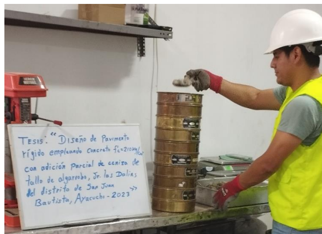
Fotografía 10: Ensayo de granulometría del agregado grueso.
