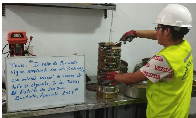
Fotografía 9: Ensayo de granulometría del agregado fino.
