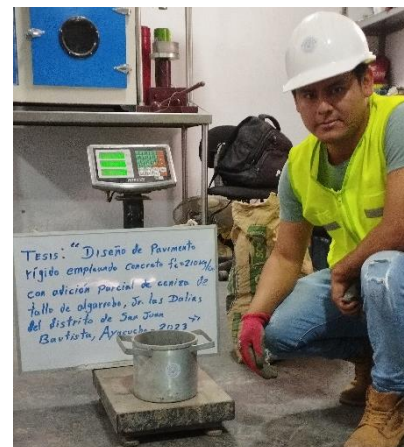
Fotografía 18: Peso unitario del agregado grueso.
