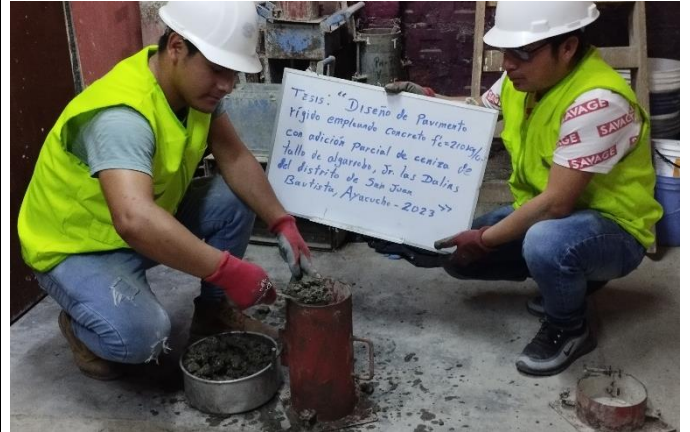
Fotografía 22: Elaboración de probetas de concreto.
