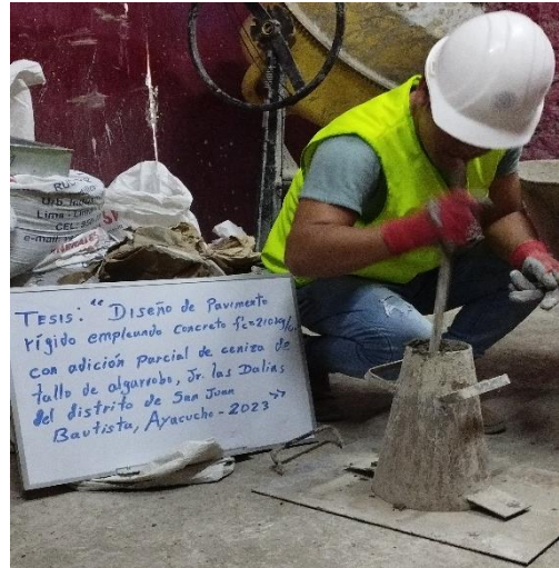
Fotografía 20: Asentamiento del concreto fresco.
