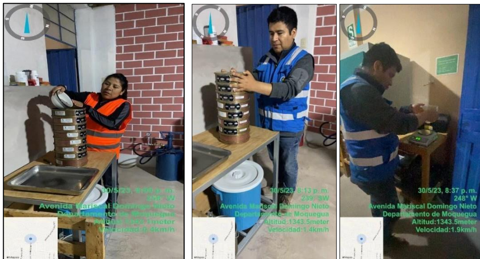
Figura 13. Ensayo granulométrico - arena gruesa
