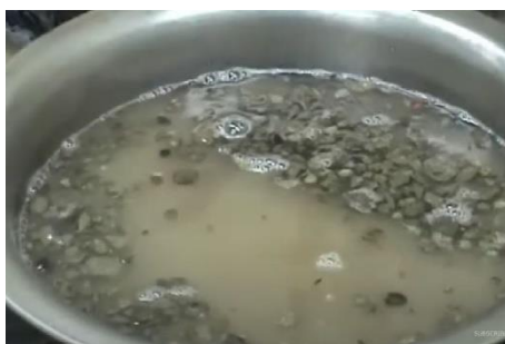
Figura 15. Prueba de partículas livianas en el agregado grueso .
