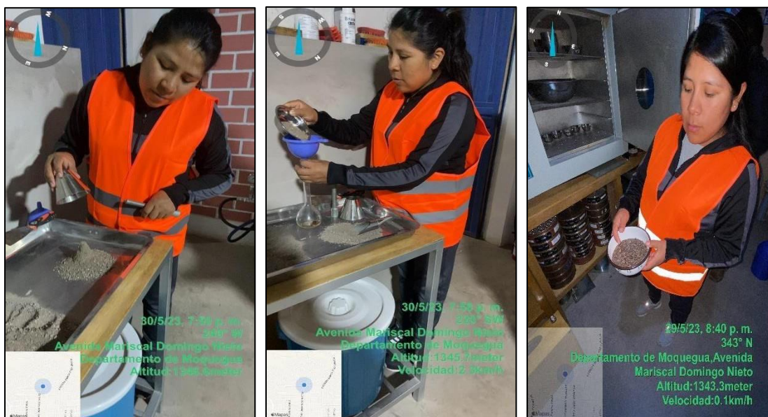
Figura 20. Prueba de peso específico de arena gruesa.
