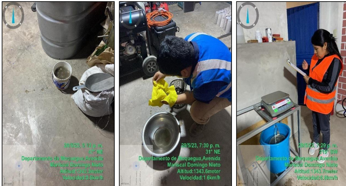
Figura 10. Prueba peso específico de piedra chancada.
