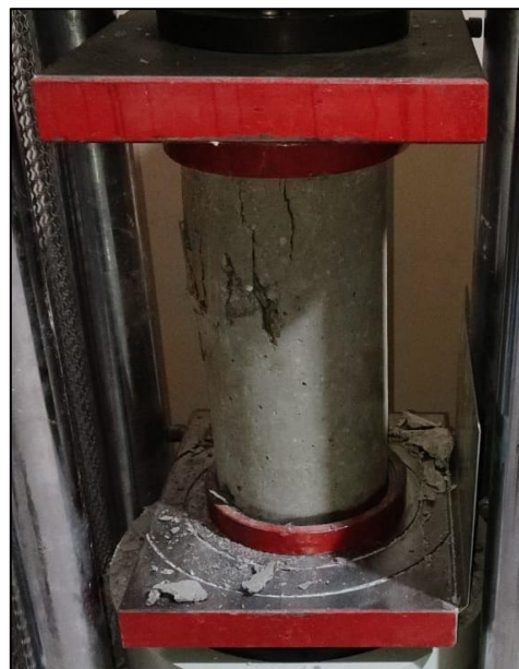
Figura 3. Prueba de resistencia a compresión.
