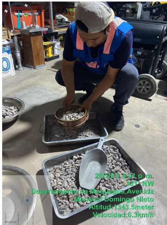
Fotografía 03. Tamizado de Agregado Fuente. Elaboración propia
