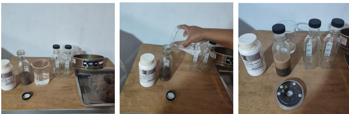
Figura 26. Impurezas orgánicas para la arena gruesa
