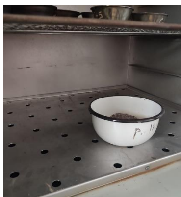
Figura 27. Impurezas orgánicas para la arena gruesa
