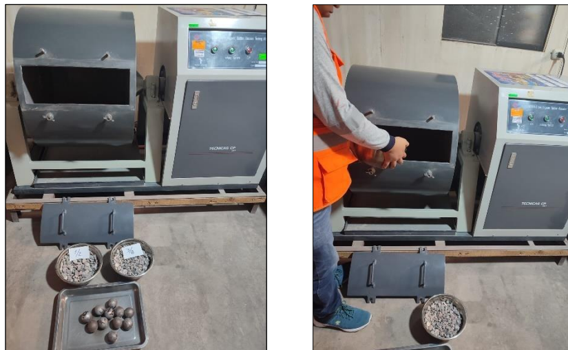
Figura 13. Ensayo de desgaste por abrasión
