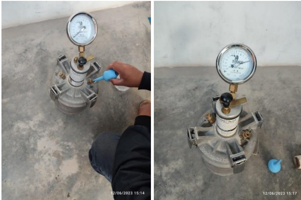
Figura 42. Contenido de aire de concreto fast-track.
