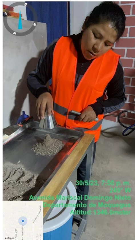
Fotografía 05. Ensayo de peso específico - arena gruesa Fuente. Elaboración propia
