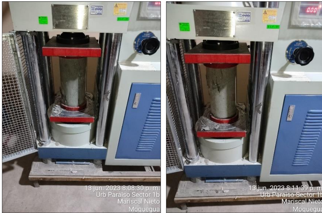
Figura 44. Resistencia a compresión de concreto fast-track
