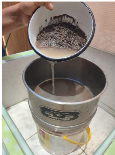
Figura 25. Material pasante el tamiz de N°200 - arena gruesa
