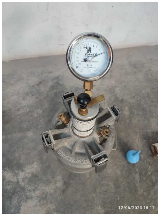
Fotografía 08. Ensayo de contenido de aire Fuente. Elaboración propia
