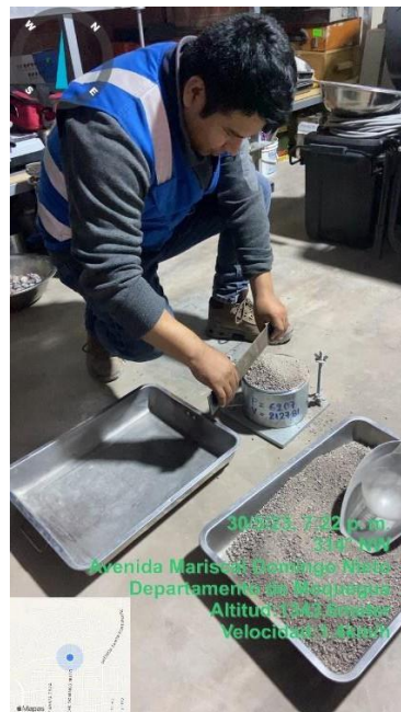
Fotografía 06. Ensayo de peso unitario - arena gruesa Fuente. Elaboración propia
