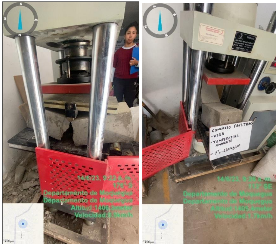
Figura 46. Resistencia a flexión del concreto fast-track.
