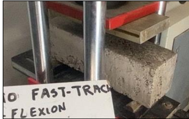
Figura 4. Prueba de resistencia a flexion.
