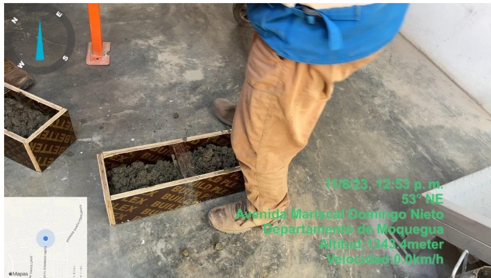
Fotografía 10. Elaboración de vigas para la resistencia a la flexión Fuente. Elaboración propia
