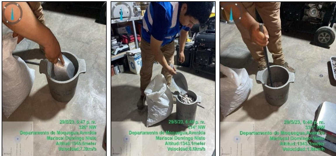
Figura 11. Prueba de peso unitario de piedra chancada.
