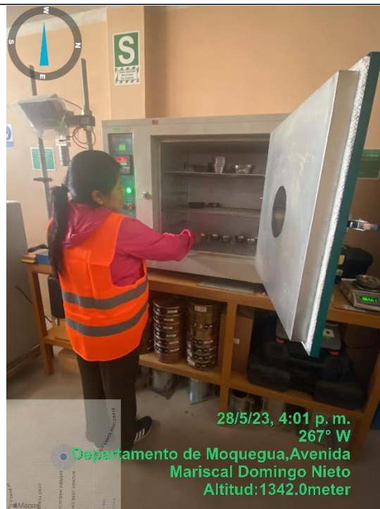
Fotografía 04. Secado de agregados en horno Fuente. Elaboración propia
