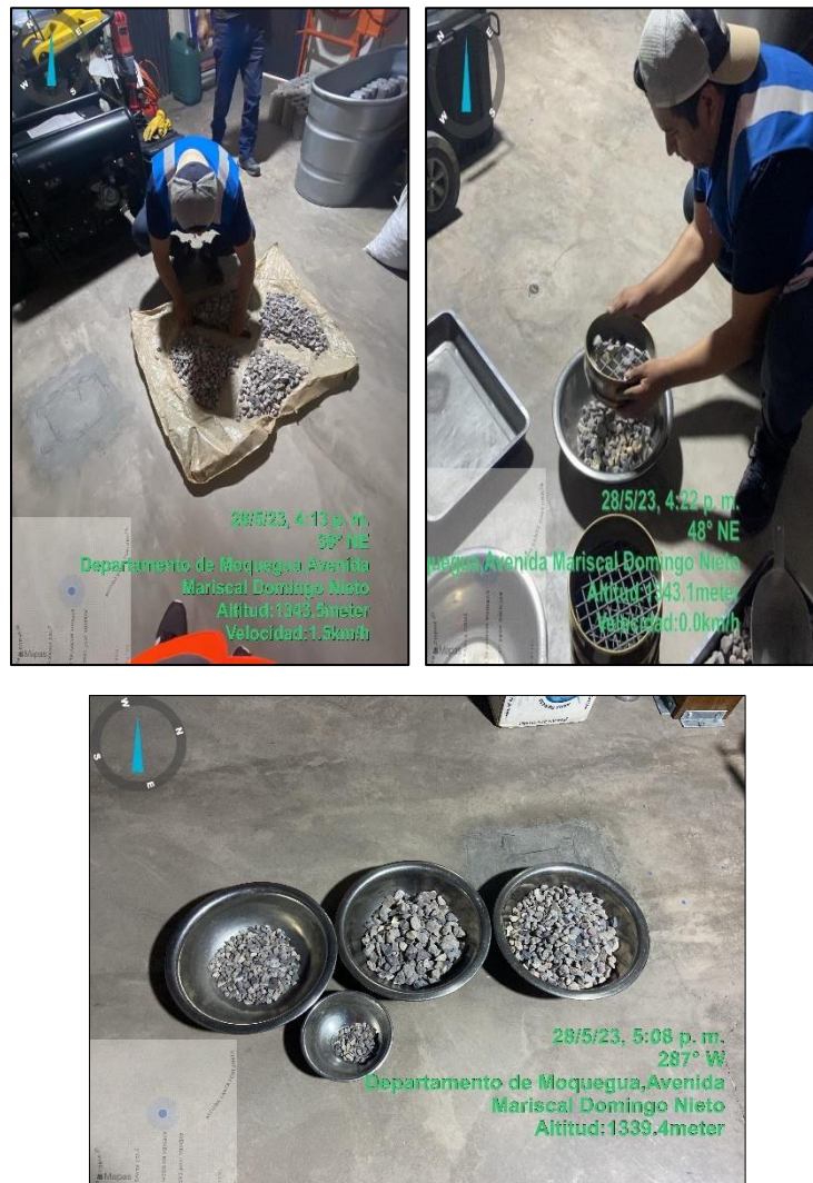
Figura 9. Pruebas de tamaño de partículas de piedra triturada
