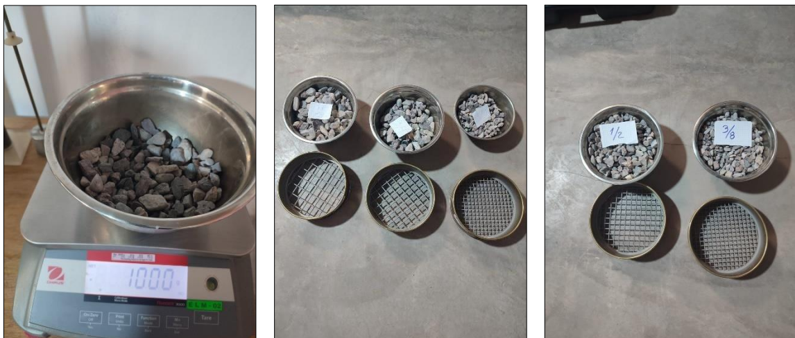
Figura 14. Ensayo de terrones de arcilla y partículas deleznales.
