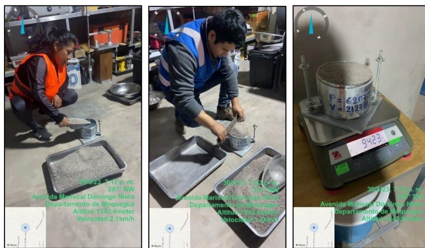
Figura 14. Ensayo del peso unitario de arena gruesa.
