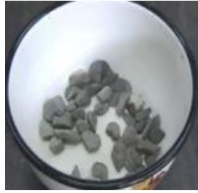
Figura 16. Prueba de partículas fracturadas en agregado grueso.
