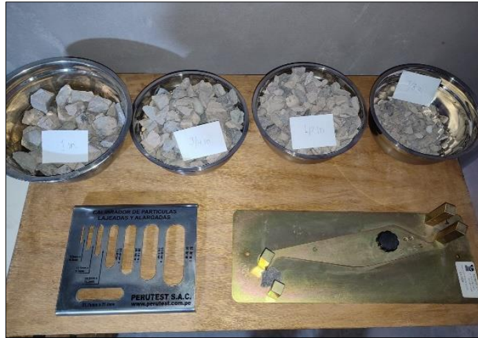
Figura 17. Ensayo de partículas planas y alargadas - agregado grueso.
