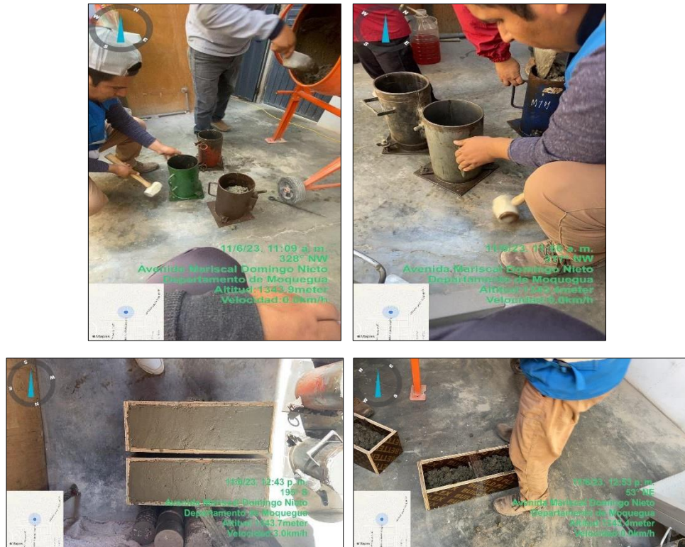
Figura 32. Fabricación de probetas y vigas de concreto.
