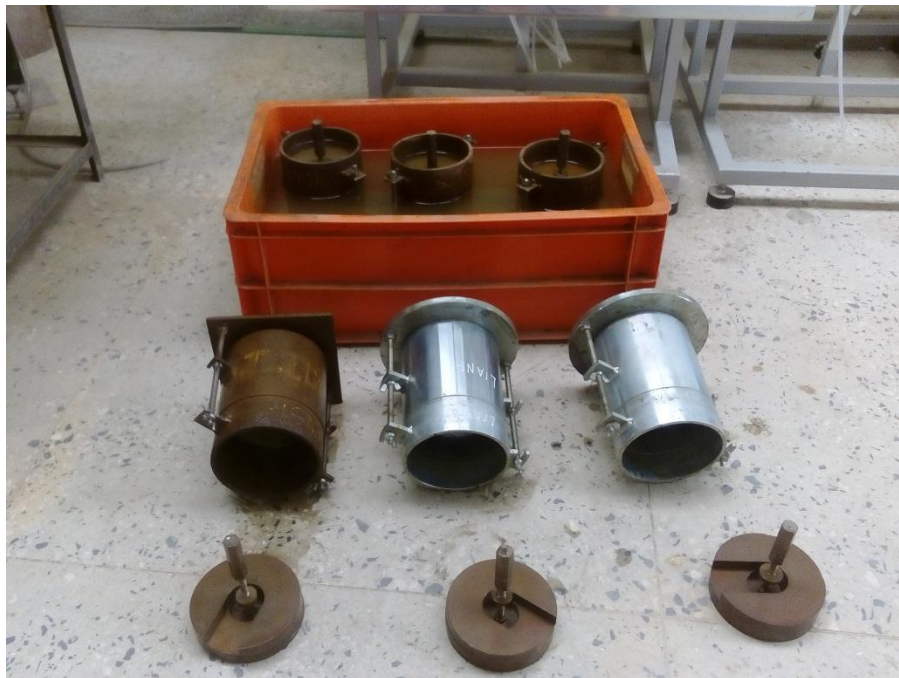
FOTO 16: Colocación de las muestras de CBR en forma horizontal durante 15 min para luego ser realizado el ensayo de penetración.
