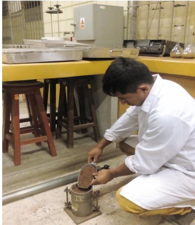
FOTO 13: En la imagen se aprecia agregando la última capa de muestra de suelo en el molde de 4 pulg. Del ensayo de proctor modificado.
