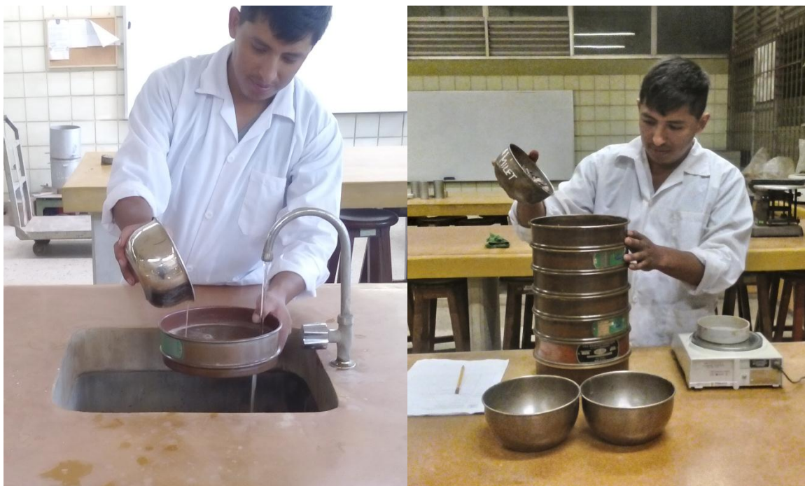
FOTO 8: Realizando los ensayos granulométricos del suelo natural.
