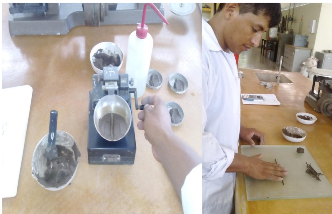
FOTO 10: Realizando los ensayos de límite líquido y límite plástico.
