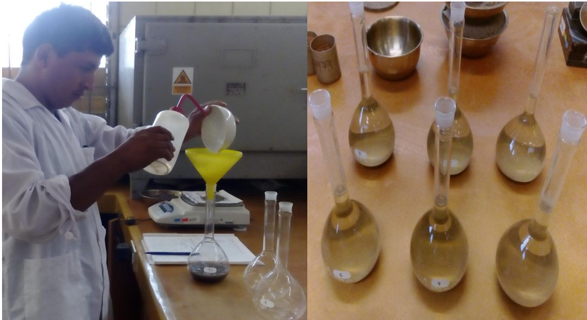
FOTO 11: Realizando el ensayo del peso específico de todas las muestras combinadas con las proporciones de escoria, pasante por la malla n° 4.
