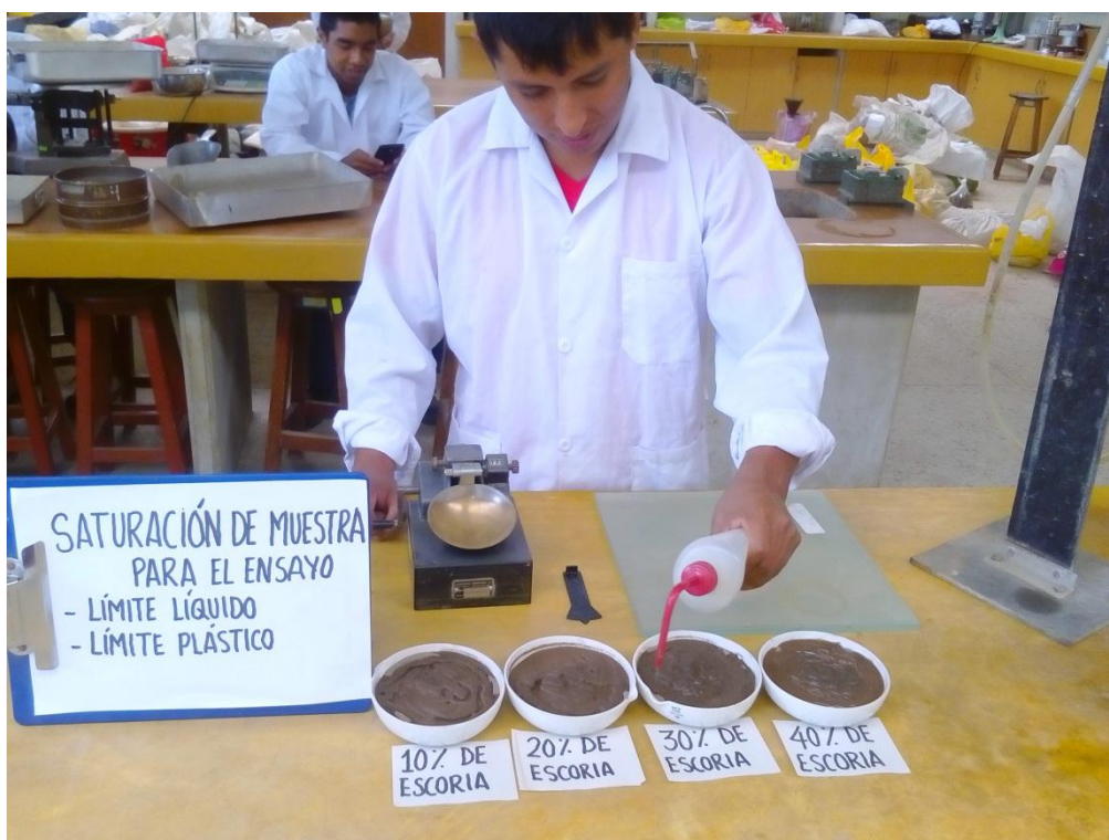
FOTO 9: Saturación de la muestra combinado con las proporciones de escoria para límite líquido y límite plástico pasante por la malla n° 40.
