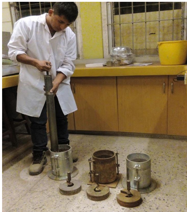
FOTO 14: Realizando la compactación del ensayo CBR
