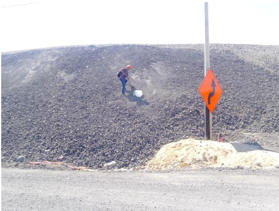
FOTO 01: Vista panorámica del muestreo representativo de la escoria de acería de horno eléctrico.
