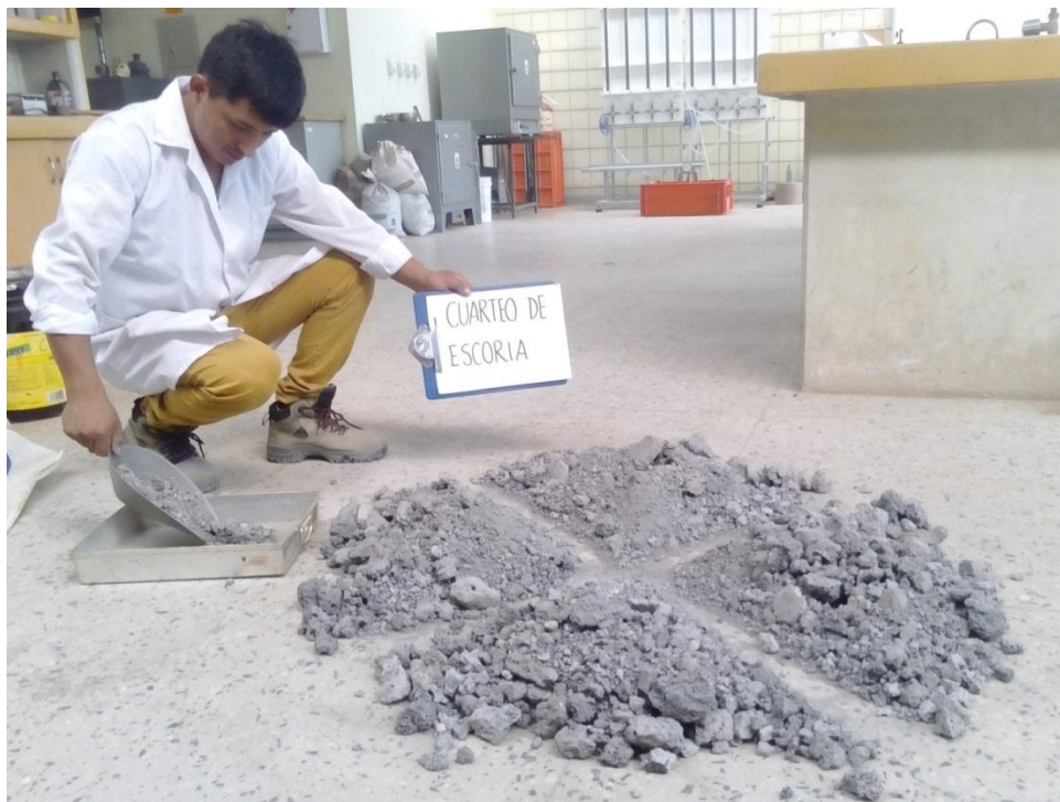
FOTO 6: Realizando el cuarteo de la escoria para obtener una muestra representativa.
