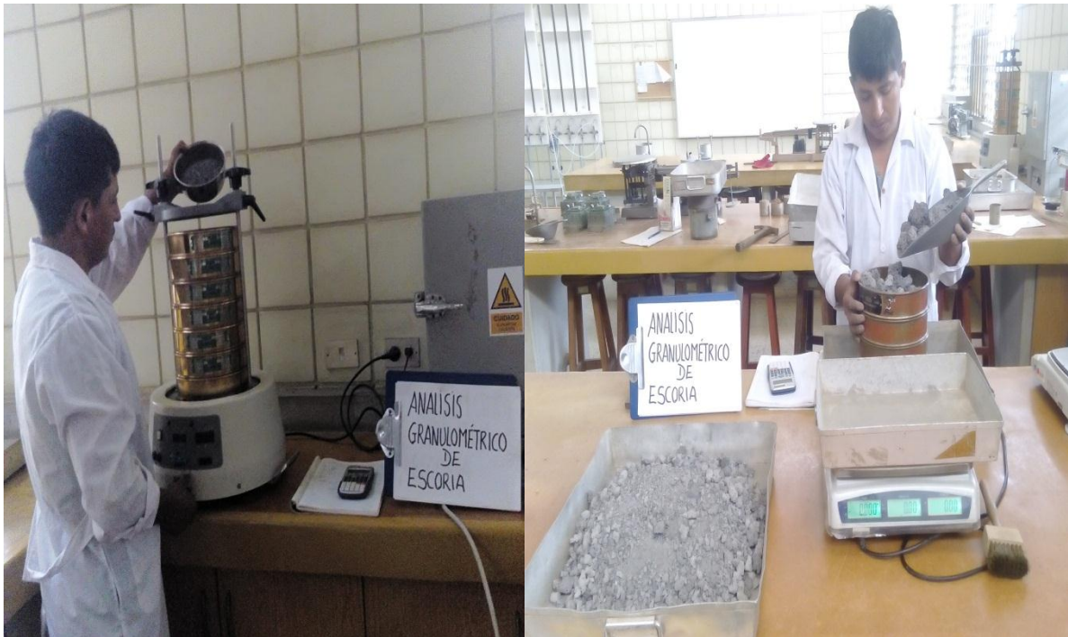
FOTO 7: Realizando los ensayos granulométricos de la escoria, fracción grueso y fracción fino.
