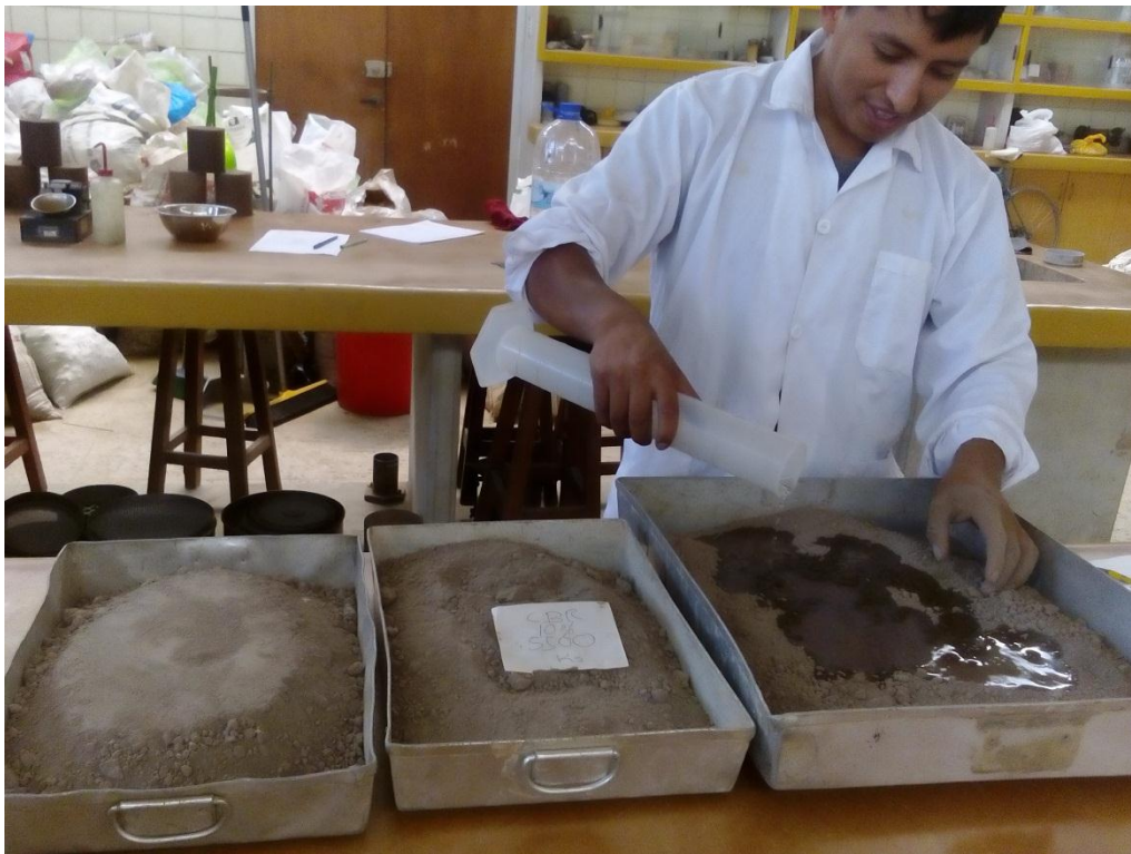
FOTO 12: Mezcla de las muestras de suelo con un porcentaje de agua para realizar el proctor modificado.
