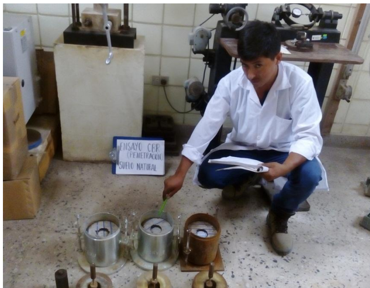
FOTO 18: Muestras ensayadas después de la penetración de CBR.
