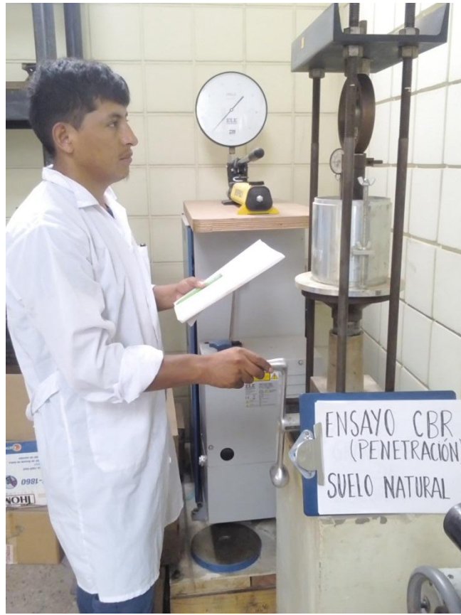
FOTO 17: Realizando el ensayo de penetración.
