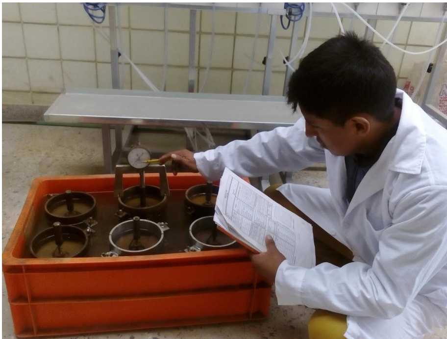
FOTO 15: En la imagen se aprecia la saturación de las muestras y la lectura de la expansión del CBR.
