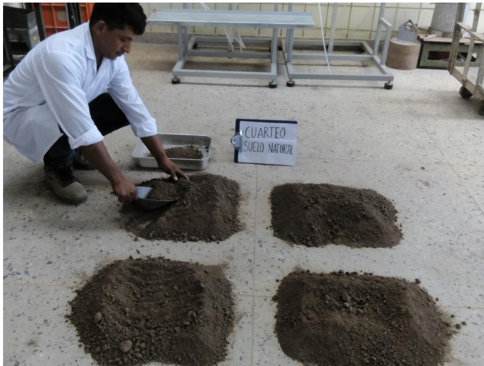
FOTO 5: Cuarteo del suelo natural para obtener una muestra representativa y realizar los ensayos respectivos.
