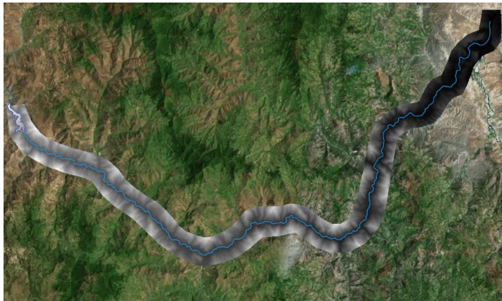
Figura 7. DEM procesado en QGIS, a lo largo del eje del cauce.
