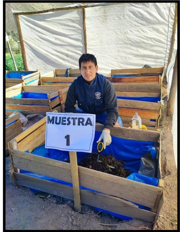
**Figura 15.** Primera muestra del compost y medición de la temperatura
