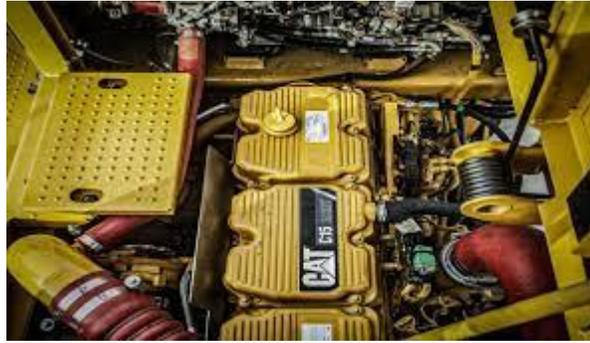
Figura 9: Motor de una excavadora hidráulica Caterpillar 374F.
