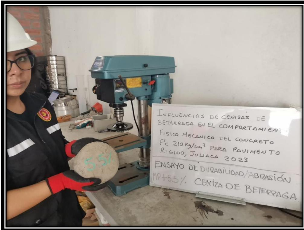
Figura: Ensayo de Durabilidad/Abraición en Muestra con adición de cenizas de beterraga (MP + 2.0%).
