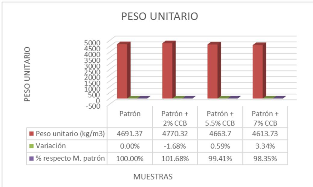
Se observa la tabla 16 y fig. 24 el dato del diseño patrón del concreto es 4691.37 kg/m<sup>3</sup>, al adicionar el 2% CC de betarraga se obtuvo un promedio de 4770.32 kg/m<sup>3</sup>, adicionando 5.5% de cenizas de cascara de betarraga se determina 4663.7 kg/m<sup>3</sup>, con una adición de 7% de CC de betarraga se obtiene 4613.73 kg/m<sup>3</sup> en base al peso unitario obtenido.
