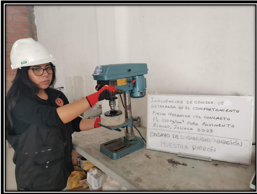
**Figura: Ensayo de Durabilidad/Abrasión en Muestra con adición de cenizas de beterraga (MP + 7.0%).**
