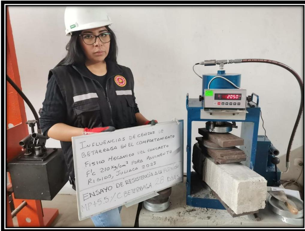
Figura: Ensayo de resistencia a flexión en Muestra con adición de cenizas de beterraga (MP + 2.0%) a los 28 días.
