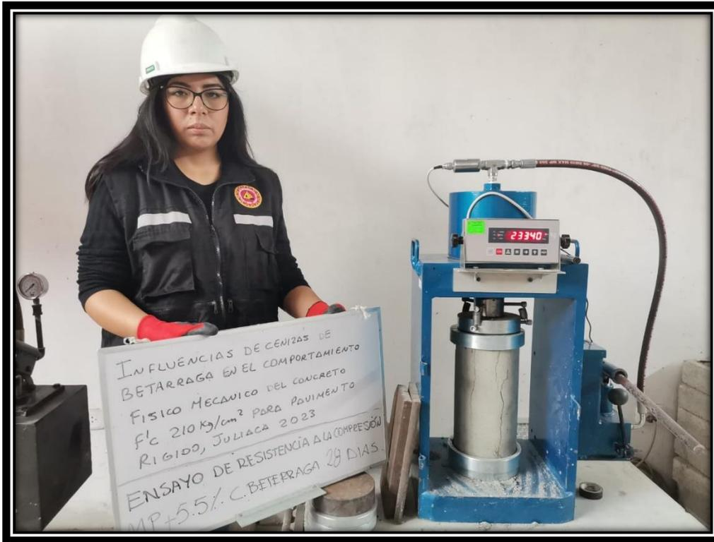
Figura: Ensayo de resistencia a la compresión en muestras con adición de cenizas de beterraga (MP + 7.0%) a los 28 días.
