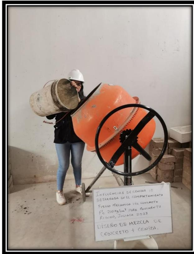
**Figura: Adición de cenizas de beterraga en el proceso de Elaboración de Pasta de Concreto para los ensayos.**
