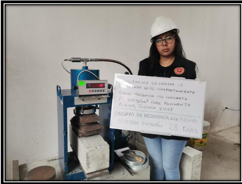
Figura: Ensayo de resistencia a flexión en Muestra con adición de cenizas de beterraga (MP + 7.0%) a los 28 días.
