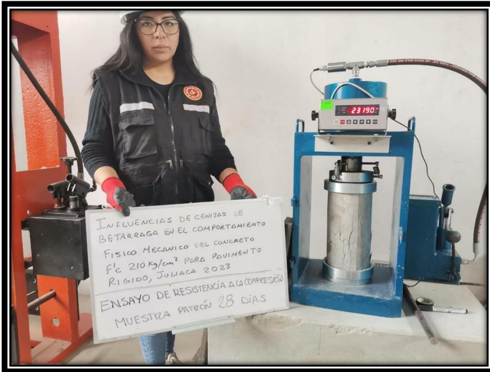
Figura: Ensayo de resistencia a la compresión en muestras con adición de cenizas de beterraga (MP + 2%) a los 28 días.
