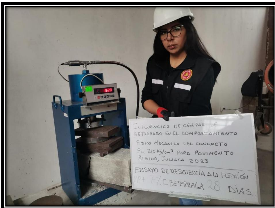
Figura: Ensayo de resistencia a flexión en Muestra con adición de cenizas de beterraga (MP + 5.5%) a los 28 días.
