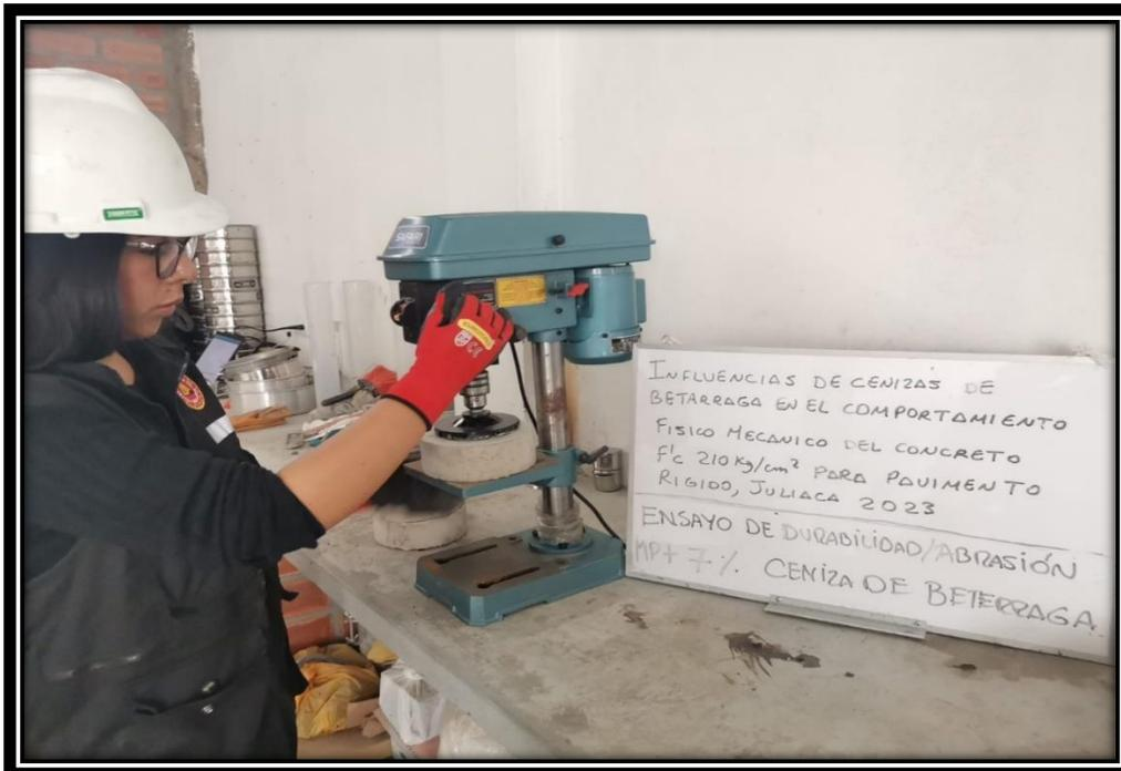
**Figura: Ensayo de Durabilidad/Abrasión en Muestra con adición de cenizas de beterraga (MP + 5.5%).**
