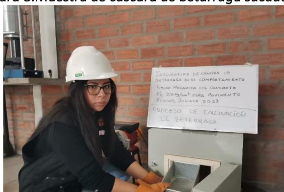
Una vez obtenida la ceniza de cascará de betarraga es tamizada para poder separar cualquier cualquier otro elemento que pueda haberse mezclado en el proceso y se toma una muestra representativa para un ensayo químico que nos ayude a obtenemos los resultados químicos de las cenizas de CCB y así saber las
