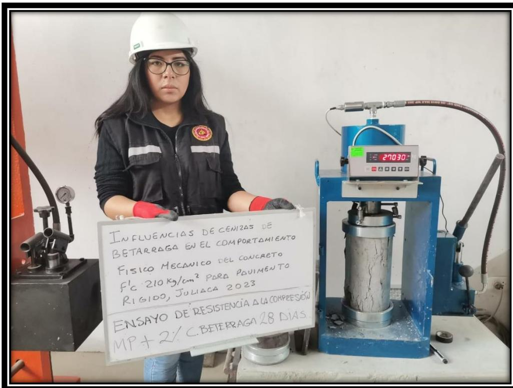
Figura: Ensayo de resistencia a la compresión en muestras con adición de cenizas de beterraga (MP + 5.5%) a los 28 días.
