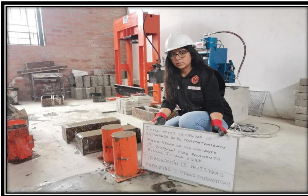
**Figura: Ensayo de resistencia a la compresión en muestras patrón (MP + 0%) a los 28 días.**
