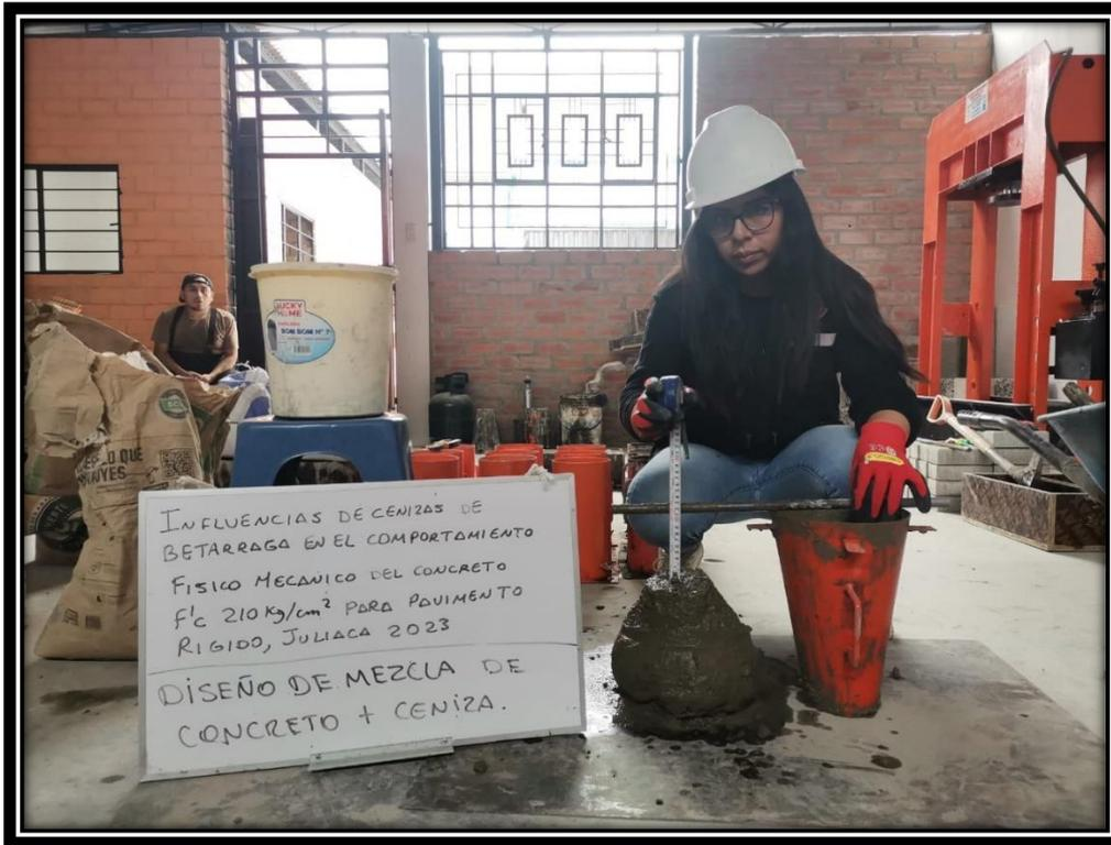
**Figura: Elaboración de muestras en Probetas y Vigas Prismáticas para los ensayos de resistencia a compresión y flexión.**
