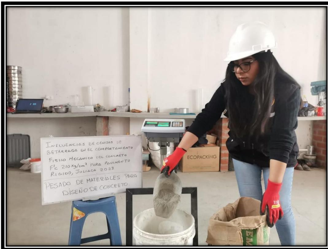
Figura: Pesado de Agregados para el Diseño de Mezclas de concreto.
