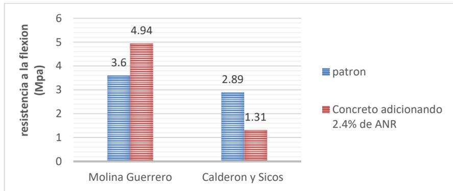
*Figura 37. valores de esfuerzos a la flexión del concreto, adicionando, 2.4% de ANR con respecto al patrón.*
