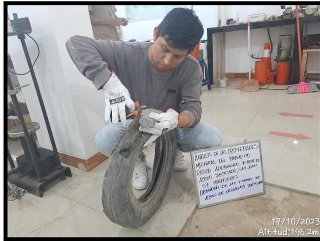
**Figura 28.** Separación del caucho del acero.
