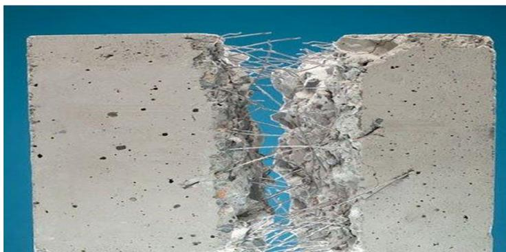
**Figura 20.** Fibras de acero rectos, en concreto endurecido
