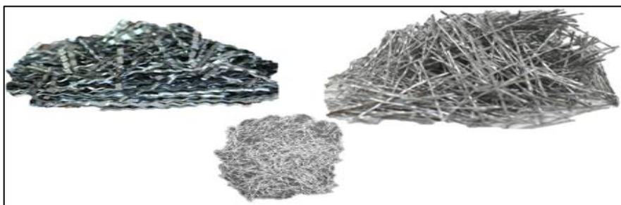
Figura 19. Tipos de fibras de acero
