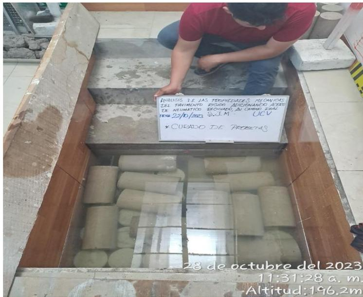
Curado de probetas
