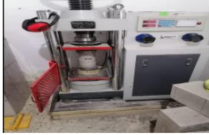
Figura 1 Ensayo a compresión
