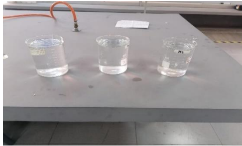
Figura 2. Se disolvió Cromo VI en jarras de 500 ml de agua destilada
