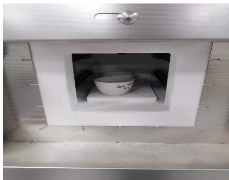
Figura 7. Carbonizado de pepa de aceituna en horno mufla
