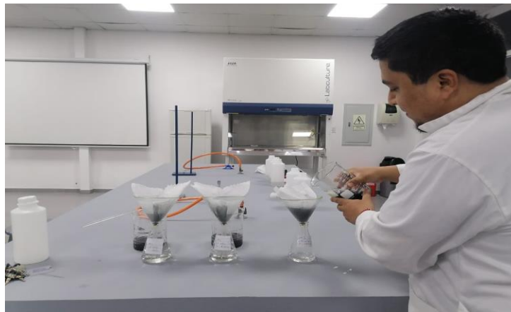
Figura 10. Separación por filtración en matraz Erlenmeyer
