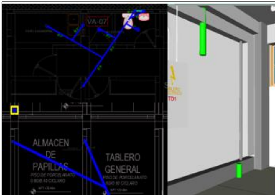
Figura 118. Incompatibilidad 10 de especialidad de instalaciones sanitarias.
