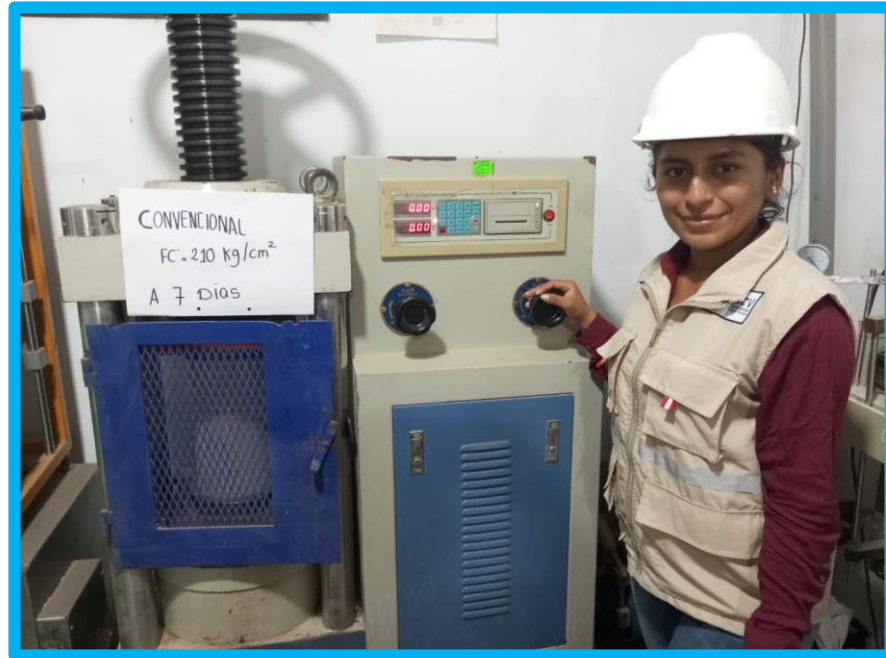
ROTURA DE PROBETA CONVENCIONAL A LOS 7 DIAS DE CURADO
