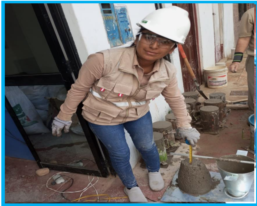
MIDIENDO LA ALTURA DE SLUMP
