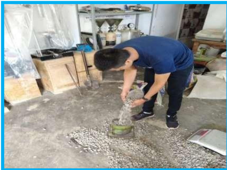
PESO UNITARIO SUELTO AGREGADO GRUESO
