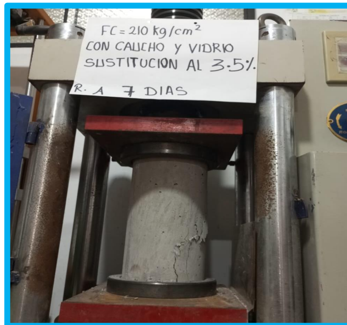
ROTURA DE PROBETA A LOS 7 DIAS CON INCORPORACION DE 3.5% DE CAUCHO + 3.5% DE VIDRIO
