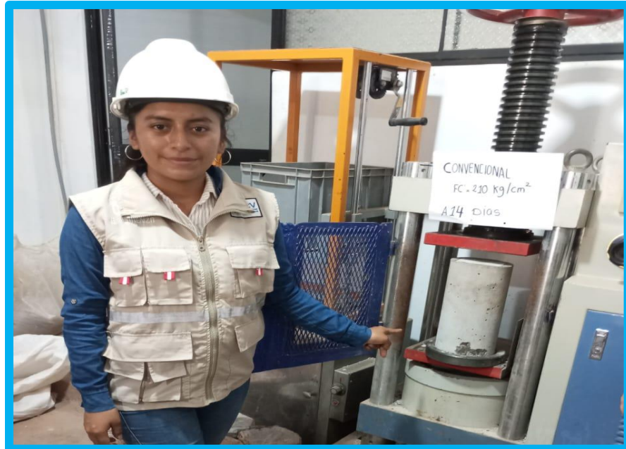
ROTURA DE PROBETA CONVENCIONAL A LOS 14 DIAS DE CURADO
