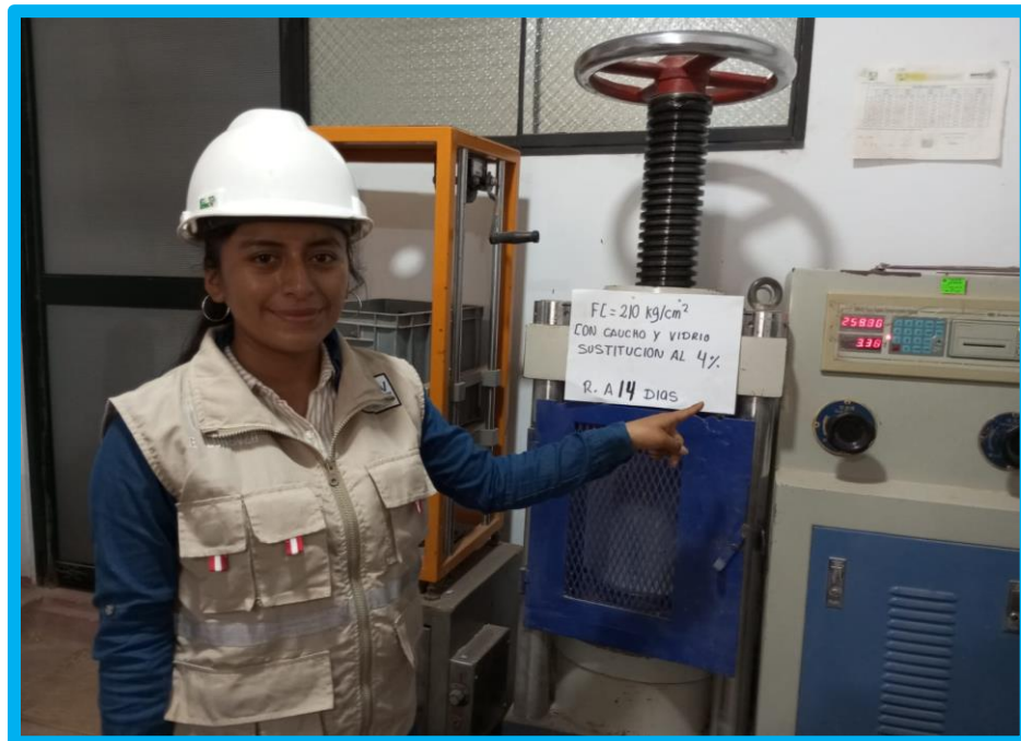
ROTURA DE PROBETA A LOS 14 DIAS CON INCORPORACION DE 4% DE CAUCHO + 4% DE VIDRIO
