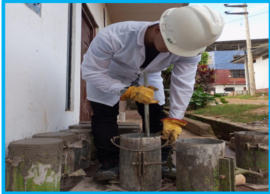
COMPACTADO CON 25 CHUCEADAS CON VARRILLA LISA
