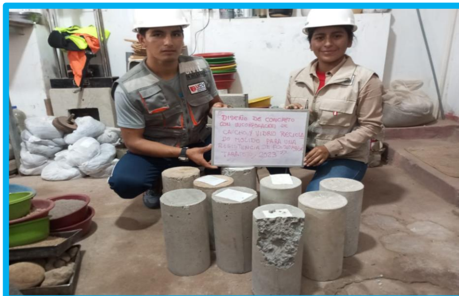
ROTURA DE PROBETA A LOS 28 DIAS (CONVENCIONAL, CON INCORPORACION DEL 6%, 7% Y 8% (CAUCHO + VIDRIO))
