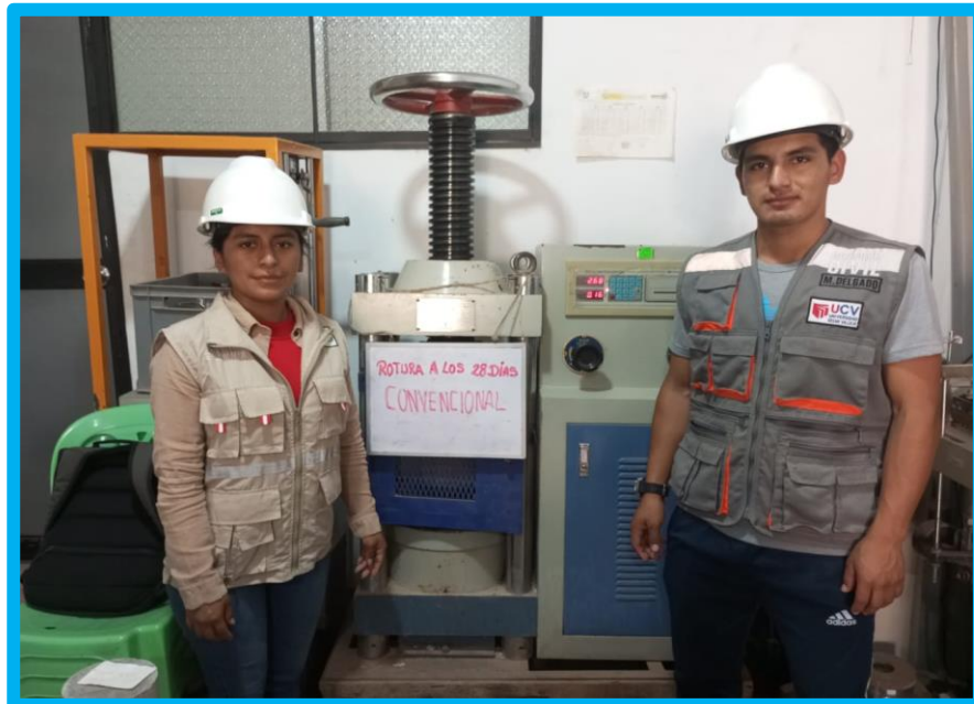
ROTURA DE PROBETA CONVENCIONAL A LOS 28 DIAS DE CURADO
