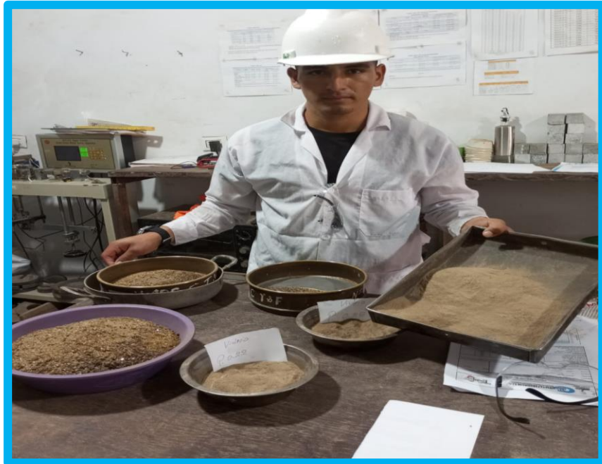
TAMIZADO DE VIDRIO RECICLADO MOLIDO
