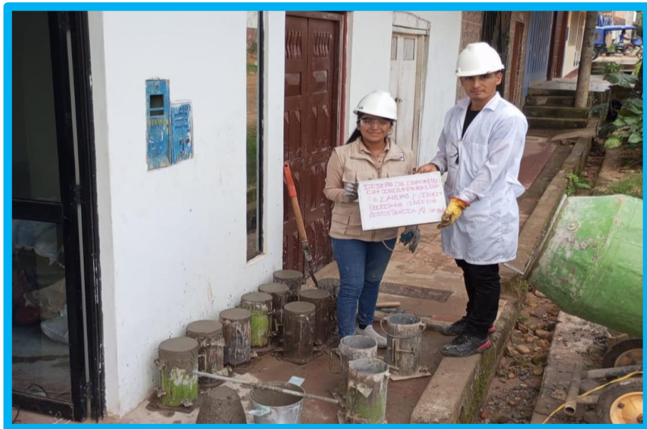
ELABORACION DE LAS 36 PROBETAS, SEGÚN DISEÑO
