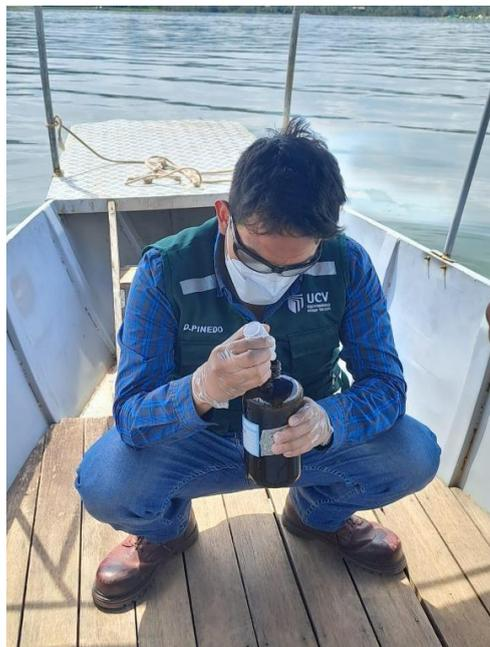
Para la preservación de muestras que serían enviadas al laboratorio se agregó  $H_2SO_4$  para el parámetro de aceites y grasas, además se rotuló las muestras y se colocó en la cadena de frío para su conservación.
