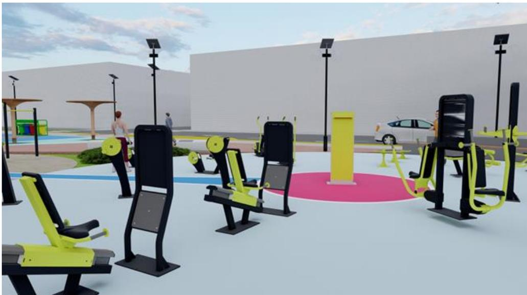
*Nota:* Imagen de estrategia propuesta dentro del vacío urbano, implementación de máquinas gimnasio al aire libre generadoras de energía, como sistema cada aparato contiene un indicador que brinda en el momento la cantidad de energía eléctrica generada con el ejercicio físico, con ello también se puede iluminar el equipamiento por las noches reutilizando la energía. Fuente elaboración propia.
