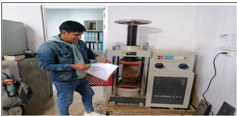
*Figura 40. Tomas de datos de los ensayos de muretes D1*
