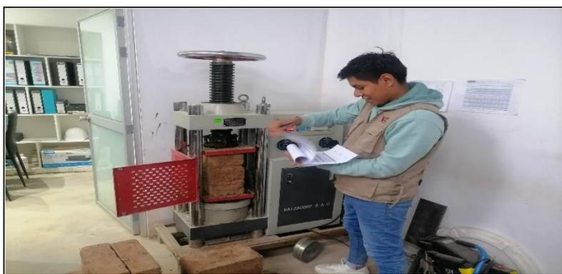
*Figura 37. Tomas de datos de los ensayos de pilas D2*
