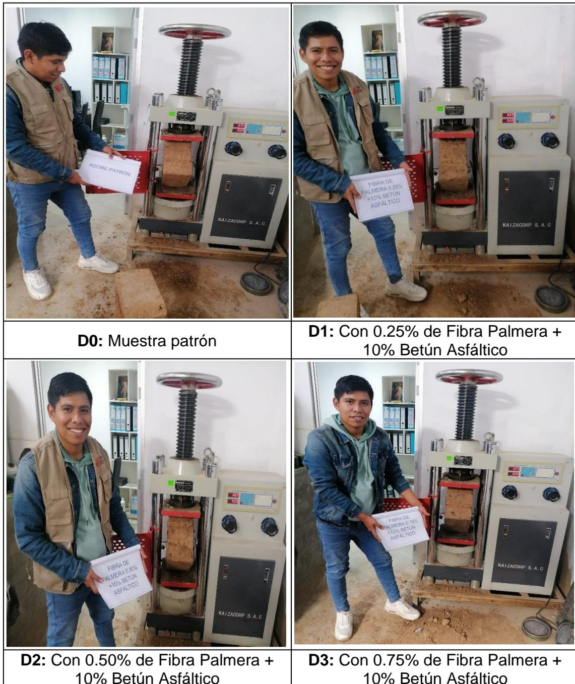
Figura 70. Ensayo en muretes de adobe
