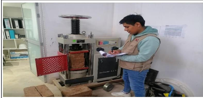
*Figura 35. Tomas de datos de los ensayos de pilas D0*
