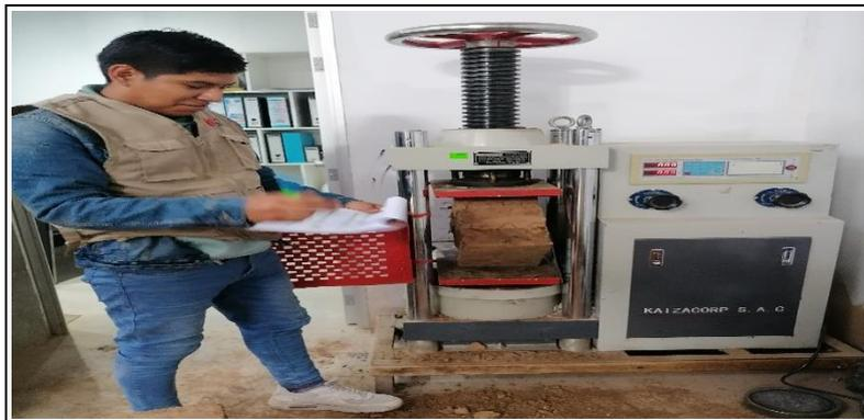
*Figura 39. Tomas de datos de los ensayos de muretes D0*
