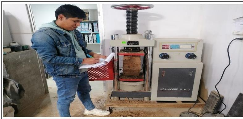
Figura 42 Tomas de datos de los ensayos de muretes D3
