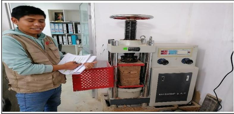
*Figura 38. Tomas de datos de los ensayos de pilas D3*
